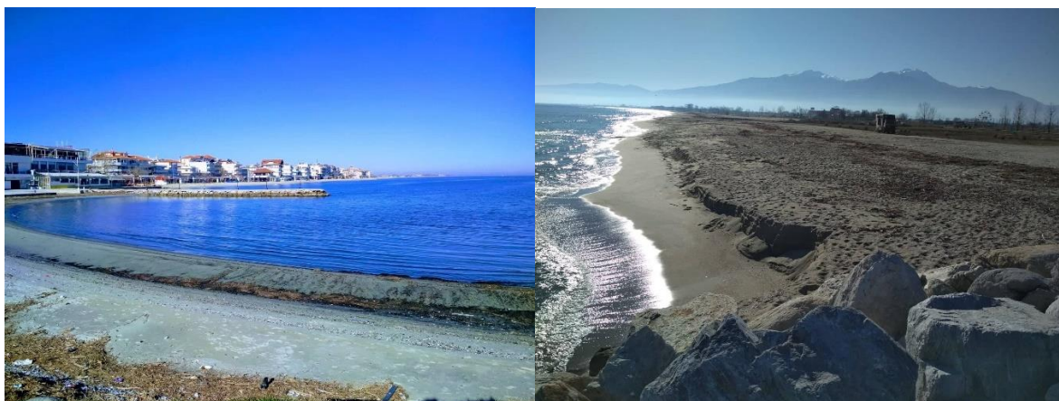
Εικόνα 4.1-4.2: Βόρεια πλευρά του λιμανιού της Παραλίας (Αριστερά) με ελάχιστη ιζηματογένεση και Νότια πλευρά του λιμανιού (Δεξιά) με εκτεταμένη ιζηματογένεση
