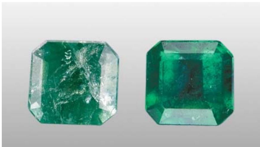
Εικόνα 3.1. Ρωγμές σε σμαράγδι που πληρώθηκαν με ξένο υλικό. ( https://www.gia.edu/gem-treatment ).
