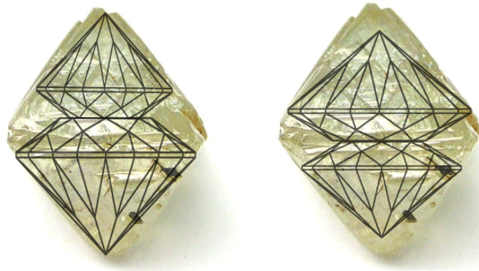
Σχήμα 6.11. Από ένα αρχικό-ακατέργαστο διαμάντι μπορούν να προκύψουν: α) δύο κυκλικής κοπής διαμάντια 3 καρατίων με χαμηλή ποιότητα κοπής ή β) δύο round cut διαμάντια 2,2 καρατίων με υψηλή ποιότητα κοπής. Συνήθως προτιμάται η πρώτη περίπτωση διότι τα κέρδη είναι πολύ μεγαλύτερα. ( https://ringspo.com/diamond-cut/ )
