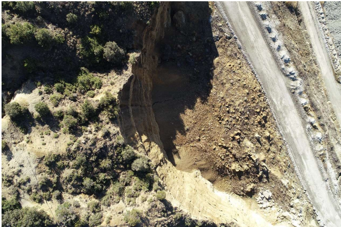
Φωτογραφία 6.13. Τυπική περίπτωση περιστροφικής ολίσθησης όπως αυτή συντελείται στα ανώτερα επίπεδα του ορυχείου.
