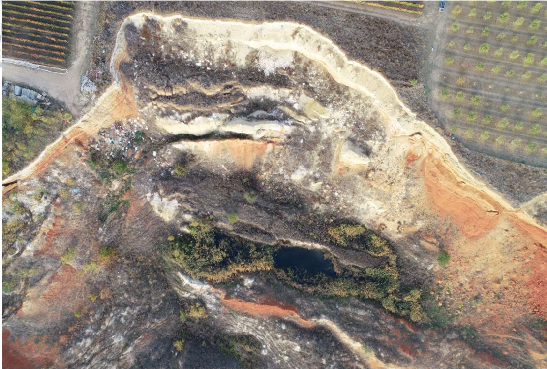
Φωτογραφία 6.4. Χαρακτηριστικό γνώρισμα (φρύδι) περιστροφικής ολίσθησης. Αναφέρεται στην αριστερή κατολίσθηση όπως κοιτάει κανείς από τα κατάντη.
