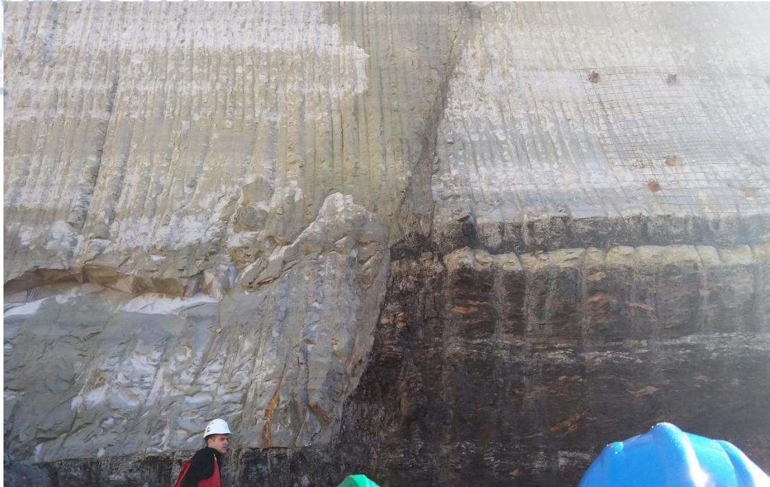
Φωτογραφία 6.12. Απεικονίζεται το κανονικό ρήγμα που διατρέχει με μεγάλη γωνία κλίσης τον υποκείμενο λιγνίτη και την υγιή μάργα. Τα στοιχεία του είναι: 047^{\circ}/60^{\circ} και εντοπίζεται στο πρανές 1.
