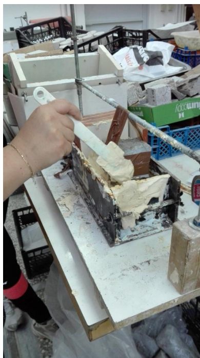
Εικόνα 2: Εγκιβωτισμός δοκιμίου (πλήρωση ασυνέχειας κατά 1 cm).
