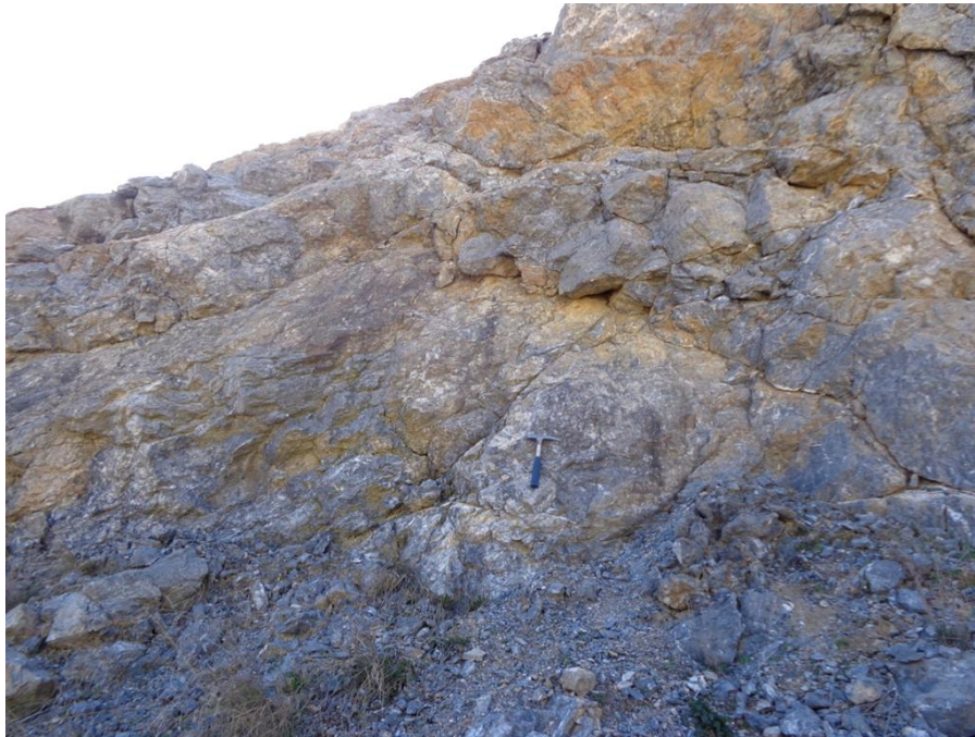
Εικόνα 3: Τεχνικογεωλογικός τύπος D ασβεστολιθικής βραχώμαζας στη θέση μελέτης.
