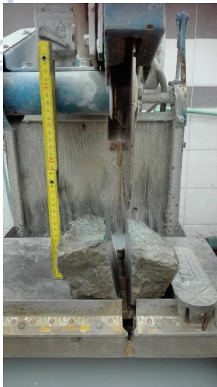
Εικόνα 1: Κοπή του ασβεστολιθικού δείγματος με ειδικό τροχό.
