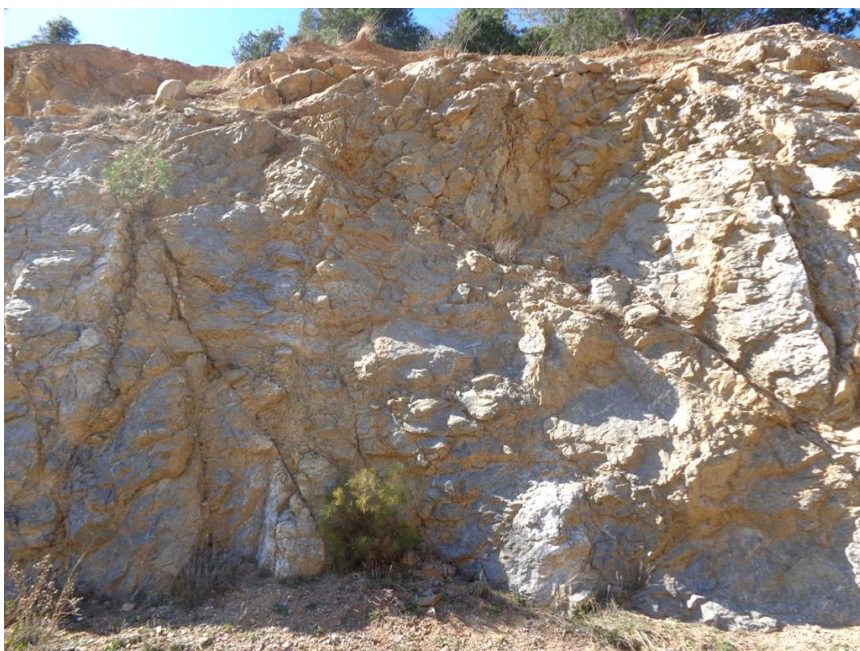
Εικόνα 2: Τεχνικογεωλογικός τύπος C ασβεστολιθικής βραχώμαζας στη θέση μελέτης.
