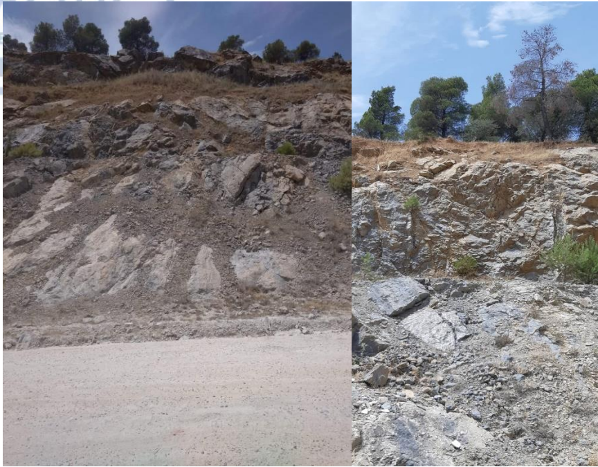
Εικόνα 21. Φωτογραφίες υπαίθρου. Αριστερά φαίνεται η στρώση του ασβεστόλιθου. Δεξιά φαίνονται κανονικά ρήγματα από τα οποία λήφθηκαν μετρήσεις.
