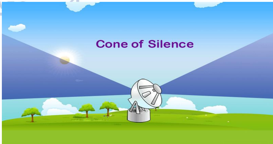
Σχήμα 3.1. Μετεωρολογικό ραντάρ και απεικόνιση της περιοχής του κώνου της σιωπής (Πηγή: Μπαμπζέλης, 2013).
