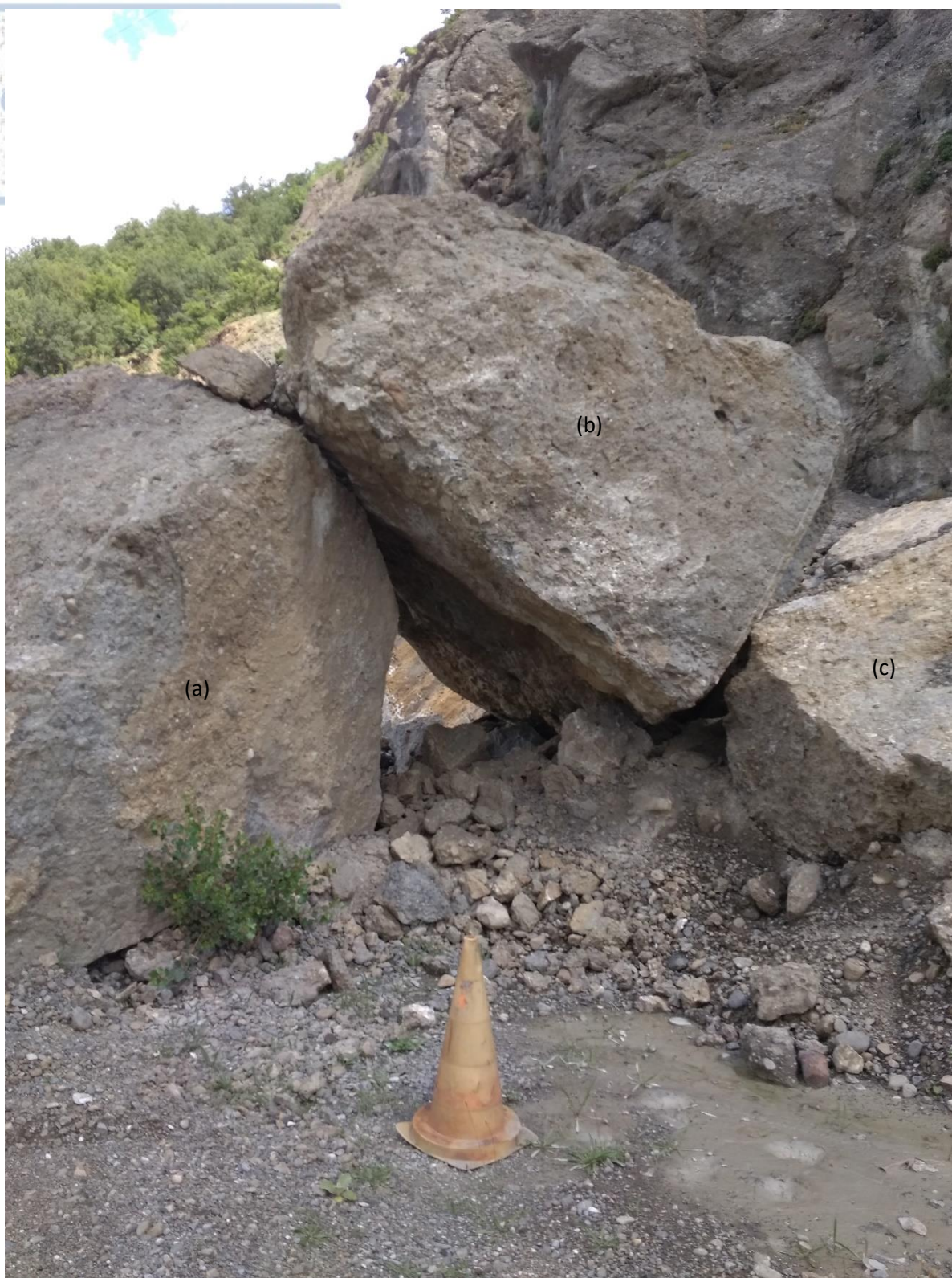
Εικόνα 20 Λήψη πεσμένων τεμαχίων παλαιάς κατολίσθησης στην περιοχή μελέτης μεγέθους (a) 14.1 \text{ m}^3 (b) 8.82 \text{ m}^3 (c) 2.15 \text{ m}^3
