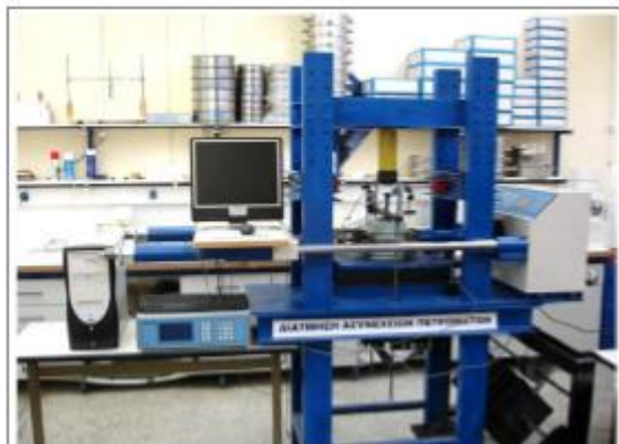
Εικόνα 46 Διάταξη συσκευής άμεσης διάτμησης ασυνεχών βράχου
