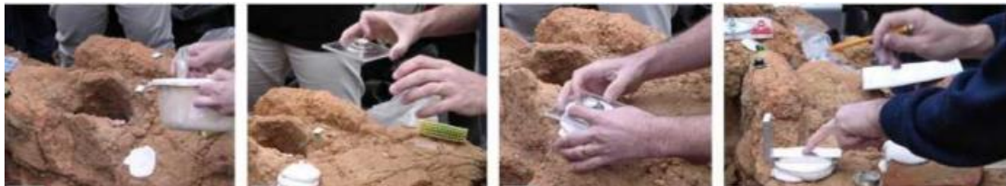
Σχήμα 24. Η διαδικασία γυψοποίησης και οριζοντίωσης των δειγμάτων (De Marco, 2007).
