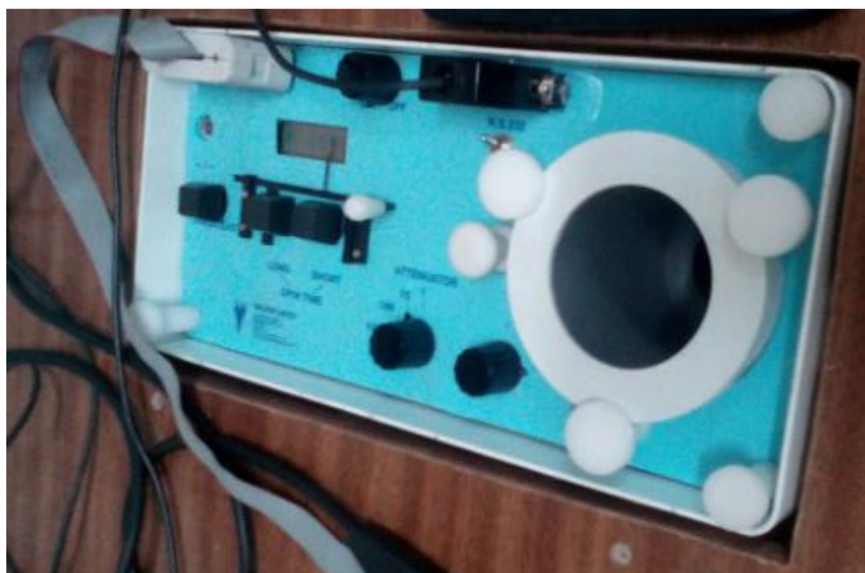
Σχήμα 27. Περιστροφικό μαγνητόμετρο Minispin, Εργαστήριο Γεωφυσικής ΑΠΘ
