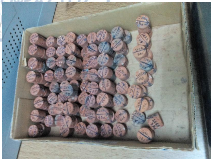
Σχήμα 26. Κυλινδρικοί πυρήνες- δείγματα από τον κλίβανο μελέτης της Ιερισσού
