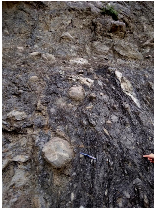
Εικόνα 3.2.2.14: Χαοτική μάζα ιλύολιθου (έντονη τεκτονική διαταραχή) με ψαμμιτικά εγκλείσματα- Τύπος X (περιοχή Μετσόβου,2019).
