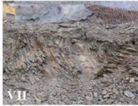
Τύπος VII. Έντονα διαταραγμένη – πτυχωμένη βραχώμαζα η οποία διατηρεί τη δομή της και αποτελείται από εναλλαγές ψαμίτη – ιλυολίθου σε ίσες αναλογίες
