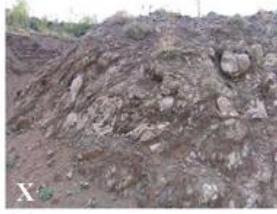
Τύπος X. Τεκτονικά παραμορφωμένος, έντονα πτυχωμένος, ρηγματωμένος ιλυόλιθος ή αργιλικός σχιστόλιθος με κερματισμένα και παραμορφωμένα ψαμμικά τεμάχια τα οποία διαμορφώνουν σχεδόν χαστική δομή
