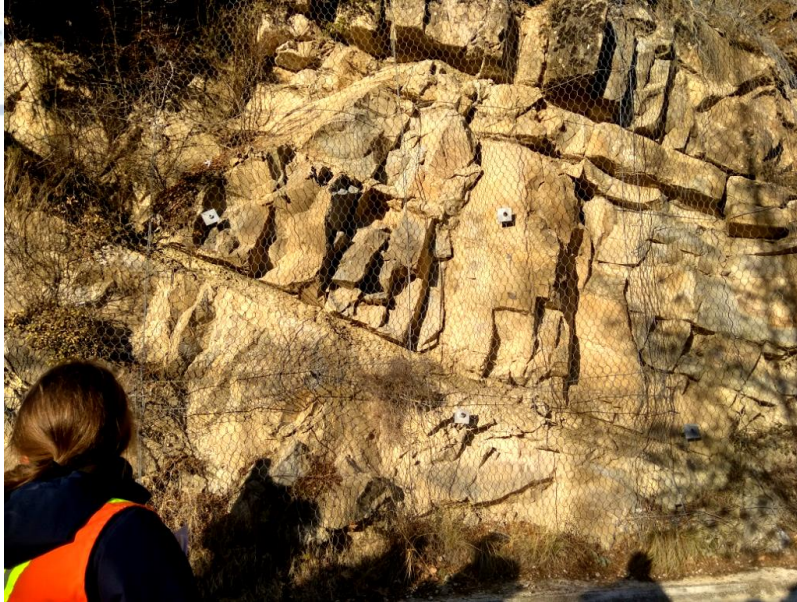
Εικόνα 3.2.2.19: Ψαμμίτης του φλύσχη με σαφή διάκριση της στρώσης και των διακλάσεων- Τύπος I. (περιοχή Μετσόβου, 2018)
