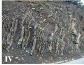
Τύπος IV. Μέτρια διαταραγμένη βραχώμαζα αποτελούμενη από εναλλαγές ψαμίτη-ιλυολίθου σε ίσες αναλογίες
