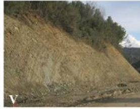
Τύπος V. Μέτρια διαταραγμένη βραχώμαζα αποτελούμενη από ιλυόλιθο με ενστρώσεις ψαμίτη
