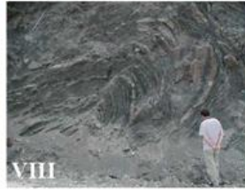
Τύπος VIII. Έντονα διαταραγμένη – πτυχωμένη βραχώμαζα η οποία διατηρεί τη δομή της και δεν έχει παραμορφωθεί – διατηρεί σε μεγάλο βαθμό και αποτελείται κυρίως από ιλυόλιθο με ενστρώσεις ψαμίτη
