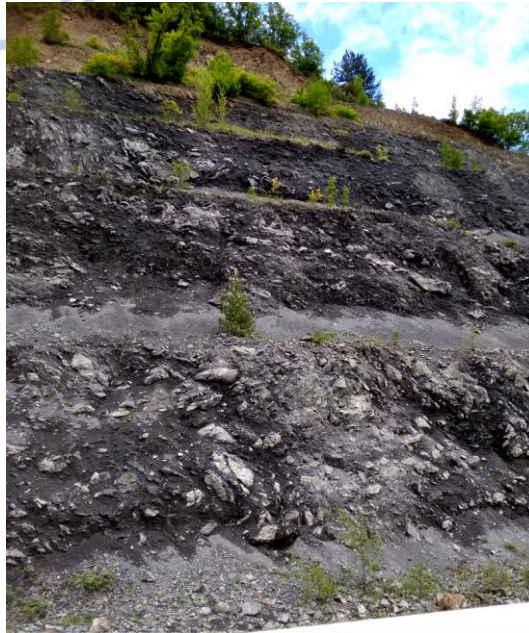
Εικόνα 3.2.2.15: Αναβαθμίδες από εναλλαγές ψαμμίτη και ιλυόλιθου σε ίσες περίπου αναλογίες, με έντονη πτύχωση, αποσάθρωση και σχάση του ιλυόλιθου επιφανειακά, δίνοντας την εντύπωση χαοτικής μάζας- Τύπος VII(εικόνα από την περιοχή της Πίνδου,2019)
