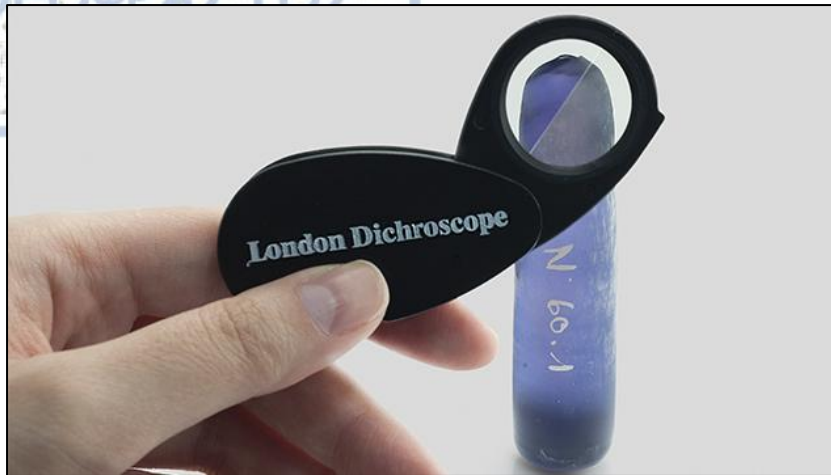
Εικόνα 34: Διακρίνεται πλεοχροϊσμός σε συνθετικό κρύσταλλο ζαφειριού.
