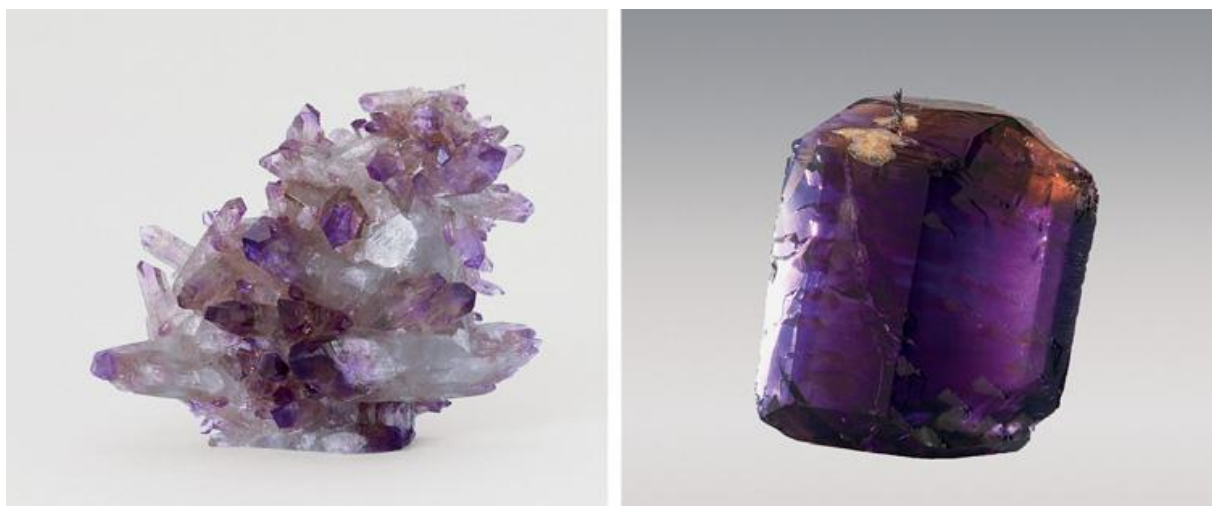
Εικόνα 40: Συνθετικοί κρύσταλλοι αμέθυστου που αναπτύχθηκαν σε διάλυμα \text{K}_2\text{CO}_3 . Αριστερά: σύμπλεγμα από πρισματικούς κρυστάλλους (δείγμα από Ρωσία). Δεξιά: ο κρύσταλλος ύψους 15\text{ cm} ζυγίζει πάνω από 1\text{ kg} (Photos by Franck Notari).
