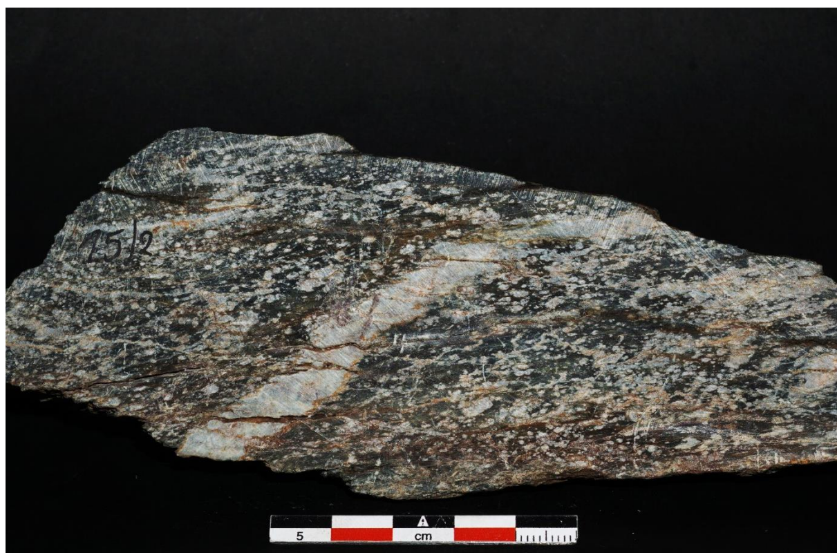
Σχήμα 5.2 Δείγμα NP 15/2. Μεταφαιστειακό πέτρωμα που υπέρκειται της συμπαγούς μεταλλοφορίας χαλκοπυρίτη – σιδηροπυρίτη, παρατηρούνται ίχνη διάσπαρτης μεταλλοφορίας σιδηροπυρίτη.
