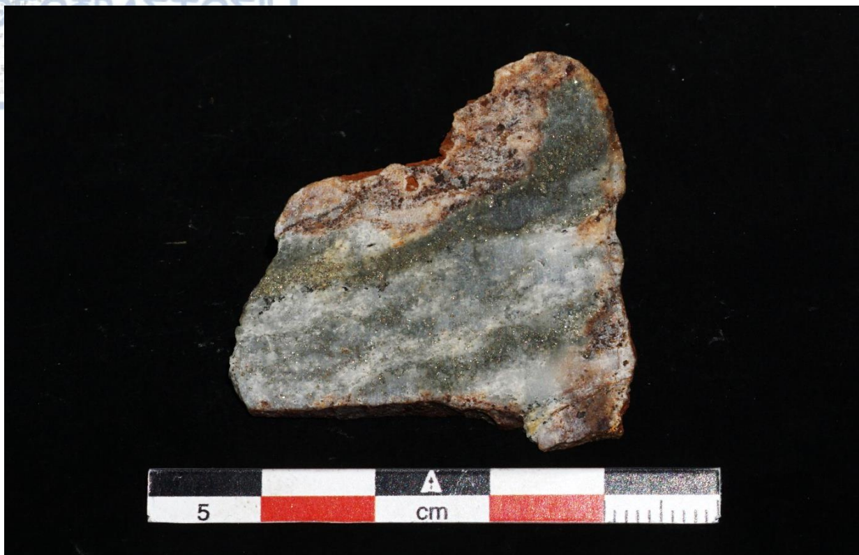
Σχήμα 5.5 Δείγμα NP 42. Διάσπαρτη μεταλλοφορία σιδηροπυρίτη μέσα σε πυριτικό υλικό.
