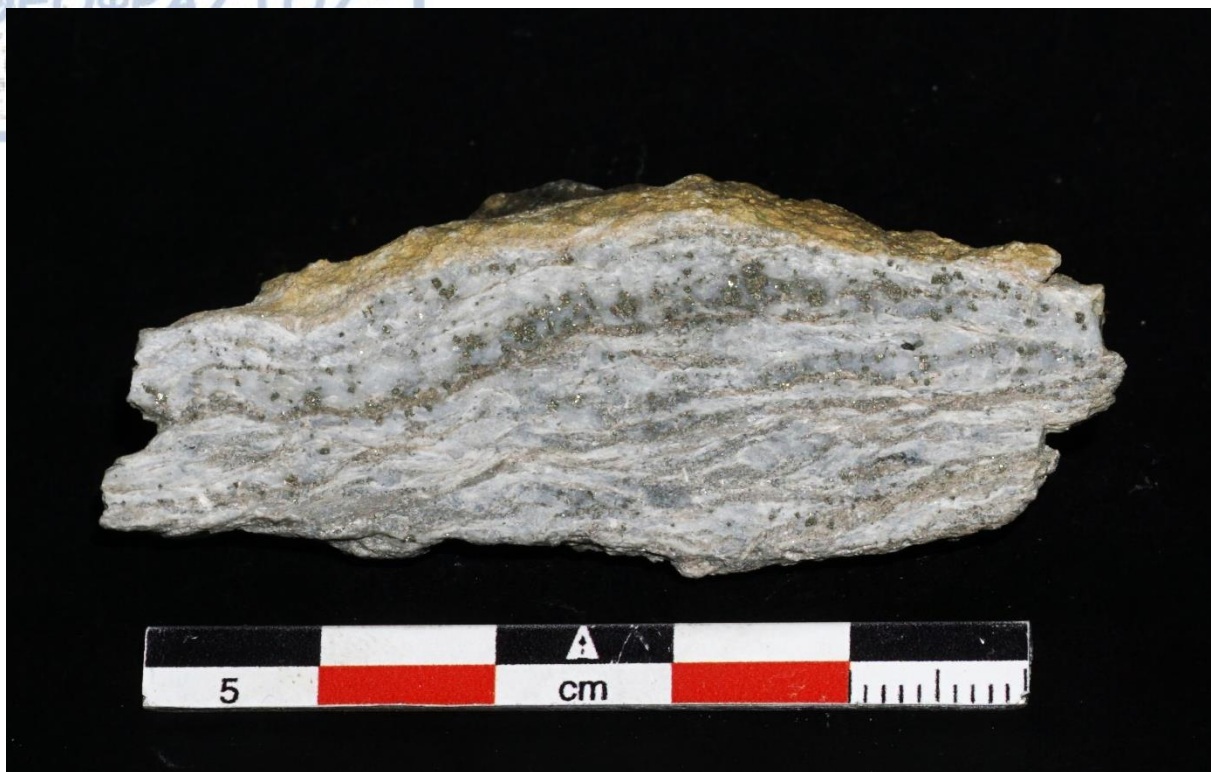
Σχήμα 5.1 Δείγμα NP 10/2. Λεπτά στρώματα μεταλλοφορίας σιδηροπυρίτη εντός πυριτικού υλικού. Παρατηρείται μία στρωμάτωση των σουλφιδίων.
