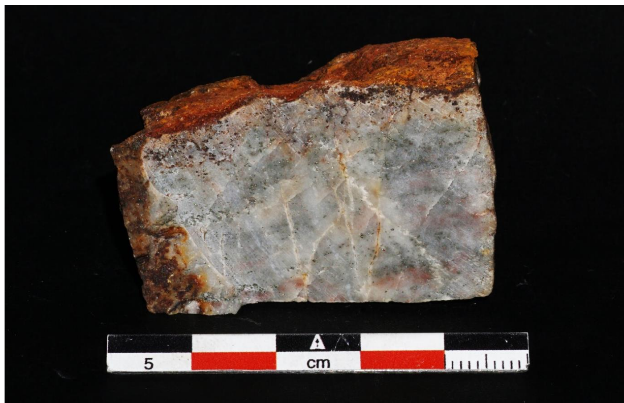
Σχήμα 5.6 Δείγμα NP 45. Διάσπαρτη μεταλλοφορία σιδηροπυρίτη μέσα σε πυριτικό υλικό.
