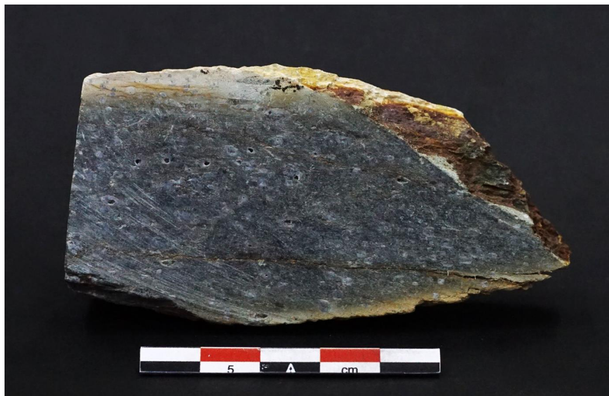
Σχήμα 5.4 Δείγμα NP 24. Μεταφαιστειακό πέτρωμα με διάσπαρτη μεταλλοφορία σιδηροπυρίτη.
