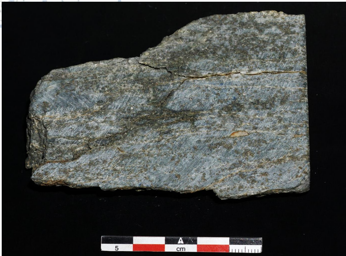
Σχήμα 5.7 Δείγμα NP 27/2 Διάσπαρτη μεταλλοφορία σιδηροπυρίτη μέσα σε μεταμφιστειακό πέτρωμα. Παρατηρείται μία στρωμάτωση κατά την απόθεση της μεταλλοφορίας.
