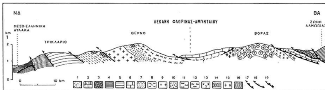
Εικόνα 2.5: Απλοποιημένη – σχηματική γεωλογική τομή της Βόρειας Πελαγονικής ζώνης στην οποία φαίνονται οι ενότητες Βόρα (με αντικλινική δομή) και Βέρνου (με ανεστραμμένη λεπιοειδή διάταξη). 1: μολάσσα της Μεσοελληνικής αύλακας, 2: Άνω Κρητιδικά επικλυσιογενή ιζήματα, 3: οφιόλιθοι και συνοδά ιζήματα, 4: ιζήματα Υποπελαγονικής ζώνης, 5: ανθρακικό κάλυμμα Δυτικού Πελαγονικού περιθωρίου, 6: ανθρακικό κάλυμμα Ανατολικού Πελαγονικού περιθωρίου, 7 και 8: μετακλαστικά ιζήματα Περμοτριάδικού, 9: γνευσιωμένος γρανίτης Άνω Λιθανθρακοφόρου, 10 και 11: κρυσταλλοσχιστώδες υπόβαθρο Βέρνου, 12 – 15: κρυσταλλοσχιστώδες υπόβαθρο Βόρα (σχιστόλιθοι, γνεύσιοι, οφθαλμογενεύσιοι), 16: λέπια Αλμωπίας, 17: επωθήσεις Ανωτέρου Ιουρασικού – Κάτω Κρητιδικού, 18: επωθήσεις - επιππεύσεις Τριτογενούς, 19: επώθηση ζώνης Αλμωπίας (Mountrakis, 1983).
