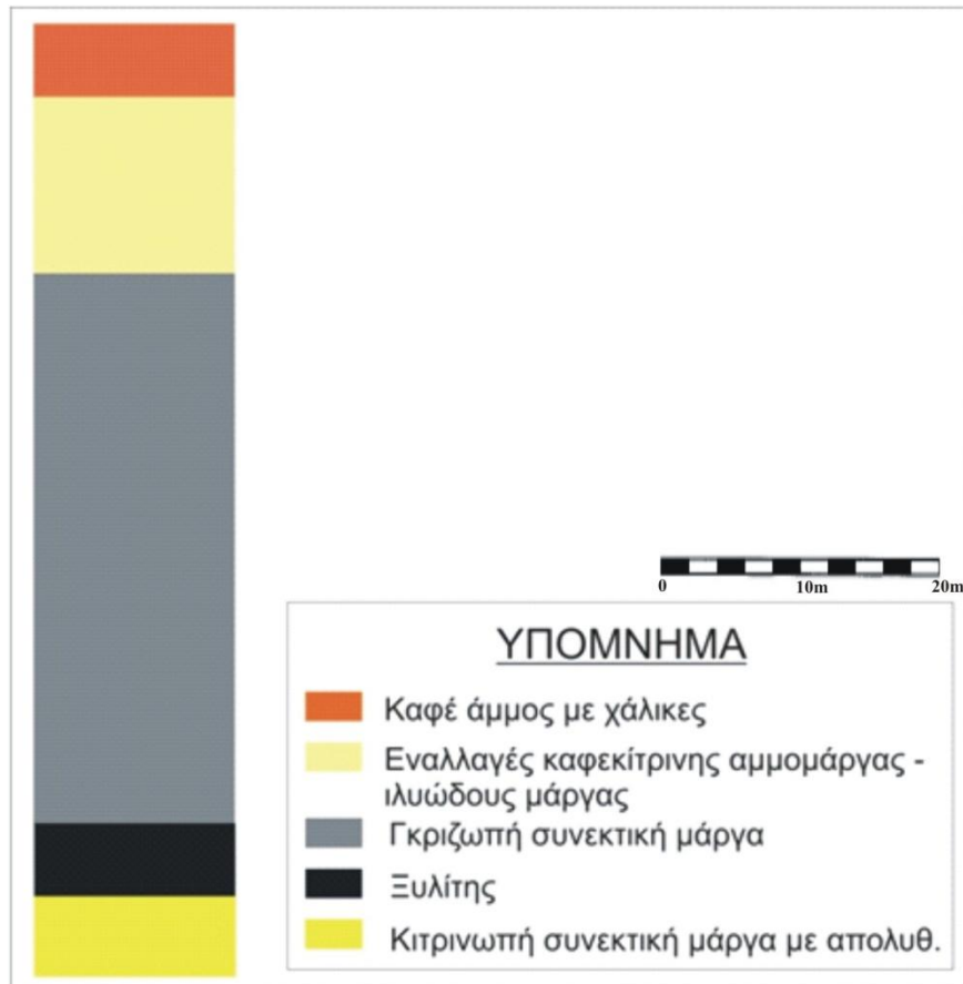
Εικόνα 3.2: Προφίλ γεωλογικών στοιχείων της εκτελεσθείσας γεώτρησης Γ19/11.
