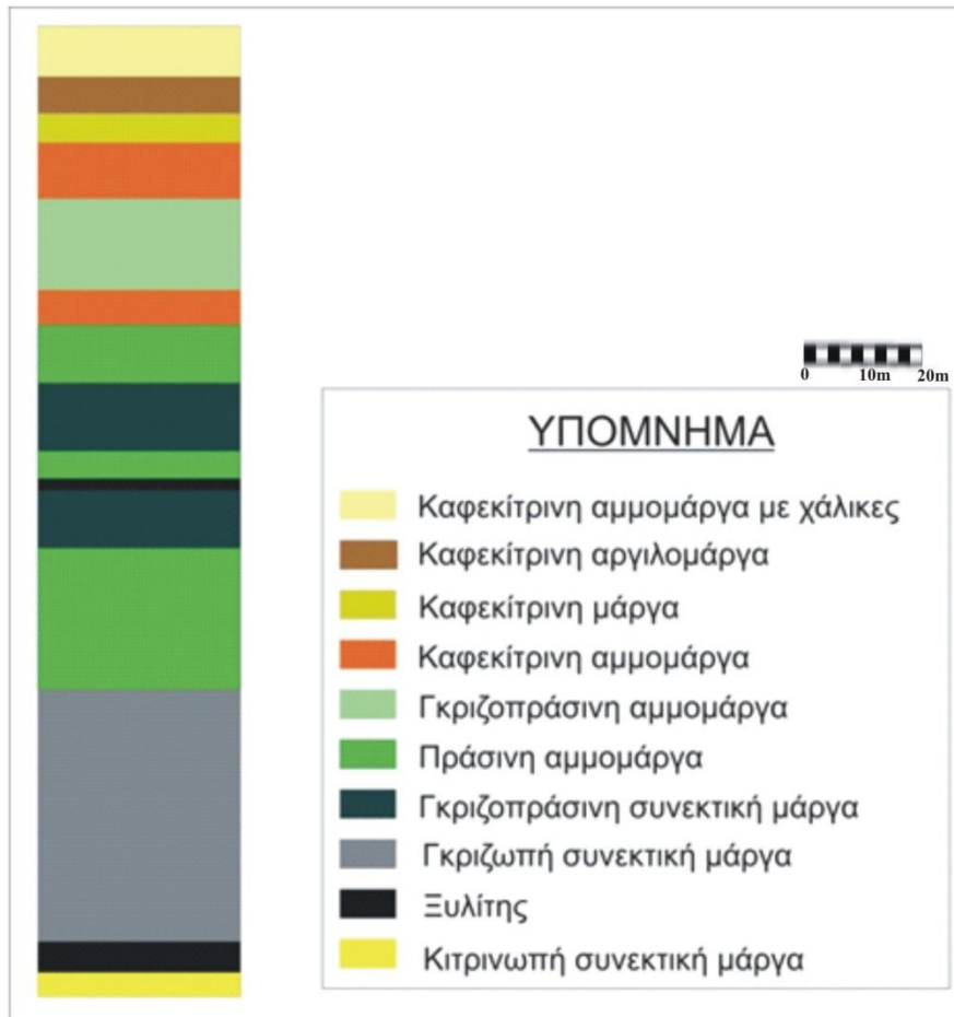
Εικόνα 3.7: Προφίλ γεωλογικών στοιχείων της εκτελεσθείσας γεώτρησης Γ2/15.
