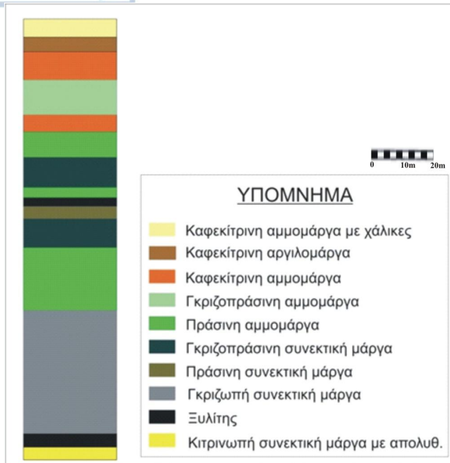
Εικόνα 3.6: Προφίλ γεωλογικών στοιχείων της εκτελεσθείσας γεώτρησης Γ1/15.
