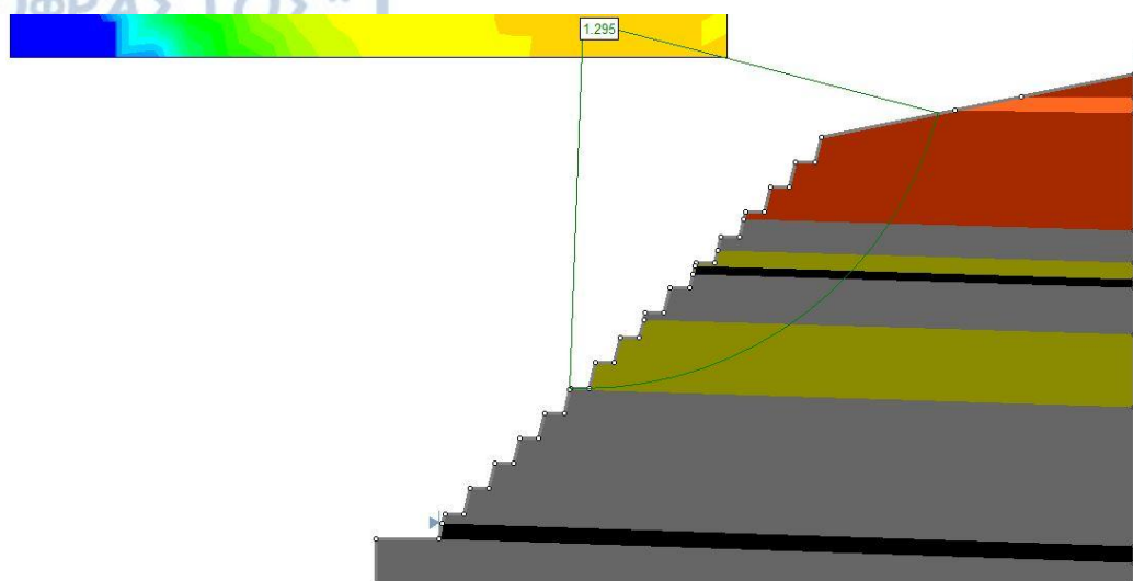
Εικόνα 9.7: Ανάλυση ευστάθειας υπό εξέταση πρανούς σε στατικές συνθήκες φόρτισης ( R_u = 0,15 ).
