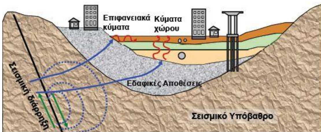
Σχήμα 1-3. Τελική εδαφική κίνηση στην επιφάνεια εξαρτώμενη από την πηγή, την διαδρομή των σεισμικών κυμάτων και τις τοπικές εδαφικές συνθήκες.
