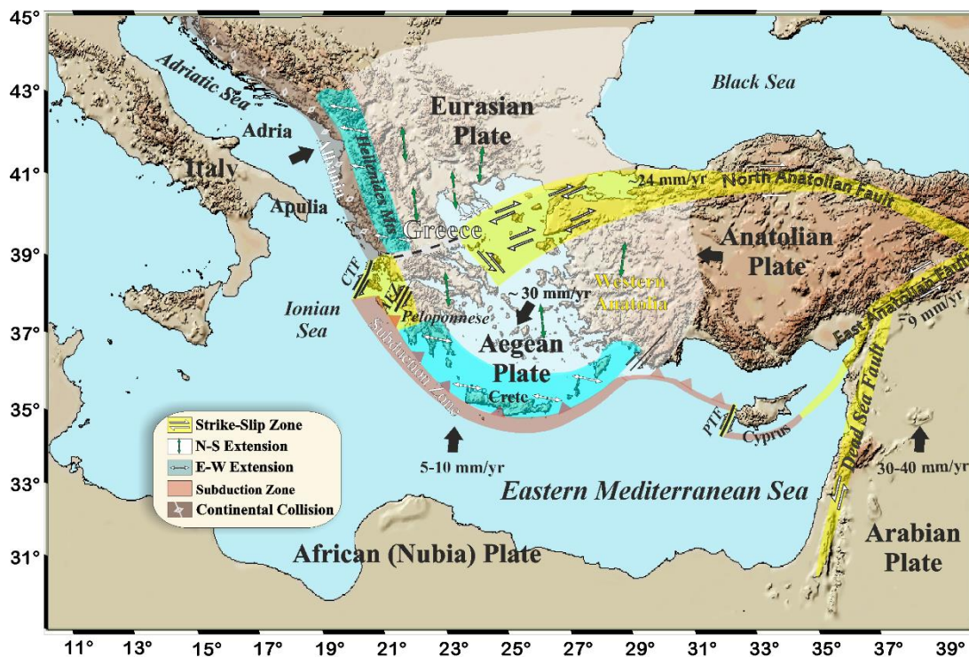
Σχήμα 1-1. Κινήσεις των λιθοσφαιρικών πλακών που καθορίζουν την ενεργό τεκτονική στο Αιγαίο και στις γύρω περιοχές (τροποποιημένο από Papazachos et al. 1998).
