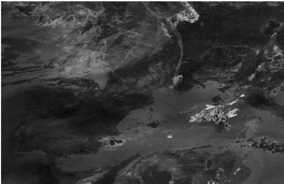
Εικόνα 8: Διαφορά θερμοκρασίας λαμπρότητας των καναλιών Ch09 στα 10,8 \mu\text{m} και Ch10 στα 12,0 \mu\text{m} TD = 10,8 \mu\text{m} -12 \mu\text{m} . 11/08/2016, 03:30 UTC.
