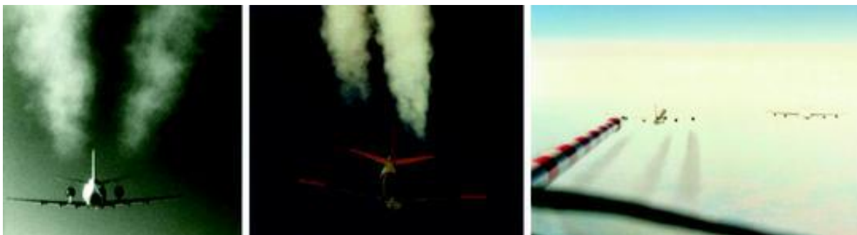
Εικόνα 1: Σχηματισμός contrails πίσω από αεροσκάφη. Αριστερά και Μέση: Σχηματισμός contrails με καύσιμο διαφορετικής περιεκτικότητας σε θειούχες ενώσεις. Δεξιά: Δύο αεροσκάφη με διαφορετική αποδοτικότητα κινητήρων. (Φωτογραφίες: R. Busen, P. Thomas, U. Schumann, DLR)
