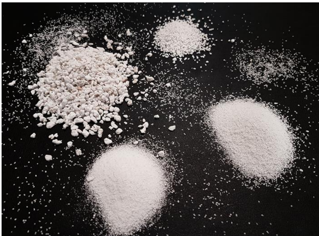
Εικόνα 4: Περλίτης μετά τη διαδικασία διόγκωσης σε διαφορετικά μεγέθη κόκκων ( www.aegean-perlites.com )
