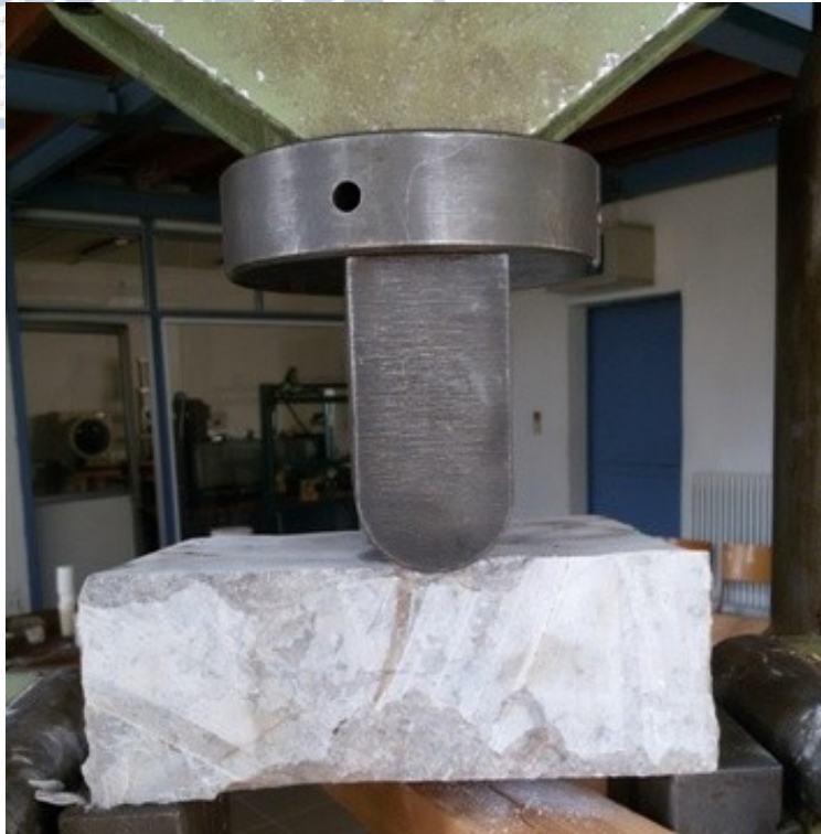
Εικόνα 3.3. Εφελκυστική αστοχία λόγω κάμψης.
