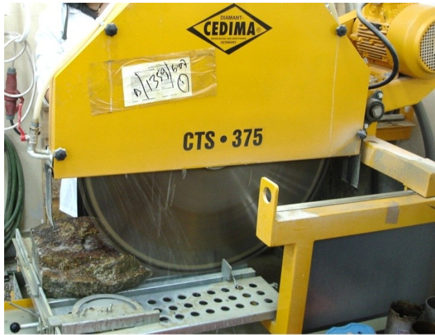
Εικόνα 3.5. Κοπή και διαμόρφωση δειγμάτων με την χρήση αδαμαντοτροχού (αριστερά) και πυρηνοληψία πετρωμάτων (δεξιά).
