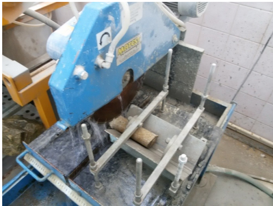
Εικόνα 3.6. Κοπή των δυο άκρων του πυρήνα με τη χρήση αδαμαντοτροχού για τη διαμόρφωση κυλινδρικού σχήματος.
