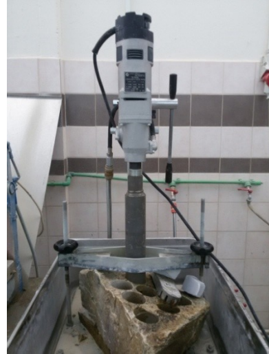
Εικόνα 3.5. Κοπή και διαμόρφωση δειγμάτων με την χρήση αδαμαντοτροχού (αριστερά) και πυρηνοληψία πετρωμάτων (δεξιά).
