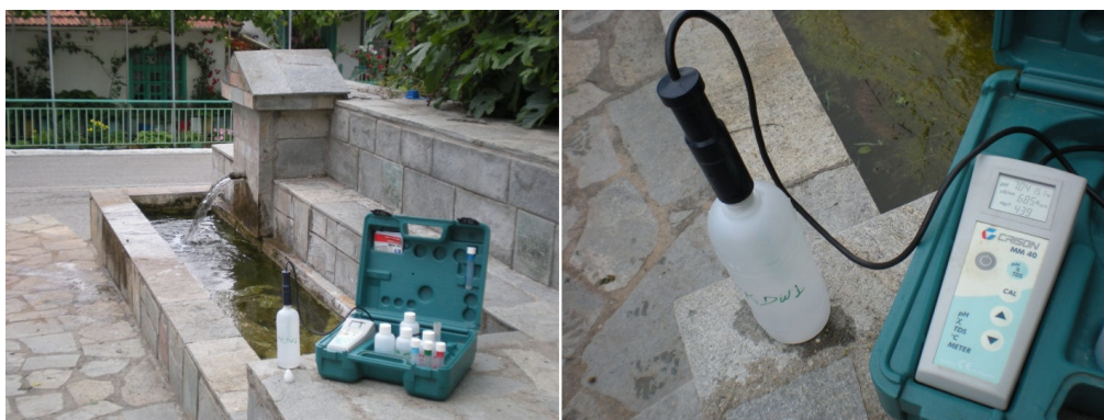
Σχήμα 4.12. Προσδιορισμός φυσικοχημικών παραμέτρων υδατικού δείγματος στην ύπαιθρο.
