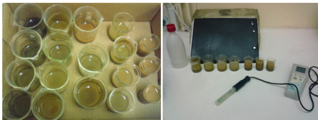
Σχήμα 4.11. Προσδιορισμός pH δειγμάτων ιζήματος στο εργαστήριο.
