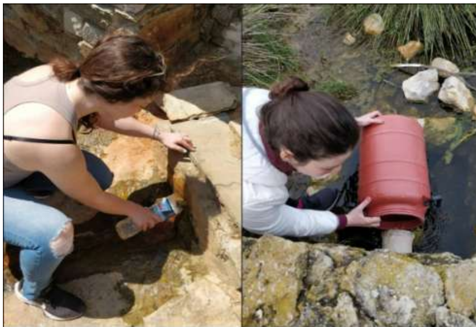
Σχίμα 1.2 Αριστερά , όργανο μέτρησης παροχής πηγής «Αγίασμα», μπουκάλι χωρητικότητας 1,5 Lt. Δεξιά , όργανο μέτρησης παροχής πηγής «Βοσκίνα», ογκομετρικό βαρέλι χωρητικότητας 35 Lt.
