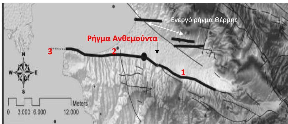
Σχήμα 3.4 Ενεργά ρήγματα στη Λεκάνη Ανθεμούντα. Με κύκλο το επίκεντρο σεισμού τον 20ο αιώνα, σύμφωνα με κατάλογο του εργαστηρίου Γεωφυσικής ΑΠΘ
