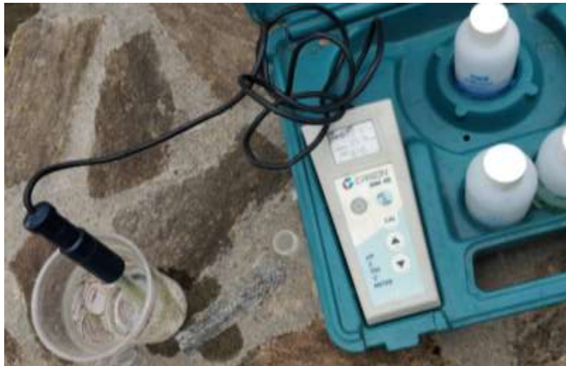
Σχήμα 1.1 Αγωγιμόμετρο για τη μέτρηση pH, θερμοκρασίας νερού και ηλεκτρικής αγωγιμότητας.
