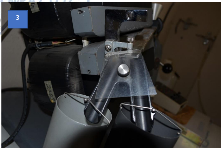
Εικόνα 3.15. Ανοιχτόχρωμο δοχείο (αριστερά) μη μαγνητικών ορυκτών. Σκουρόχρωμο δοχείο (δεξιά) μαγνητικών ορυκτών. Φωτογραφία από προσωπικό αρχείο.
