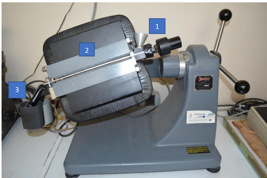
Εικόνα 3.10. Μαγνητικός διαχωριστής εργαστηρίου ΑΠΘ. Φωτογραφία από προσωπικό αρχείο.
