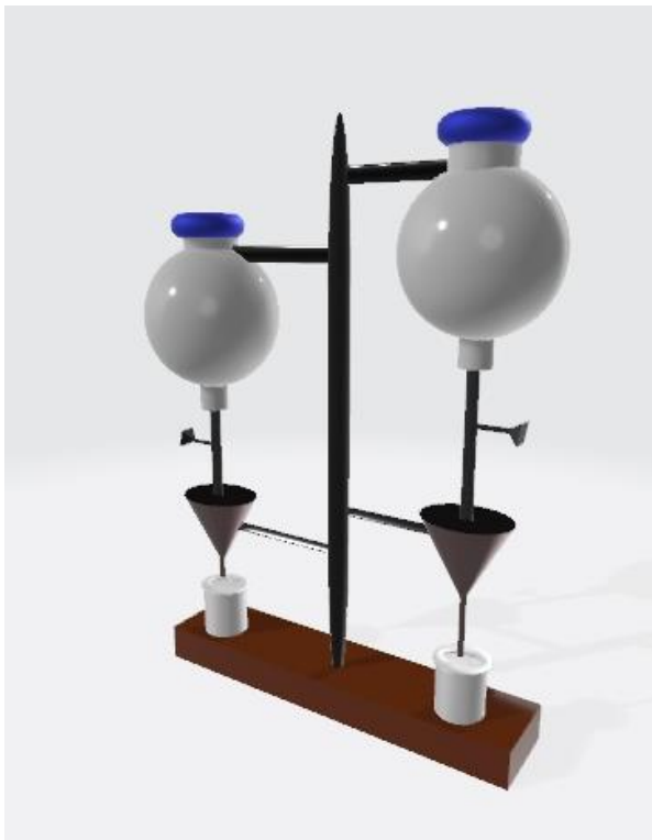
Εικόνα 3.16. 3D προσομοίωμα διάταξης μεθόδου βαρέων διαλυμάτων υπό γωνία. Δημιουργία σε λογισμικό Paint 3D Microsoft.
