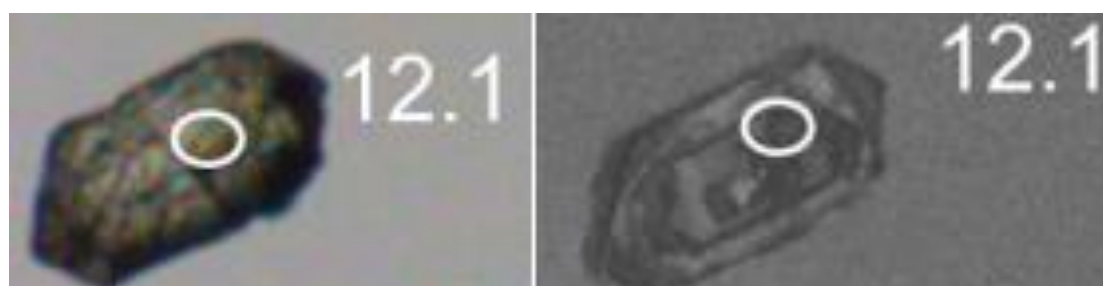
Εικόνα 7.15. Κρύσταλλος 12 με αναγραφή του σημείου ανάλυσης 12.1. Αριστερά εικόνα στερεοσκόπιου, δεξιά καθοδοφωταύγειας.
