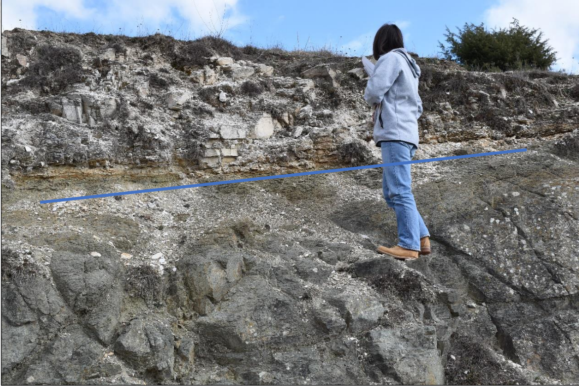
Εικόνα 29: Επαφή αμφιβολιτικού σχιστόλιθου με γνευσιογρανίτη υψηλά αποσαθρωμένο (IV) σε ζώνη διάρρηξης, GSI 15-25.
