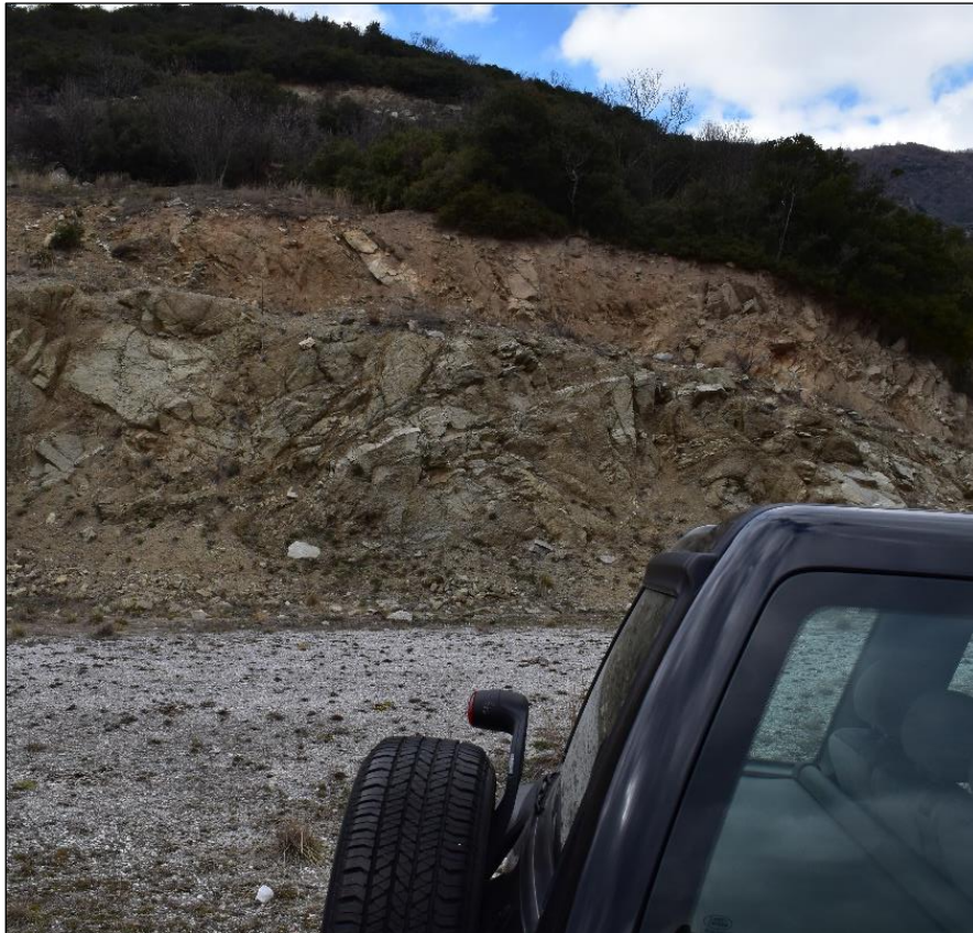
Εικόνα 22: Μετρίως αποσαθρωμένος (III) γνεύσιος, GSI 35-45.
