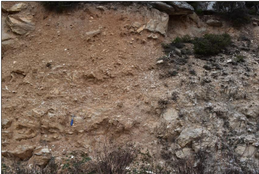
Εικόνα 19: Πολύ αποσαθρωμένος (VI) γνεύσιος, GSI 15-25.
