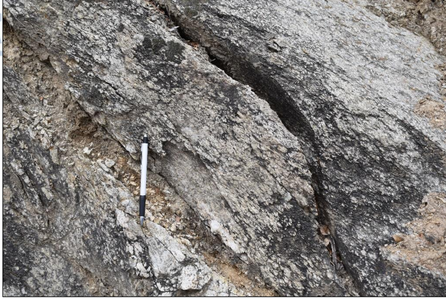
Εικόνα 23: Ασυνέχειες με αργιλικό υλικό.
