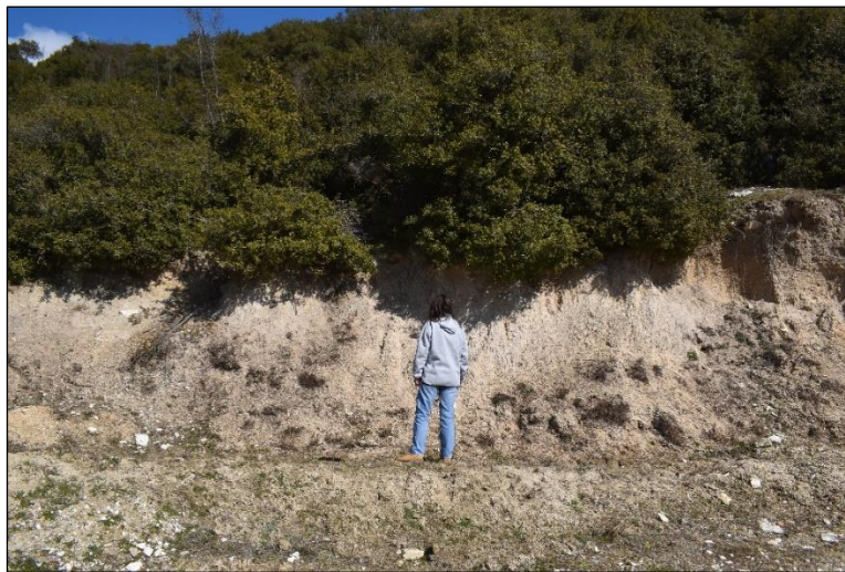
Εικόνα 30: Πλήρως αποσαθρωμένος (V) γνεύσιος με κατά τόπους γνευσιακά τεμάχη, GSI 5-15.
