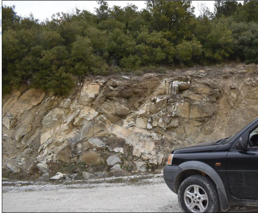
Εικόνα 20: Ελαφρά έως μέτρια (II-III) αποσαθρωμένος γνεύσιος, GSI 45-55.
