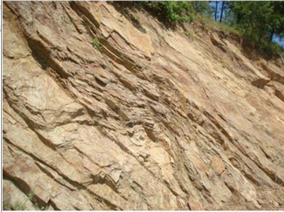
Εικόνα 4: Αποσαθρωμένη σχιστώδης γνευσιακή βραχομάζα.
