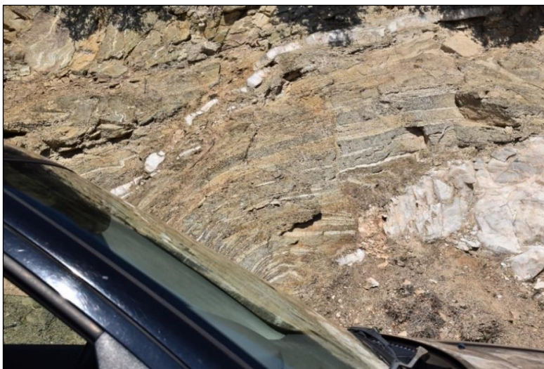
Εικόνα 32: Ελαφρά (II) αποσαθρωμένος γενεύσιος, GSI 45-55.
