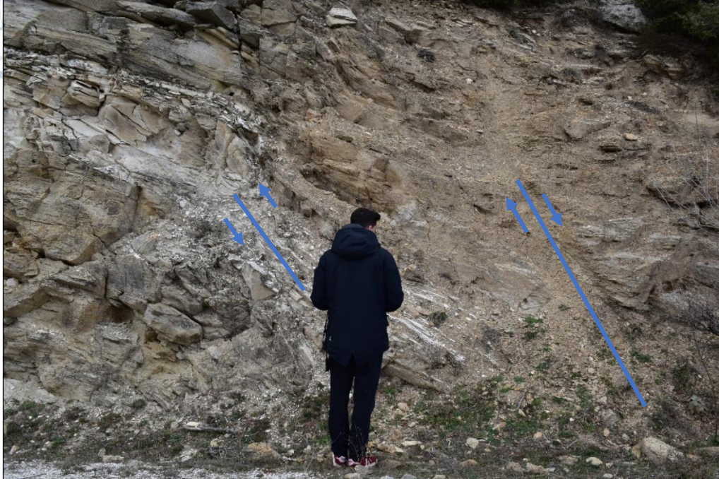
Εικόνα 13: Μετρίως αποσαθρωμένους (III) γρανιτογενέσιους, χαρακτηρίζεται από GSI 35-45(αριστερά), υψηλά αποσαθρωμένους (IV) γρανιτογενέσιους, GSI 15-25 (δεξιά)με παρουσία σχιστότητας υπό την επίδραση τεκτονικής.
