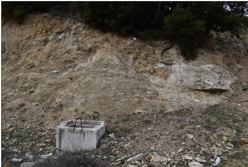
Εικόνα 21: Πολύ αποσαθρωμένος (IV) γνεύσιος κοντά στο στόμιο εξόδου, GSI 30-40.
