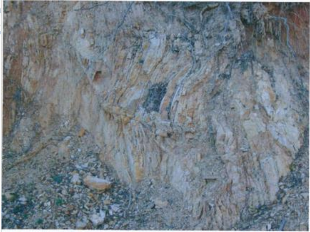
Εικόνα 7: Διατμημένη σχιστώδης – γνευσιακή βραχομάζα (Δημαράς, 2006).
