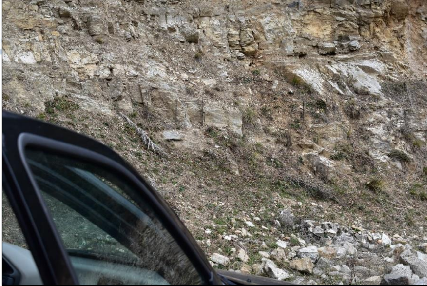
Εικόνα 26: Μετρίως αποσαθρωμένος (III) γνεύσιος, GSI 35-45.
