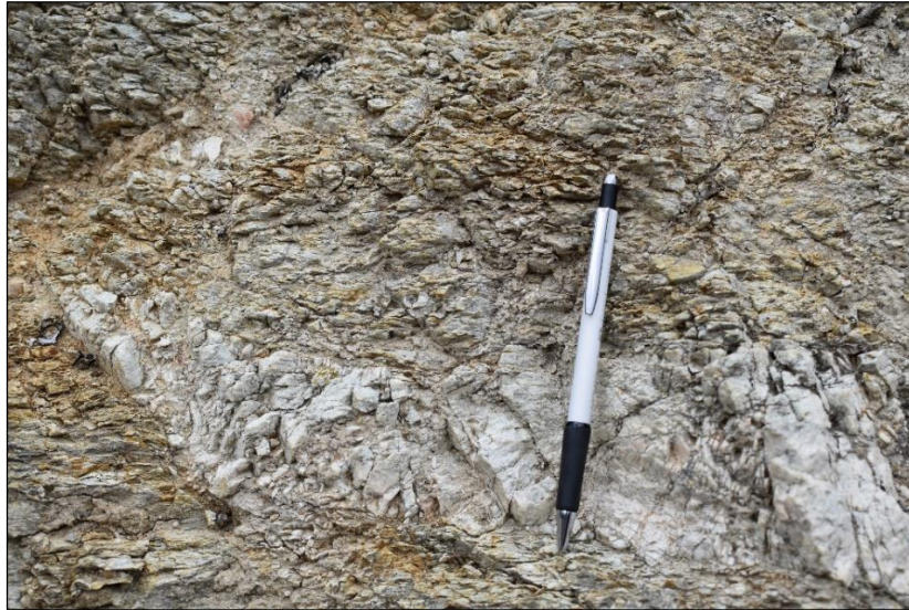
Εικόνα 27: Διατμημένος, σχιστώδης γνεύσιος με γρανιτική διείσδυση, GSI 15-25.
