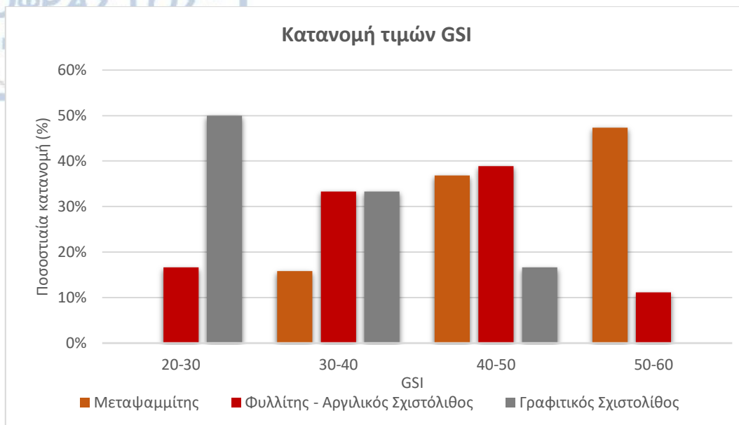
Εικόνα 66. Διάγραμμα ποσοστιαίας κατανομής τιμών GSI.
