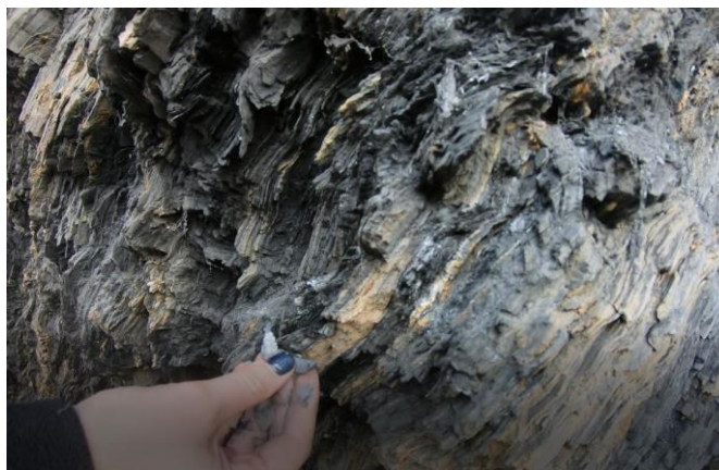
Εικόνα 76. Τεχνογεωλογική ενότητα 3: έντονα κερματισμένος γραφιτικός σχιστόλιθος - εναλλαγές φυλλοποιημένου γραφιτικού σχιστόλιθου με χαλαζιακές φλέβες και μεταψαμμίτες.
