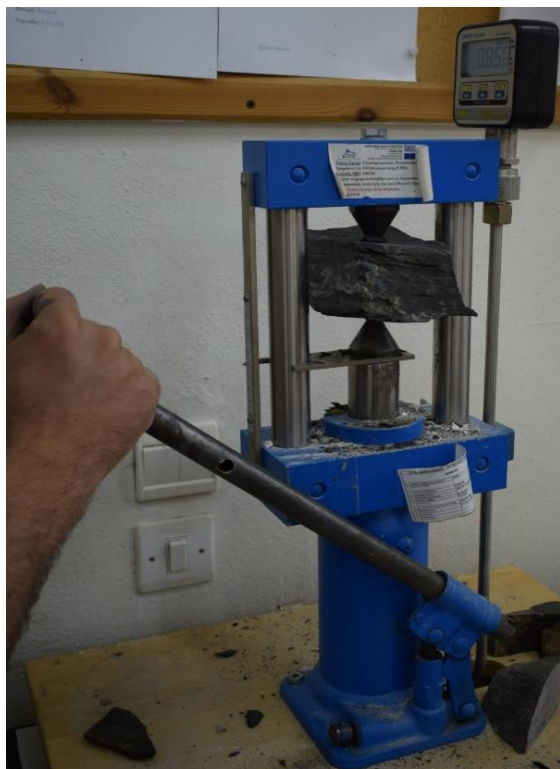
Εικόνα 64. Δοκιμή σημειακής φόρτισης.
