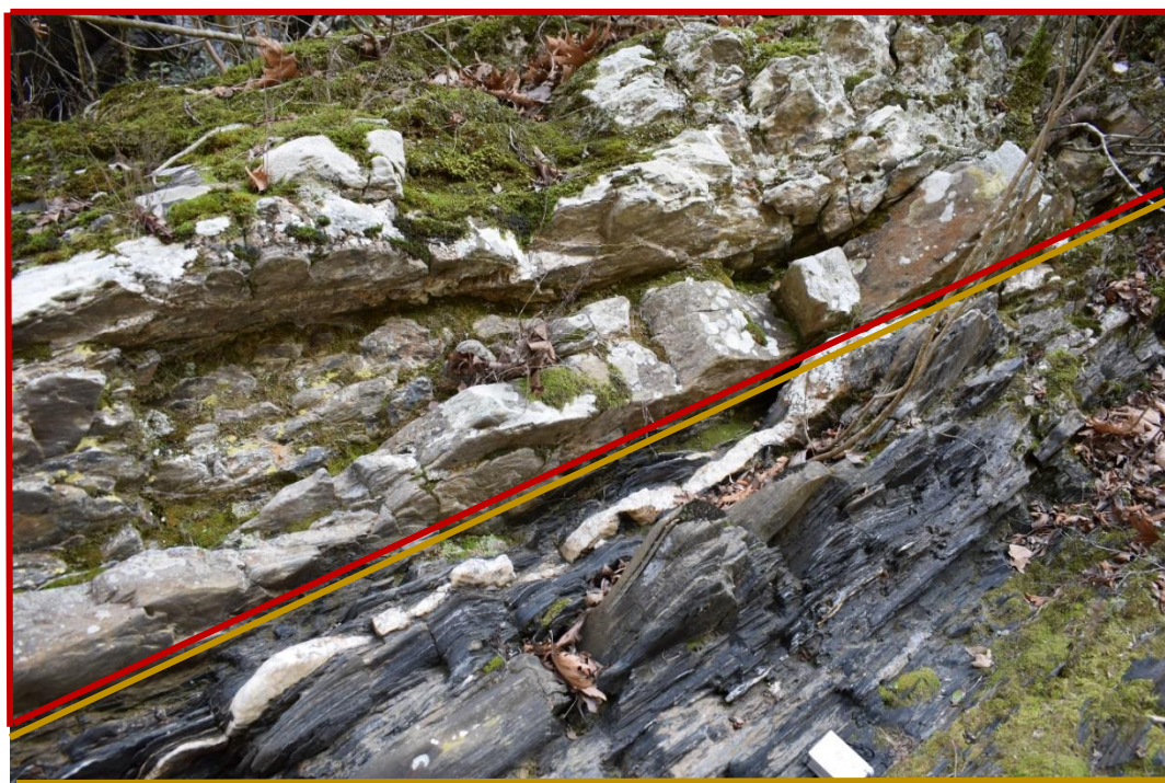
Εικόνα 72. Τεχνικογεωλογική ενότητα 2, στο αριστερό αντέρεισμα, εναλλαγές μεταψαμμίτη (κόκκινο πλαίσιο) με γραφιτικό σχιστόλιθο (κίτρινο πλαίσιο) σε ίσες περίπου αναλογίες.
