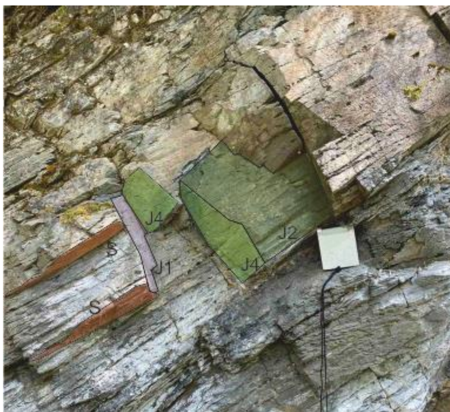
Εικόνα 38. Οικογένειες ασυνεχειών, οι οποίες διατέμνουν την βραχώμαζα, δεξί αντέρεισμα – όψη από το αριστερό αντέρεισμα.
