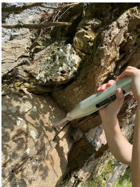
Εικόνα 81. Χρήση σφύρας Schmidt και προφίλομέτρου – επί τόπου μετρήσεις.
