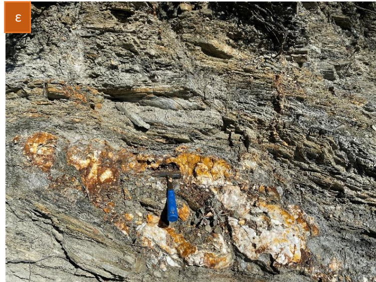
Εικόνα 32. α – β: Εμφάνιση γραφικού σχιστόλιθου, εδαφοποιημένου - γραφικός σχιστόλιθος σε εναλλαγές με αργιλικό σχιστόλιθο – φυλλίτη, γ – δ: σχηματισμός μεταψαμμίτη, δεξι αντέρεισμα - πάγκοι μεταψαμμίτη στην θέση θεμελίωσης του φράγματος, ε – στ: εμφανίσεις φλεβών χαλαζίτη σε εναλλαγές με γραφικό σχιστόλιθο και αργιλικό σχιστόλιθο.
