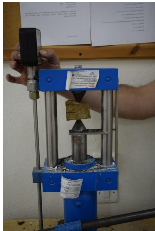
Εικόνα 64. Δοκιμή σημειακής φόρτισης.
