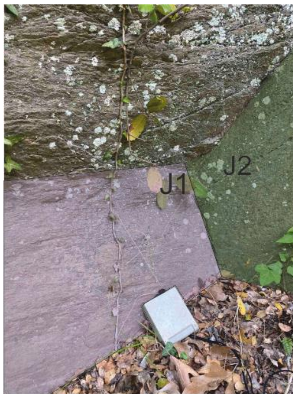
Εικόνα 37. Οικογένειες ασυνεχειών, οι οποίες διατέμνουν την βραχώμαζα, δεξί αντέρεισμα – όψη από το αριστερό αντέρεισμα.
