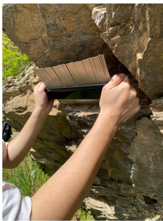
Εικόνα 81. Χρήση σφύρας Schmidt και προφίλομέτρου – επί τόπου μετρήσεις.
