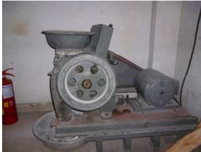
Εικόνα 26. Σιαγονωτός σπαστήρας. Ο συγκεκριμένος χρησιμοποιήθηκε για το σπάσιμο των αρχικά μεγάλων τεμαχών.
