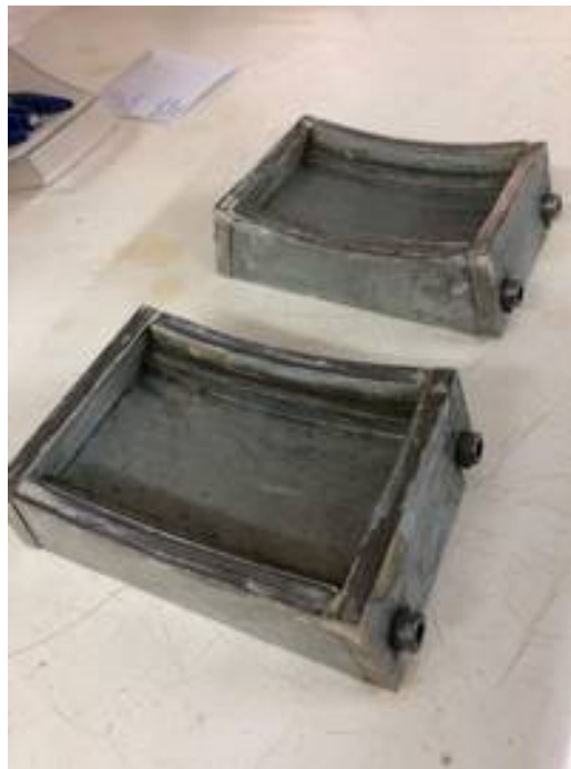
Εικόνα 32. Καλούπια δοκιμίων που χρησιμοποιούνται στη δοκιμή αντίστασης σε λείανση (PSV).
