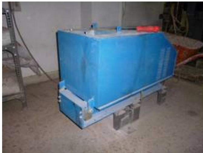
Εικόνα 27. Σιαγονωτός σπαστήρας. Χρησιμοποιήθηκε για το περαιτέρω σπάσιμο των αρχικών τεμαχών.
