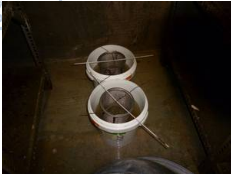
Εικόνα 29. Τα καλάθια με τα αδρανή αναρτώμενα στα δοχεία με το κορεσμένο διάλυμα θειϊκού μαγνησίου.
