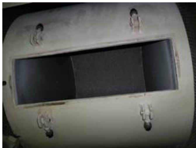
Εικόνα 25. Χαλύβδινος κύλινδρος μηχανής Los Angeles.
