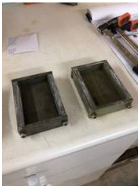
Εικόνα 34. Καλούπια δοκιμών που χρησιμοποιούνται στη δοκιμή αντίστασης σε επιφανειακή απότριψη (AAV).
