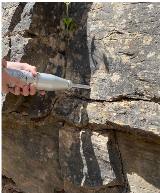
Εικόνα 61: Φωτογραφία από το πεδίο, μετρήσεις με τη σφύρα Schmidt.
