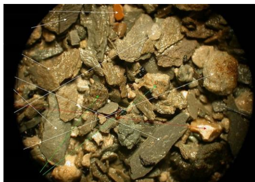
Εικόνα 3.1 Καθαρισμένα θρύμματα σε μικροσκόπιο με μεγέθυνση 10x Πηγή: Wikipedia [27]
