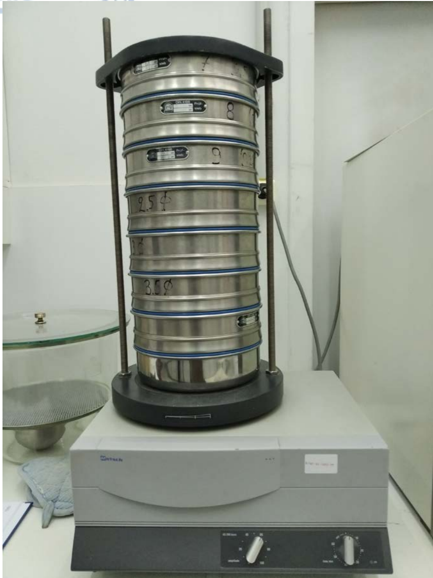
Εικ. 2.7 Μηχάνημα δόνησης με 7 κόσκινα και το δίσκο βάσης στο τέλος, ασφαλισμένο. Κάτω διακρίνονται οι διακόπτες για τον χρόνο δόνησης. Η διαδικασία δεν εκτελείται με όλα τα κόσκινα μαζί. Αρχικά εκτελείται με τα πρώτα 7 και μετά ξανά αλλά 10 λεπτά με τα υπόλοιπα 6 κόσκινα.
