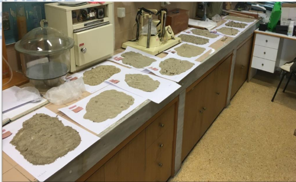
Εικόνα 2.2: Τα δείγματα απλώνονται στο εργαστήριο για να στεγνώσουν
