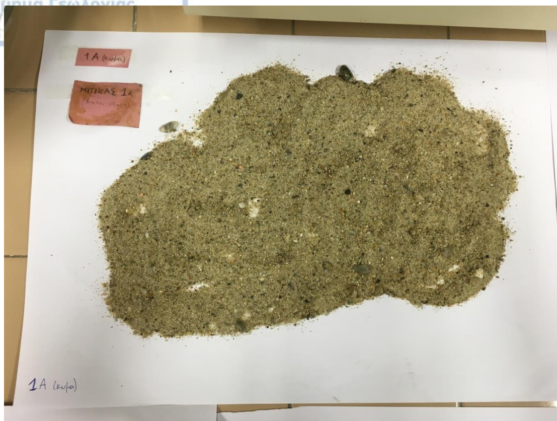
Εικόνα 6.10 Το δείγμα καθαρίζεται από οργανικά και μη ιζηματογενή στοιχεία
