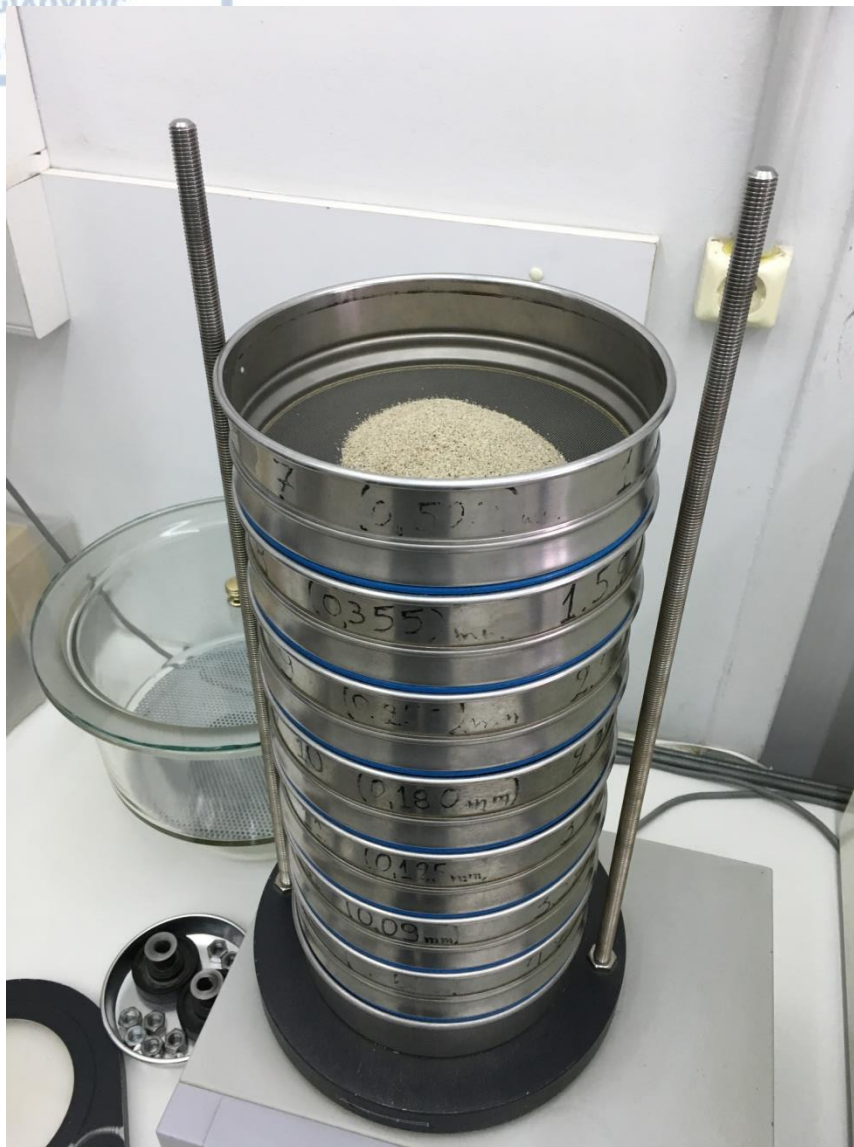
Εικόνα 6.11 Το δείγμα τοποθετείται στον δονητή
