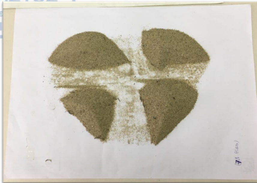
Εικόνα 2.3: Μέθοδος του σταυρού (τετραμερισμός)
