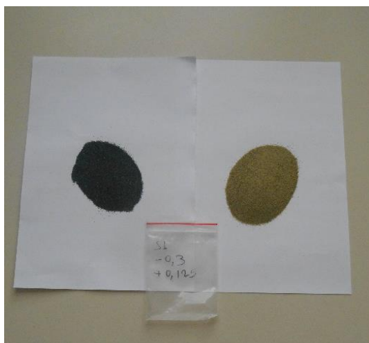
Εικόνες 38. Διαδοχικά στάδια λειτουργίας μαγνητικού διαχωριστή (πάνω). Διαχωρισμένο δείγμα μεγέθους «-0,3 έως +0,125» mm στα 0,5A (μαύρο μαγνητικό, κιτρινοπράσινο μη μαγνητικό) και μαγνητικά διαχωρισμένο δείγμα μεγέθους «-0,5 έως +0,3» mm σε εντάσεις από 1,5 έως 0,2 A (κάτω).
