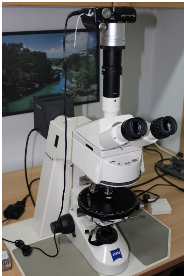
Εικόνα 23-24. Αριστερά: Μεταλλογραφικό και πετρογραφικό μικροσκόπιο Zeiss τύπου Axioskop 40 με ενσωματωμένη φωτογραφική μηχανή Canon τύπου PowerShot A640 του Τομέα Ορυκτολογίας-Πετρολογίας-Κοιτασματολογίας του Α.Π.Θ. Δεξιά: Στερεοσκόπιο τύπου Zeiss με ενσωματωμένη φωτογραφική μηχανή Canon τύπου PowerShot A620 του διατμηματικού εργαστηρίου ηλεκτρονικής μικροσκοπίας του Α.Π.Θ.
