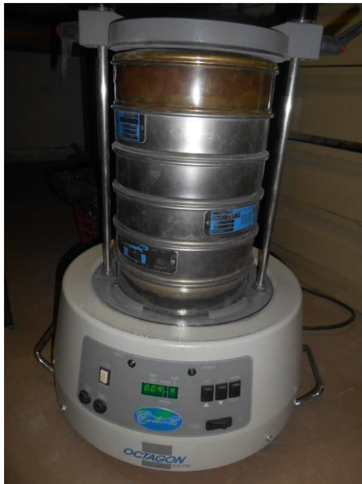
Εικ. 13. Εργαστηριακή συσκευή κοσκίνησης του Τομέα Ορυκτολογίας-Πετρολογίας-Κοιτασματολογίας του ΑΠΘ
