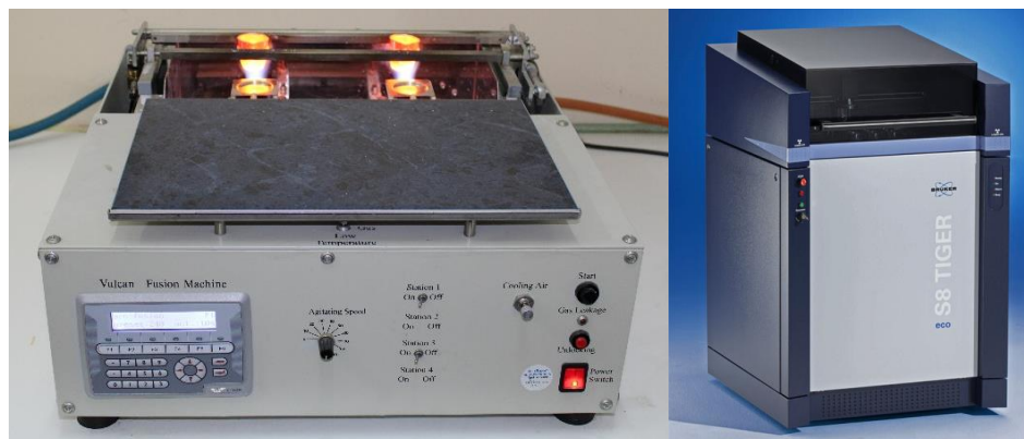
Εικόνα 40. Συσκευή Vulcan για την παρασκευή υαλοποιημένων δισκίων του Τομέα Ορυκτολογίας-Πετρολογίας-Κοιτασματολογίας του Α.Π.Θ. (αριστερά) και φασματόμετρο ακτίνων-X φθορισμού Bruker τύπου S8 Tiger του διατμηματικού εργαστηρίου ηλεκτρονικής μικροσκοπίας του Α.Π.Θ. (δεξιά).
