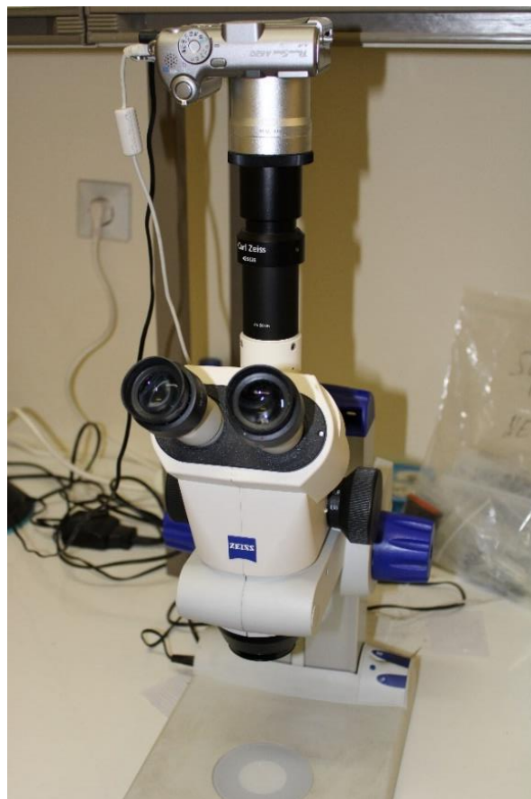
Εικόνα 23-24. Αριστερά: Μεταλλογραφικό και πετρογραφικό μικροσκόπιο Zeiss τύπου Axioskop 40 με ενσωματωμένη φωτογραφική μηχανή Canon τύπου PowerShot A640 του Τομέα Ορυκτολογίας-Πετρολογίας-Κοιτασματολογίας του Α.Π.Θ. Δεξιά: Στερεοσκόπιο τύπου Zeiss με ενσωματωμένη φωτογραφική μηχανή Canon τύπου PowerShot A620 του διατμηματικού εργαστηρίου ηλεκτρονικής μικροσκοπίας του Α.Π.Θ.
