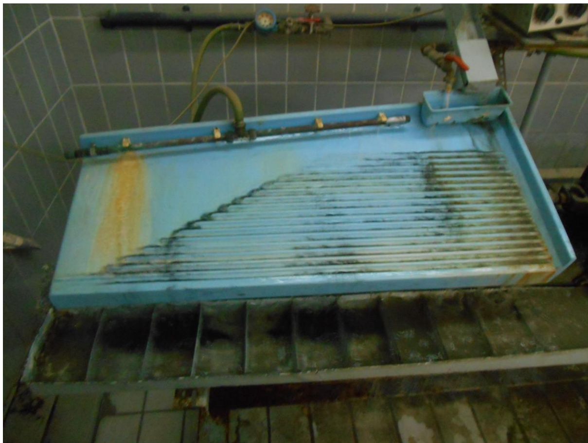
Εικόνα 35. Δονούμενη τράπεζα τύπου Denver BCA-14326/13A/AB του εργαστηρίου Εμπλουτισμού των Μεταλλευμάτων του Τομέα Μεταλλουργίας και Τεχνολογίας Υλικών της Σχολής Μηχανικών Μεταλλείων-Μεταλλουργών του Ε.Μ.Π.
