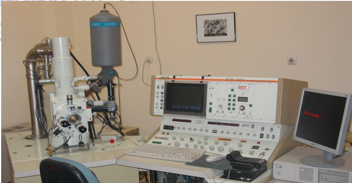
Εικόνα 41. Σαρωτικό ηλεκτρονικό μικροσκόπιο (SEM-EDS) του εργαστηρίου ηλεκτρονικής μικροσκοπίας του Α.Π.Θ.
