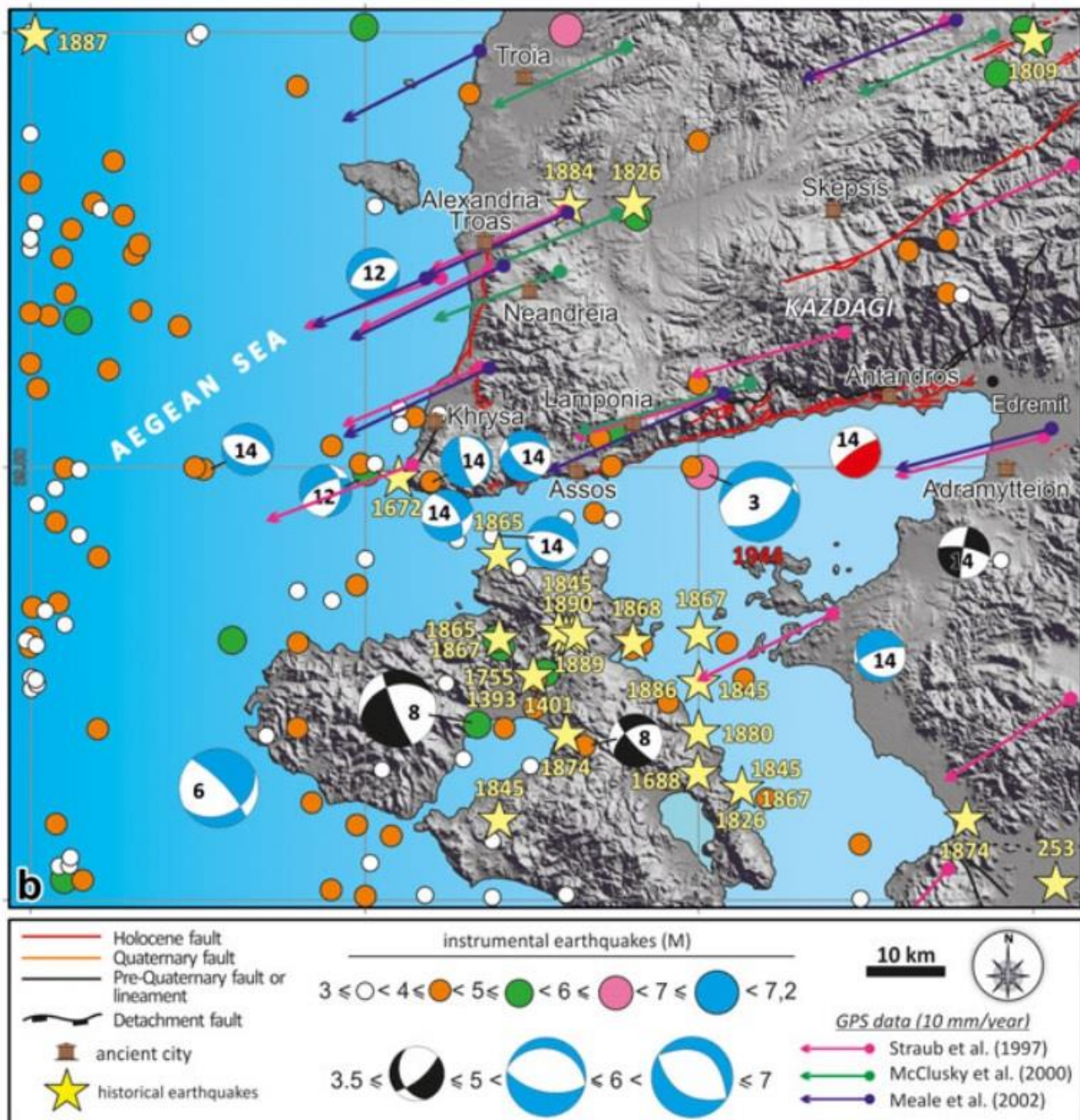
Εικόνα 16: Γεωδυναμικός και σεισμοτεκτονικός χάρτης του Κόλπου του Αδραμυτίου και της νήσου Λέσβου. Πηγή (Hasan Sözbilir Ö. S., 2016)
