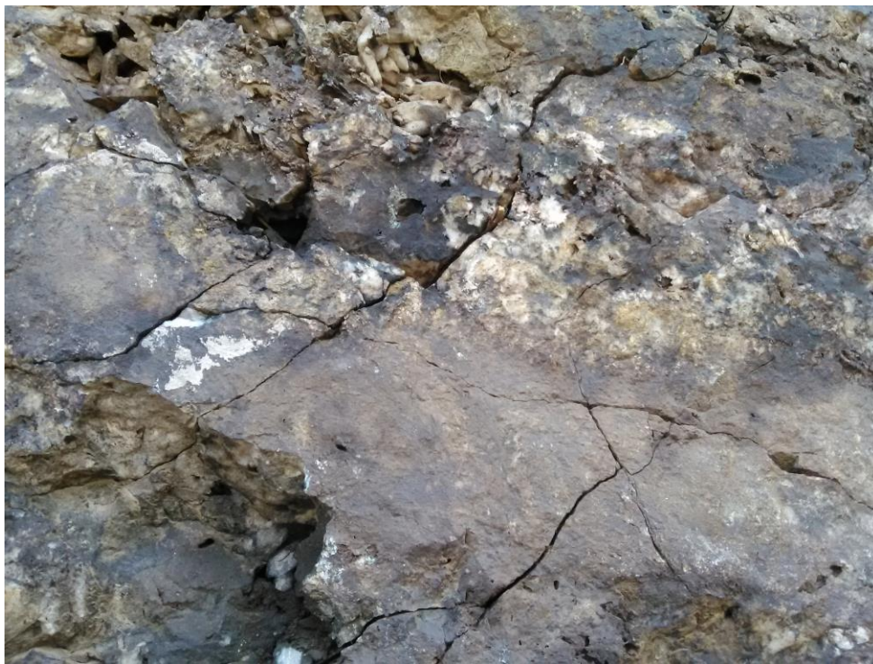
Εικόνα 45: Κοντινή άποψη της επιφάνειας που αποκαλύφθηκε, όπου φαίνεται ο έντονος κερματισμός και μεγάλα κενά. Διακρίνεται ανάπτυξη κρυστάλλων χαλαζία μέσα σε μεγάλες κοιλότητες και μεγάλος ελεύθερος χώρος => υψηλό πορώδες
