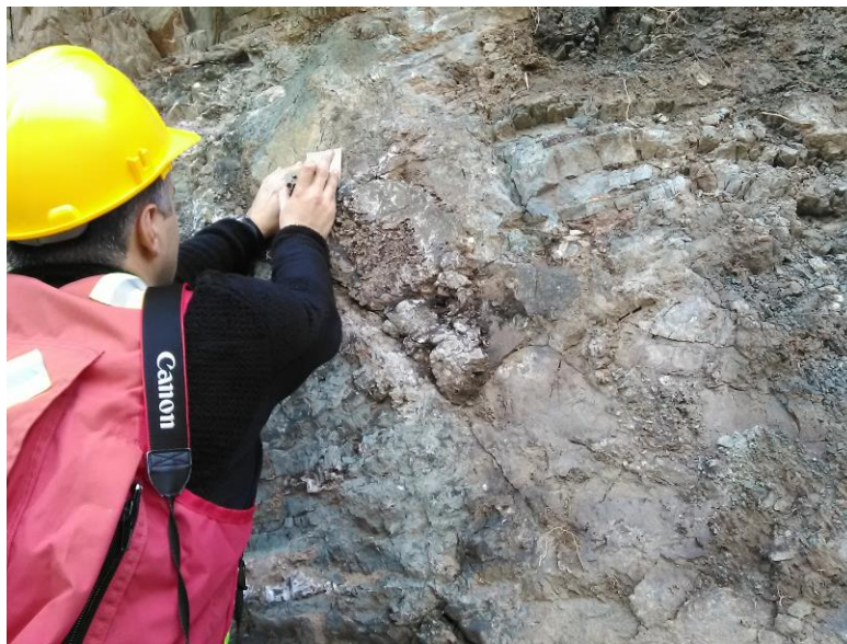
Εικόνα 25: Μέτρηση στοιχείων προσανατολισμού επιφανειών
