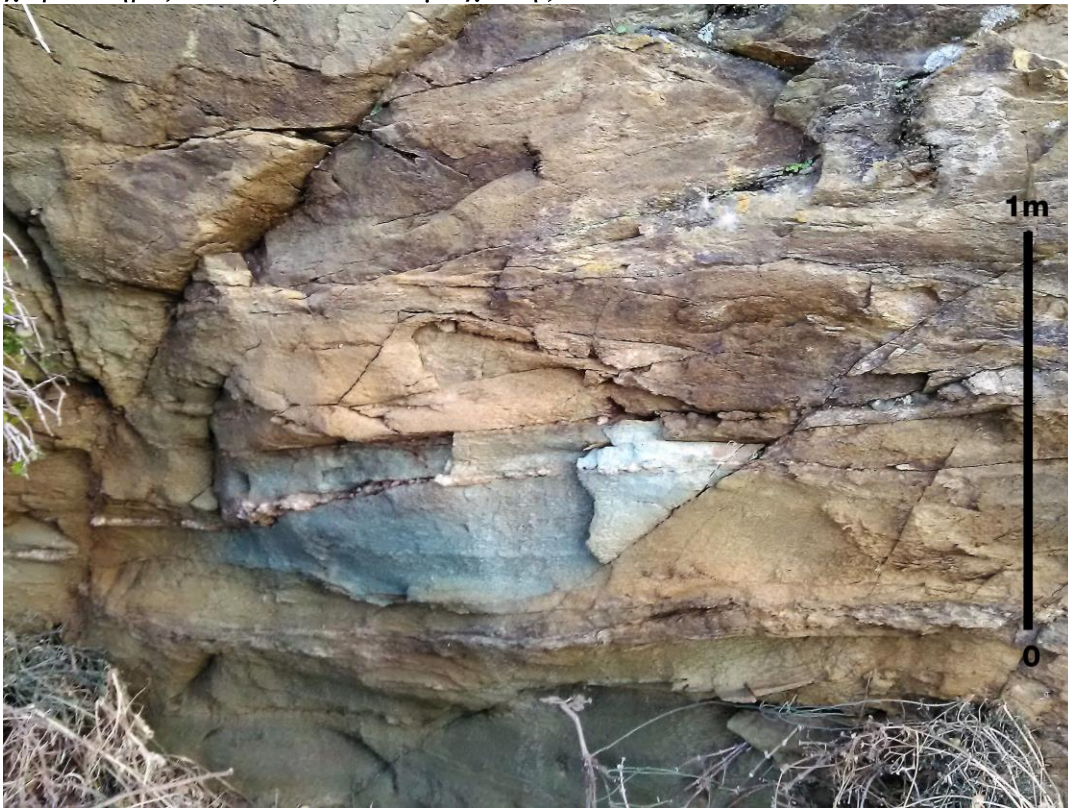
Εικόνα 11: Άποψη του βράχου δίπλα στην θέση της κατολίσθησης. Διακρίνονται τα πολλαπλά συστήματα ασυνεχειών. Η βραχόμαζα χαρακτηρίζεται ως 'πολύ τεμαχώδης' (κατά G.S.I.) και δομείται από σύνθετα πρισματικά μπλοκ.
