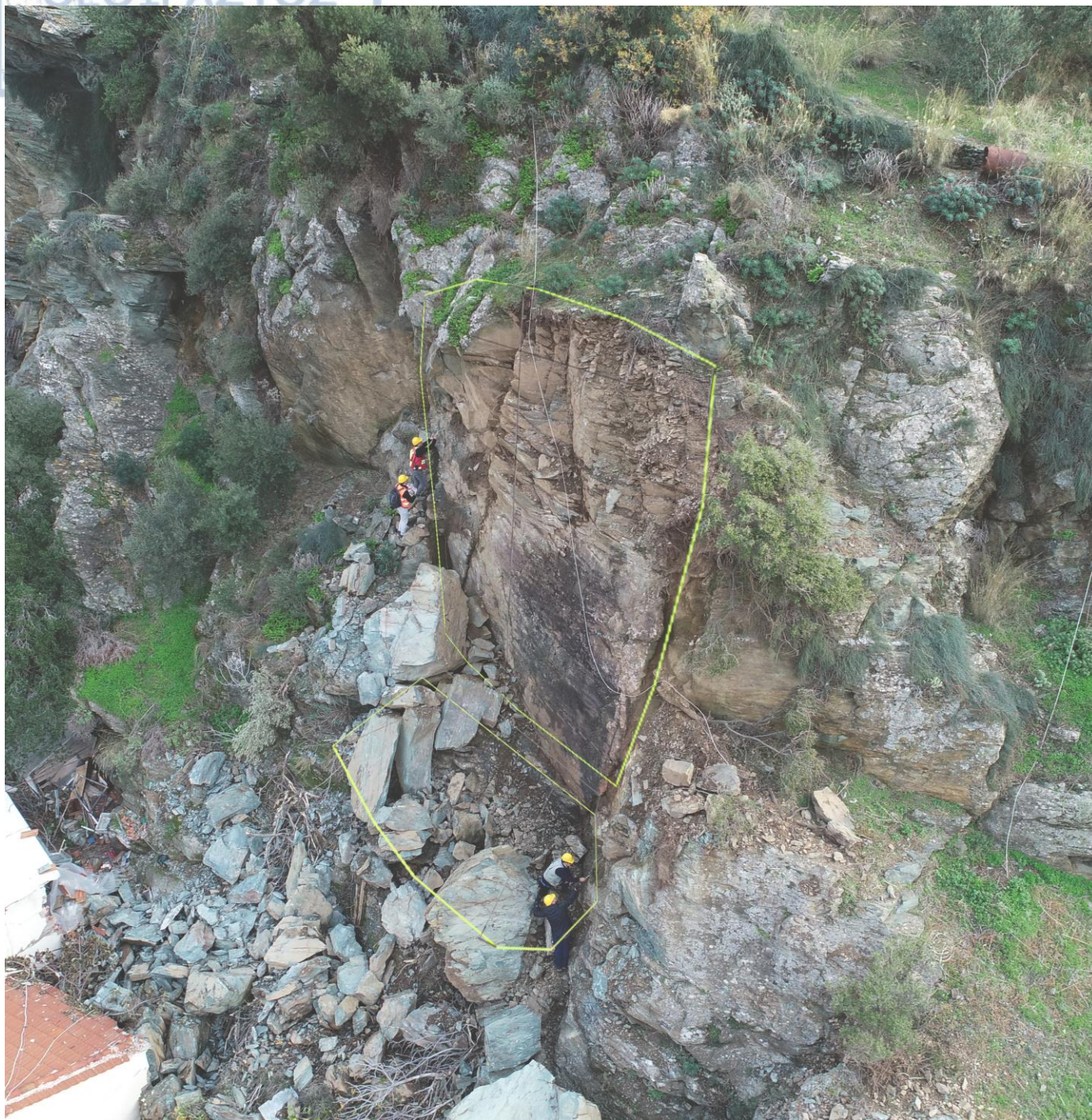
Εικόνα 30: Γεωμετρία αρνητικού όγκου του κατολισθαίνοντος τεμάχους (με κίτρινες γραμμές), κάτοψη, οπίσθια όψη
