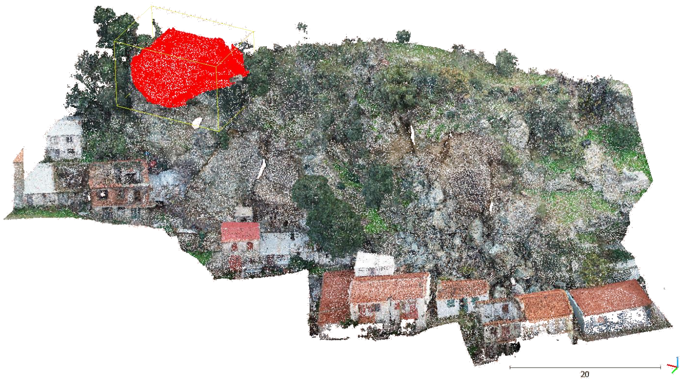
Εικόνα 47: Το κύριο επισφαλές τέμαχος που εντοπίστηκε σημειώνεται με κόκκινο πάνω στο νέφος
