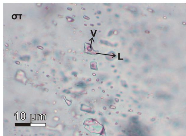
Εικόνα 4.21 Φωτογραφίες των υδροθερμικών σύνδρομων ορυκτών που συνοδεύουν την μεταλλοφορία και των ρευστών εγκλεισμάτων σε χαλαζία στην περιοχή Μυριόφυτου. α) Χαλαζίας (qu) σε σύμφυση με ασβεστίτη (ca). β) Χαλαζίας με χαρακτηριστικό γρानοβλαστικό ιστό και τριπλά σημεία επαφής μεταξύ των κόκκων με γωνίες 120^\circ που είναι αποτέλεσμα ανακρυστάλλωσης. γ) Δευτερογενή ρευστά εγκλείσματα που αναπτύσσονται κατά μήκος επουλωμένων διακλάσεων. δ) Δευτερογενή ρευστά εγκλείσματα που έχουν υποστεί διαφυγή (leaking) και περιέχουν μόνο αέρια φάση. ε, στ.) Διφασικά ρευστά εγκλείσματα πλούσια στην υγρή φάση (L: υγρή φάση, V: αέρια φάση).
