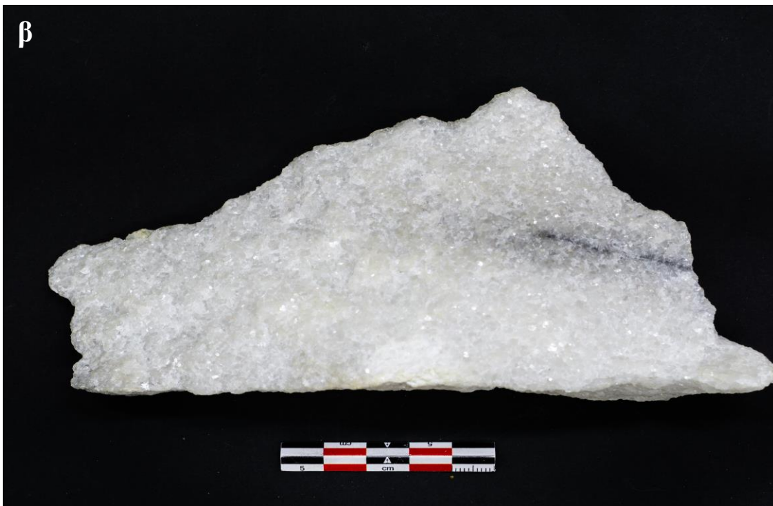
Εικόνα 4.7 α) Μακροσκοπική άποψη 3 ου τύπου μαρμάρου με μικρορήγματα και τεφρές ενστρώσεις, β) Μακροσκοπικό δείγμα 3 ου τύπου.
