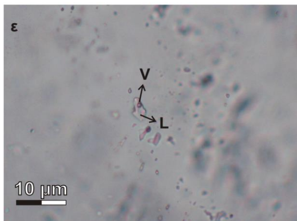
Εικόνα 4.21 Φωτογραφίες των υδροθερμικών σύνδρομων ορυκτών που συνοδεύουν την μεταλλοφορία και των ρευστών εγκλεισμάτων σε χαλαζία στην περιοχή Μυριόφυτου. α) Χαλαζίας (qu) σε σύμφυση με ασβεστίτη (ca). β) Χαλαζίας με χαρακτηριστικό γρानοβλαστικό ιστό και τριπλά σημεία επαφής μεταξύ των κόκκων με γωνίες 120^\circ που είναι αποτέλεσμα ανακρυστάλλωσης. γ) Δευτερογενή ρευστά εγκλείσματα που αναπτύσσονται κατά μήκος επουλωμένων διακλάσεων. δ) Δευτερογενή ρευστά εγκλείσματα που έχουν υποστεί διαφυγή (leaking) και περιέχουν μόνο αέρια φάση. ε, στ.) Διφασικά ρευστά εγκλείσματα πλούσια στην υγρή φάση (L: υγρή φάση, V: αέρια φάση).
