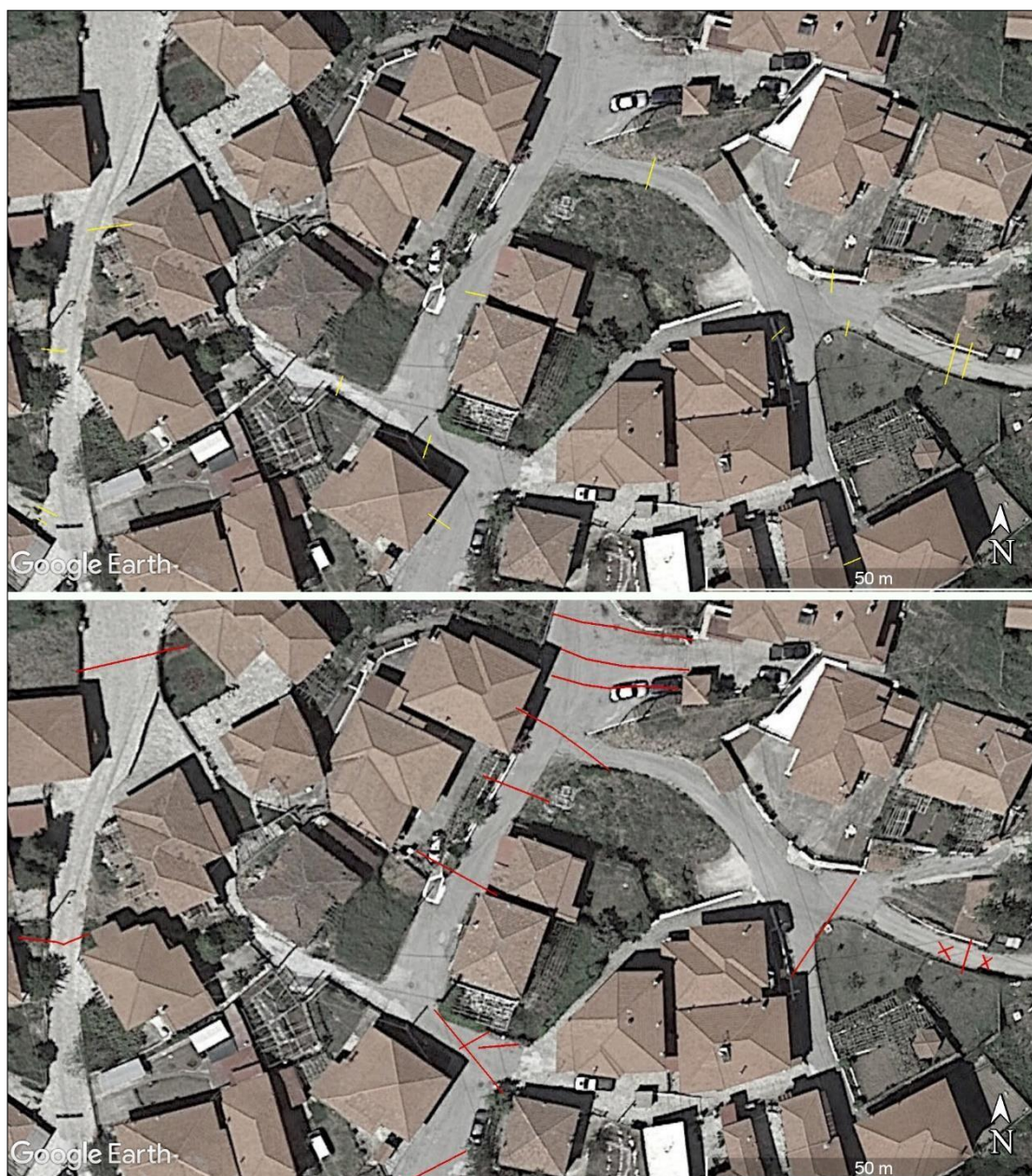
Εικόνα 3-5. Σύγκριση των χαρτογραφημένων ρωγμών του 2008 (επάνω) και του 2019 (κάτω). Βορειότερο τμήμα του οικισμού
