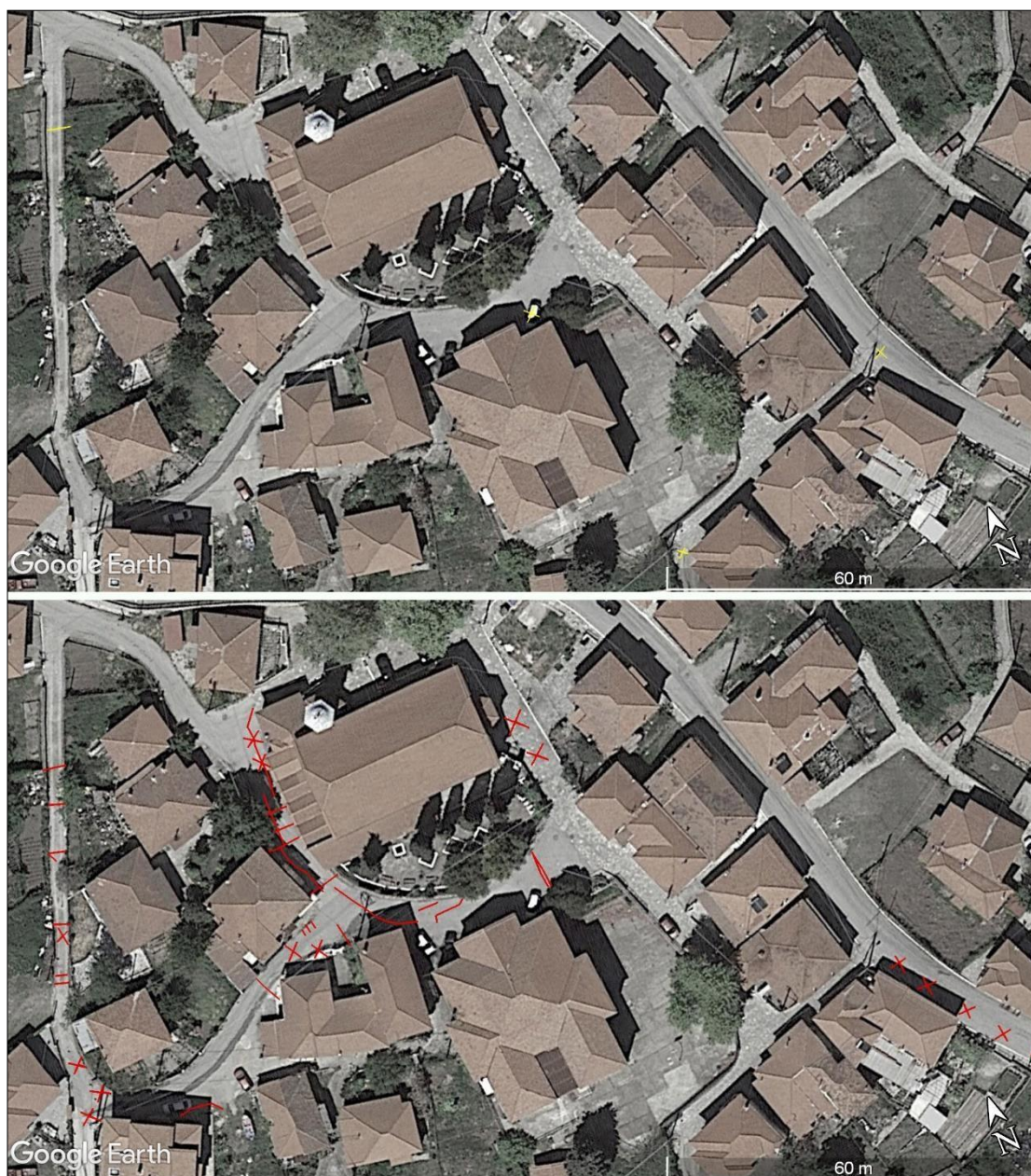
Εικόνα 3-8. Σύγκριση των χαρτογραφημένων ρωγμών του 2008 (επάνω) και του 2019 (κάτω). Κεντρικό-Νότιο τμήμα του οικισμού
