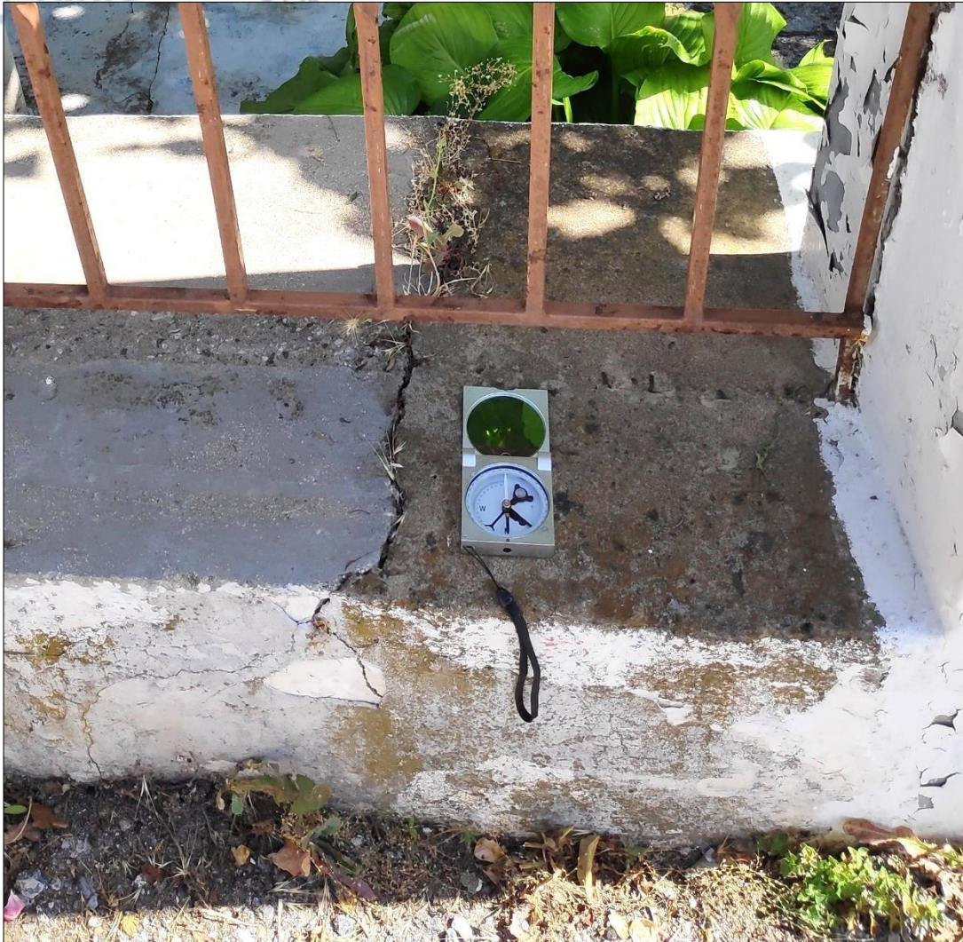
Εικόνα 3-1. Παράδειγμα μέτρησης παράταξης ρώγμωσης με τη χρήση γεωλογικής πυξίδας. Η ρώγμωση βρίσκεται πάνω σε τοίχο περίφραξης οικίας της Στρατονίκης
