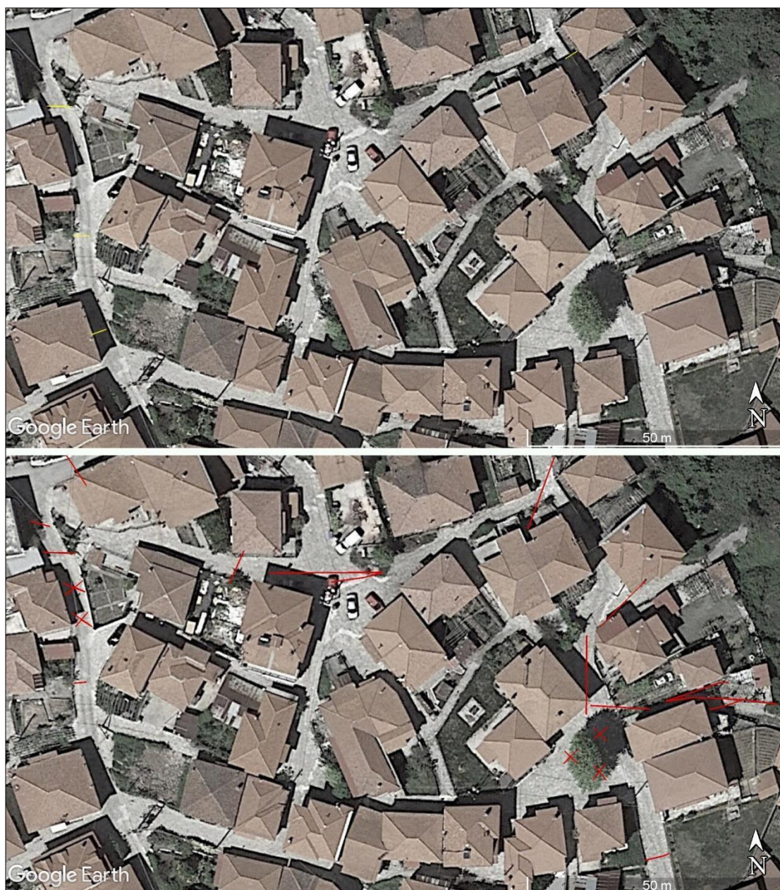
Εικόνα 3-7. Σύγκριση των χαρτογραφημένων ρωγμών του 2008 (επάνω) και του 2019 (κάτω). Κεντρικό-Βορειοανατολικό τμήμα του οικισμού
