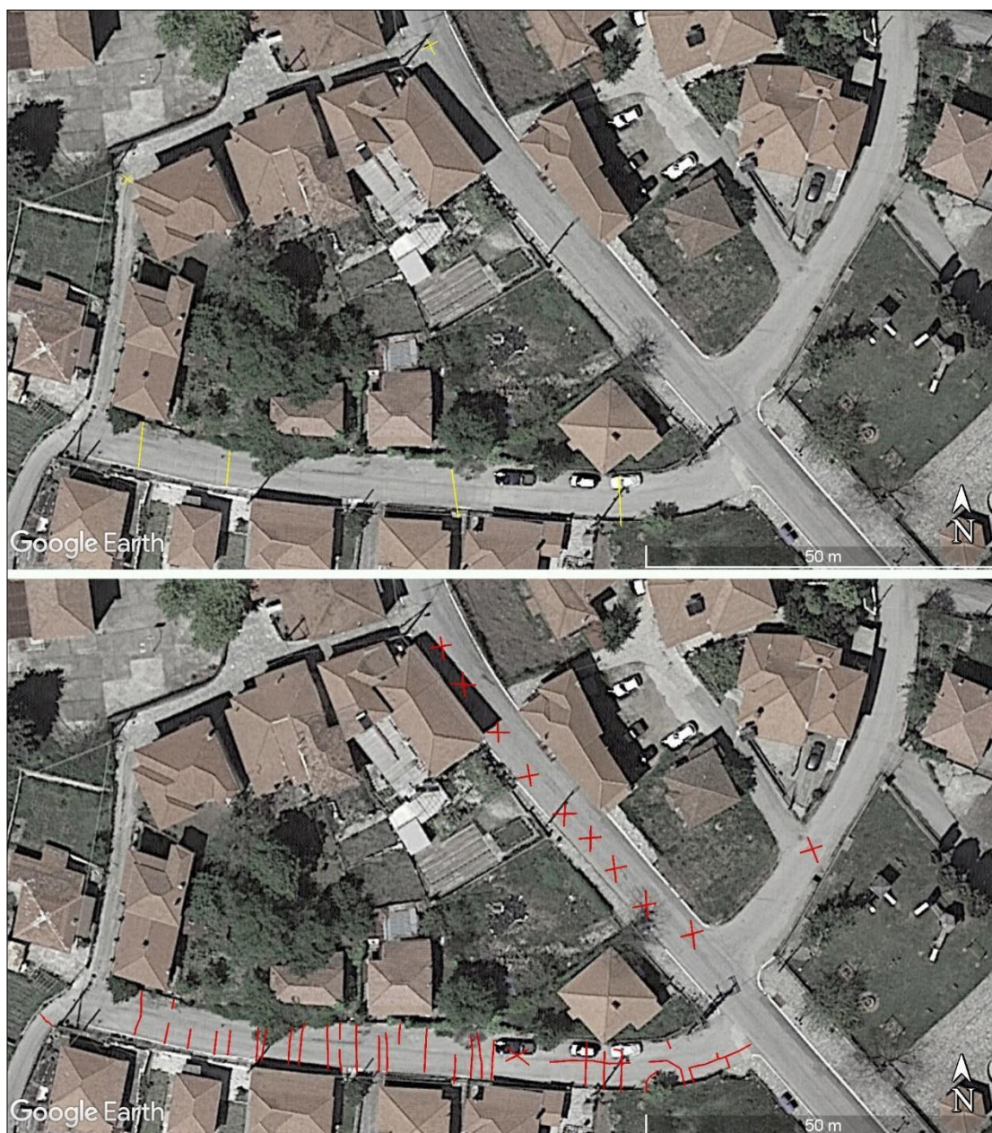
Εικόνα 3-4. Σύγκριση των χαρτογραφημένων ρωγμών του 2008 (επάνω) και του 2019 (κάτω). Νότιο τμήμα του οικισμού
