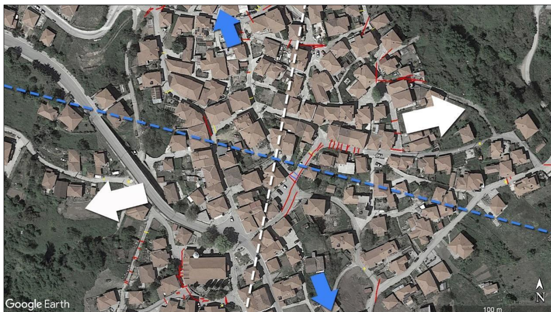
Εικόνα 3-13. Χάρτης του οικισμού της Στρατονίκης με τις κύριες παρατάξεις των ρωγμών (διακεκομμένες γραμμές) και τις κύριες διευθύνσεις κίνησης (βέλη) των τμημάτων που δημιουργούνται
