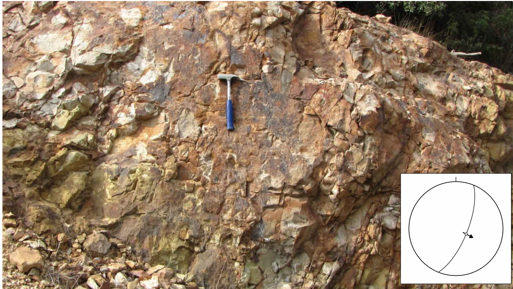
Φωτ. 89. Ρήγμα BBA-NNΔ διεύθυνσης με κανονική συνιστώσα, NA της Ανεμότητας
