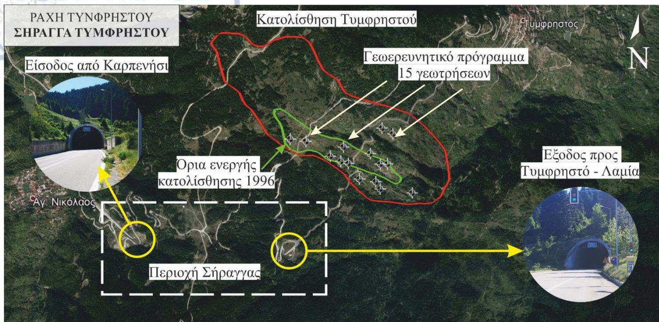
Εικόνα 4.30 Η σήραγγα Τυμφρηστού σε περιβάλλον Google Earth. Με κόκκινο χρώμα σημειώνεται η υπό εξέταση κατολίσθηση, με πράσινο η πρώτη οριοθέτηση της κατολίσθησης το 1996 και με αστεράκια οι θέσεις του γεωερευνητικού προγράμματος 15 γεωτρήσεων που εκτελέστηκε για την μελέτη της. Τέλος, στην εικόνα φαίνονται 2 φωτογραφίες η μία από την είσοδο και η άλλη από την έξοδο της σήραγγας (Φωτογραφίες από τον συγγραφέα).
