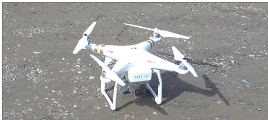
Εικόνα 5.1 Η πλατφόρμα UAV, τύπου DJI Phantom 3 Professional, που χρησιμοποιήθηκε για την αποτύπωση της περιοχής το έτος 2018.
