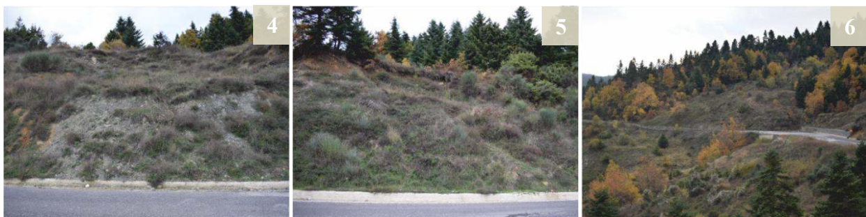
Εικόνα 5.19 Φωτογραφικό υλικό από την έρευνα στο πεδίο. 1 – 6) Περιοχές εντός του ενεργού τμήματος της κύριας κατολίσθησης όπου παρατηρείται μια πιο ακατάστατη μορφολογία του εδάφους, με έντονες ενδείξεις ενεργότητας αποτελούμενης από πολλές μικρότερης κλίμακας περιστροφικές ολισθήσεις.
