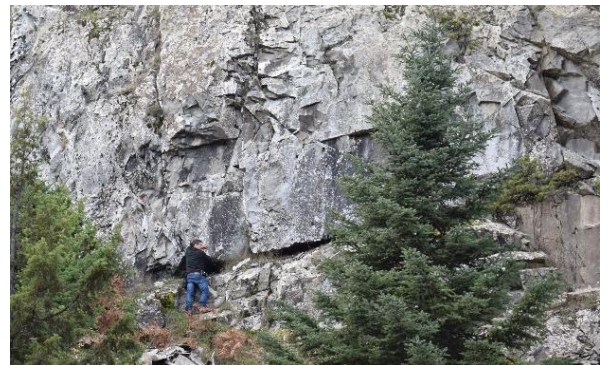
Εικόνα 1.9 Φωτογραφία κατά την χαρτογράφηση πεδίου. Μέτρηση τεκτονικών στοιχείων σε σχηματισμό ψαμμίτη (μέλος φλυσχικού σχηματισμού), στην δυτική πτέρυγα της εν λόγω κατολίθησης, με στόχο την κατασκευή τεκτονικού διαγράμματος.
