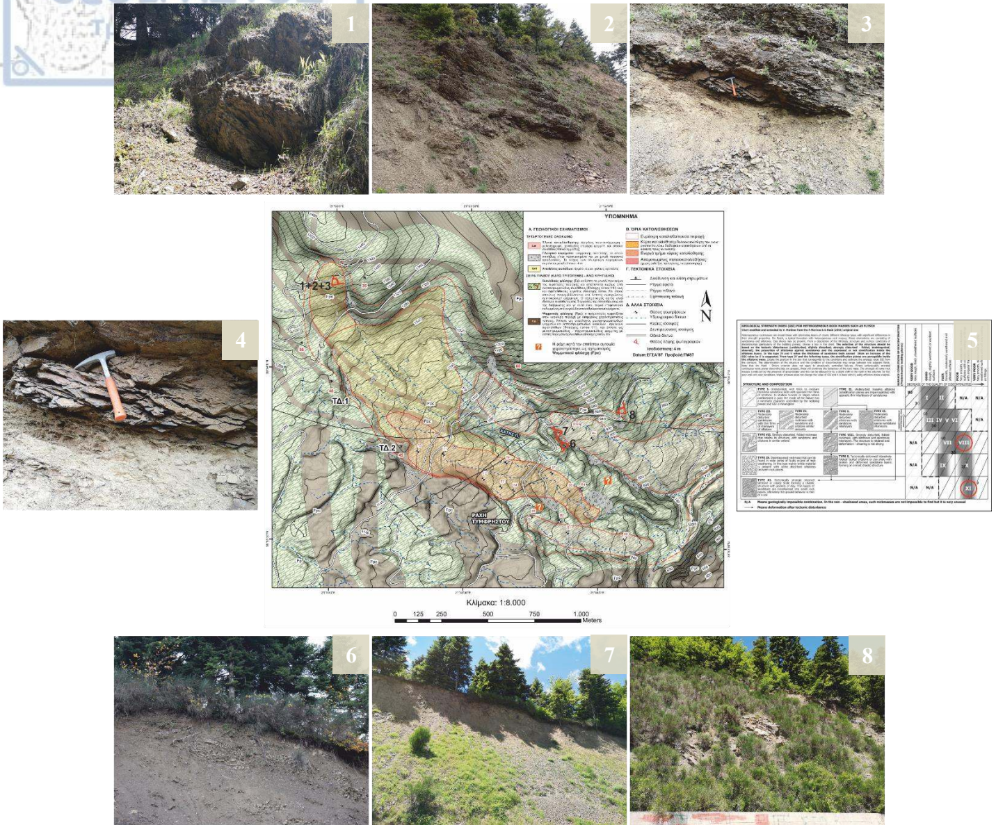
Εικόνα 5.28 Φωτογραφικό υλικό από την χαρτογράφηση στο πεδίο. 1 - 3) Χαρακτηριστικές εμφανίσεις Φλύσχη τύπου IX. 4) Έντονα διατμημένος αργίλικός σχιστόλιθος ο οποίος τεμαχίζεται σε φυλλάκια. 6 - 8) Πιθανές εμφανίσεις Φλύσχη τύπου VIII στα όρια της ανατολικής πτέρυγας και τοπικά στο ανώτερο τμήμα της κεντρικής ράχης επί του νέου οδικού δικτύου Λαμίας - Καρπενησίου. 5) Ταξινόμηση επιμέρους πιο ιλυολιθικών μελών του φλύσχη κατά το σύστημα ταξινόμησης GSI για ετερογενείς βραχώμαζες όπως ο φλύσχη (V. Marinis, 2017). Σημείωση: οι θέσεις και προσανατολισμός των φωτογραφιών αποτυπώνονται με κόκκινο χρώμα πάνω στον χάρτη.
