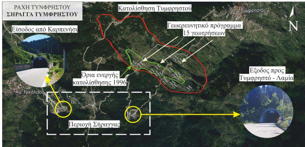
Εικόνα 1.6 Η σήραγγα Τυμφρηστού σε περιβάλλον Google Earth. Με κόκκινο χρώμα σημειώνεται η υπό εξέταση κατολίσθηση, με πράσινο η πρώτη οριοθέτηση της κατολίσθησης το 1996 και με άσπρα αστέρια οι θέσεις του γεωερευνητικού προγράμματος 15 γεωτρήσεων που εκτελέστηκε για την μελέτη της. Τέλος, στην εικόνα φαίνονται 2 φωτογραφίες η μία από την είσοδο και η άλλη από την έξοδο της σήραγγας (Φωτογραφίες από τον συγγραφέα).
