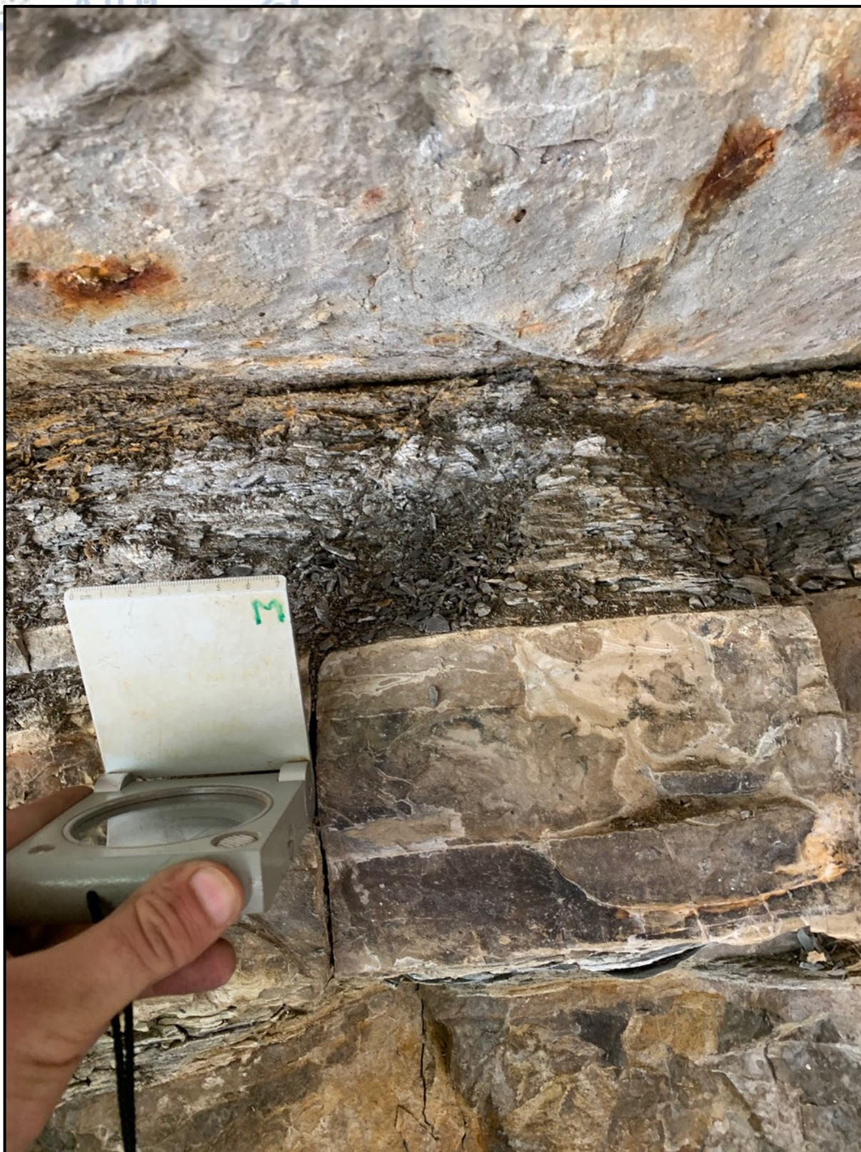
Εικόνα 12. Κοντινή λεπτομερής φωτογραφία της σχεδόν φυλλοποιημένης ζώνης του σχηματισμού.
