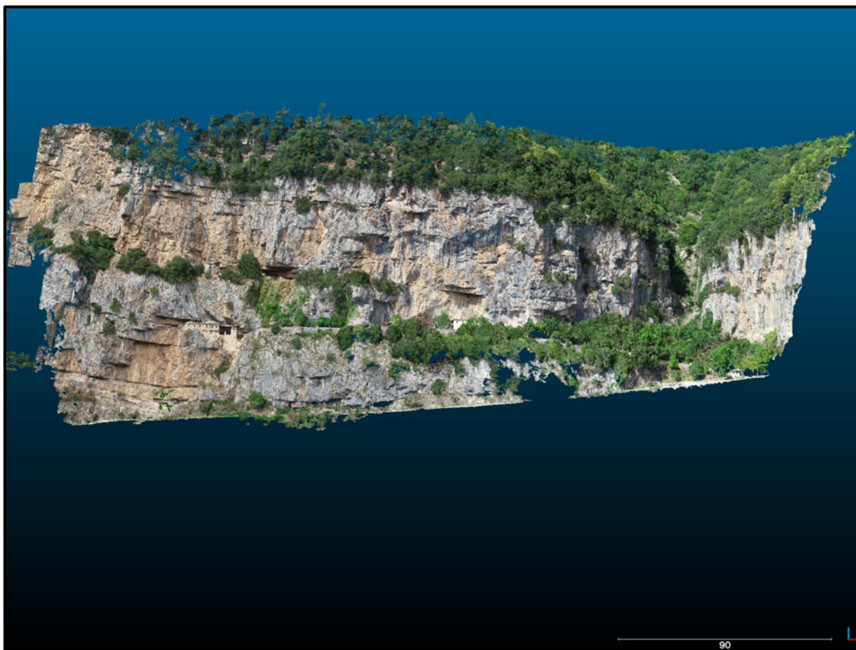
Σχήμα 27. Παράδειγμα ενός ολοκληρωμένου τρισδιάστατου μοντέλου νέφους σημείων, από τη περιοχή μελέτης της παρούσας εργασίας, της Ιεράς Μονής Κηπίνας.
