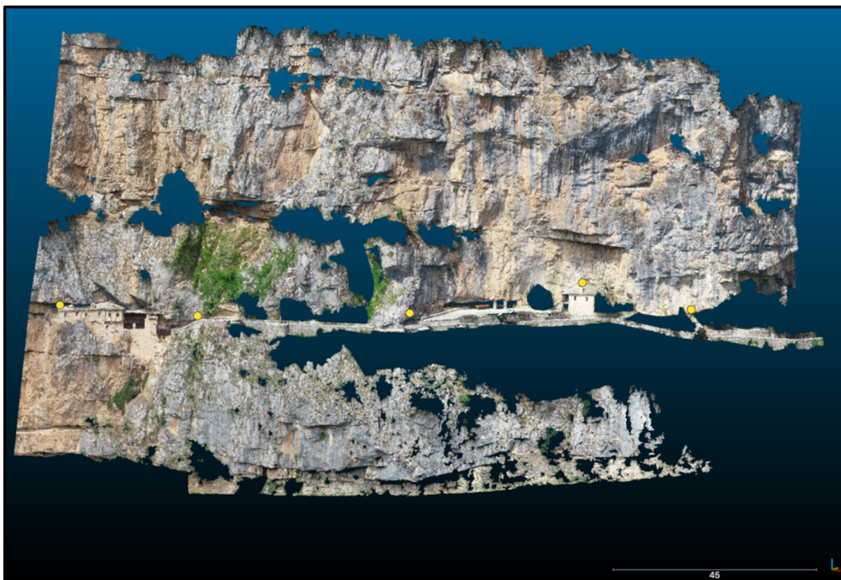
Σχήμα 32. Εικόνα του επεξεργασμένου τρισδιάστατου μοντέλου νέφους σημείων της περιοχής μελέτης, αφού του έχει αφαιρεθεί θόρυβος και βλάστηση. Με κίτρινες τελείες διακρίνονται οι θέσεις των πέντε (5) διαφορετικών GCPs.
