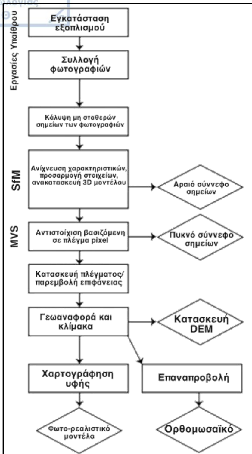
Σχήμα 26. Διάγραμμα ροής όπου παρουσιάζεται μία τυπική μεθοδολογία φωτογραμμετρίας (Bemis et al., 2014; τροποποιημένο από Κωνσταντίνιδη, 2019) .
