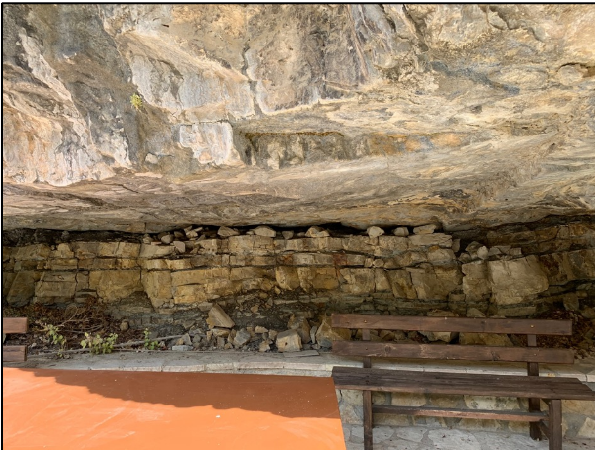
Εικόνα 10. Εμφάνιση ζώνης αδυναμίας, στο επίπεδο της στρώσης, όπου το υλικό εμφανίζει σχιστοποιημένη εικόνα.
