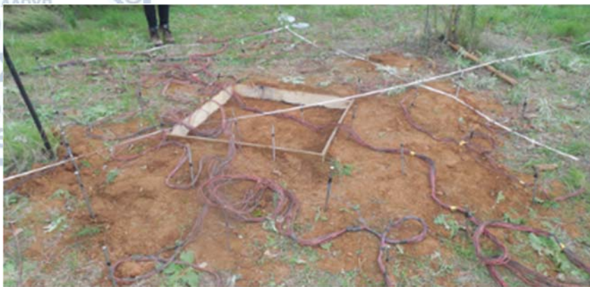
Σχήμα 5. 3. Δημιουργία κανάβου για τη λήψη 3D μετρήσεων στη θέση Α.
