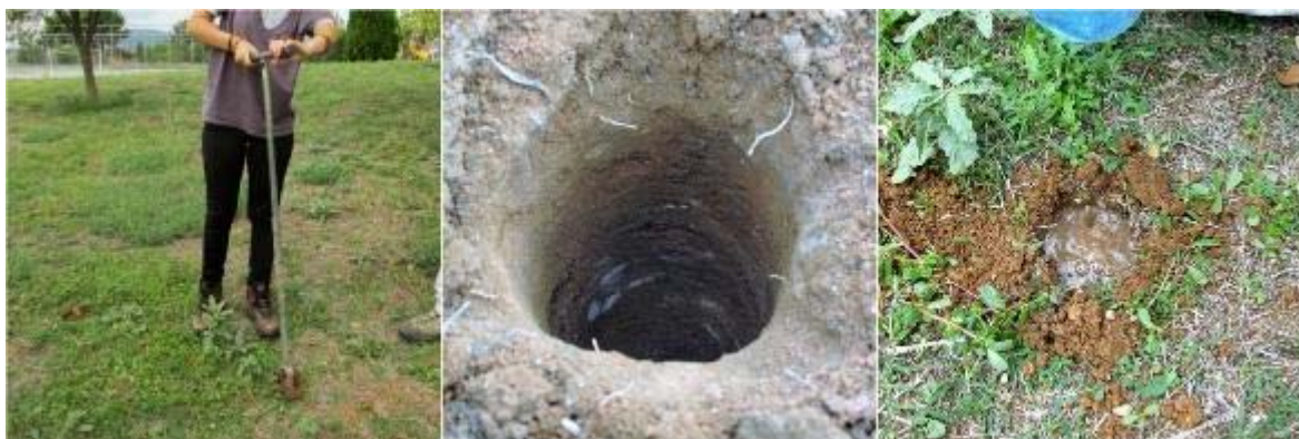
Σχήμα 4.13. Διάνοιξη οπής με σπαστό τρυπάνι. Ασωλήνωτη οπή. Οπή πληρωμένη με νερό.
