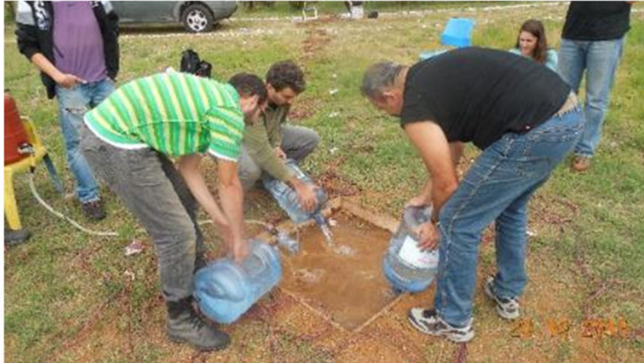
Σχήμα 5. 40. Τροφοδοσία νερού στο σκάμμα και ταυτόχρονη λήψη μετρήσεων σε δύο διαστάσεις (Θέση Β).
