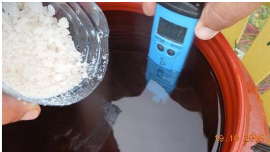
Σχήμα 5. 39. Μέτρηση αγωγιμότητας του νερού πριν από την έναρξη του πειράματος.
