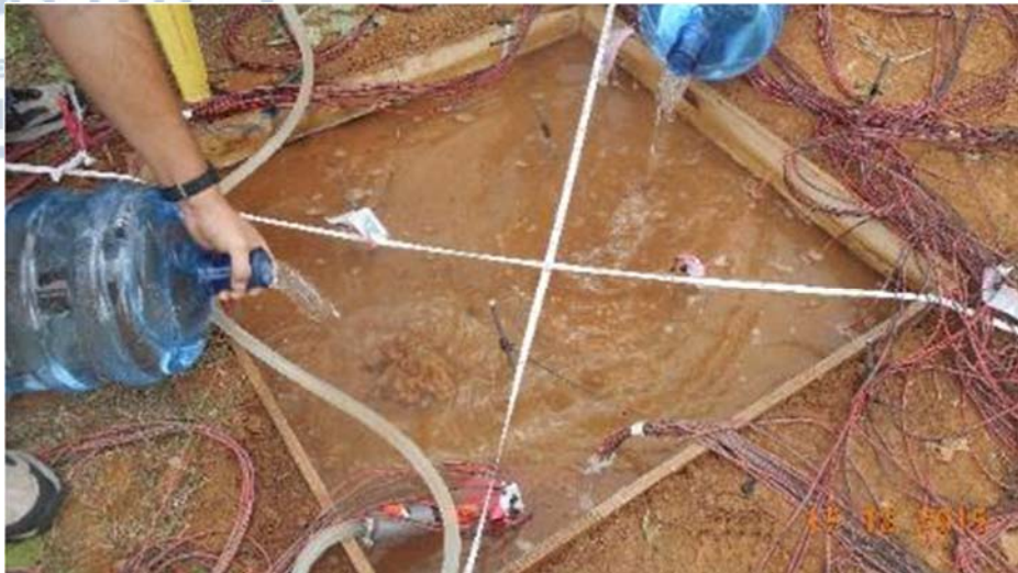
Σχήμα 5. 17. Τροφοδοσία νερού στο σκάμμα και ταυτόχρονη λήψη μετρήσεων σε δύο διαστάσεις (Θέση Α).
