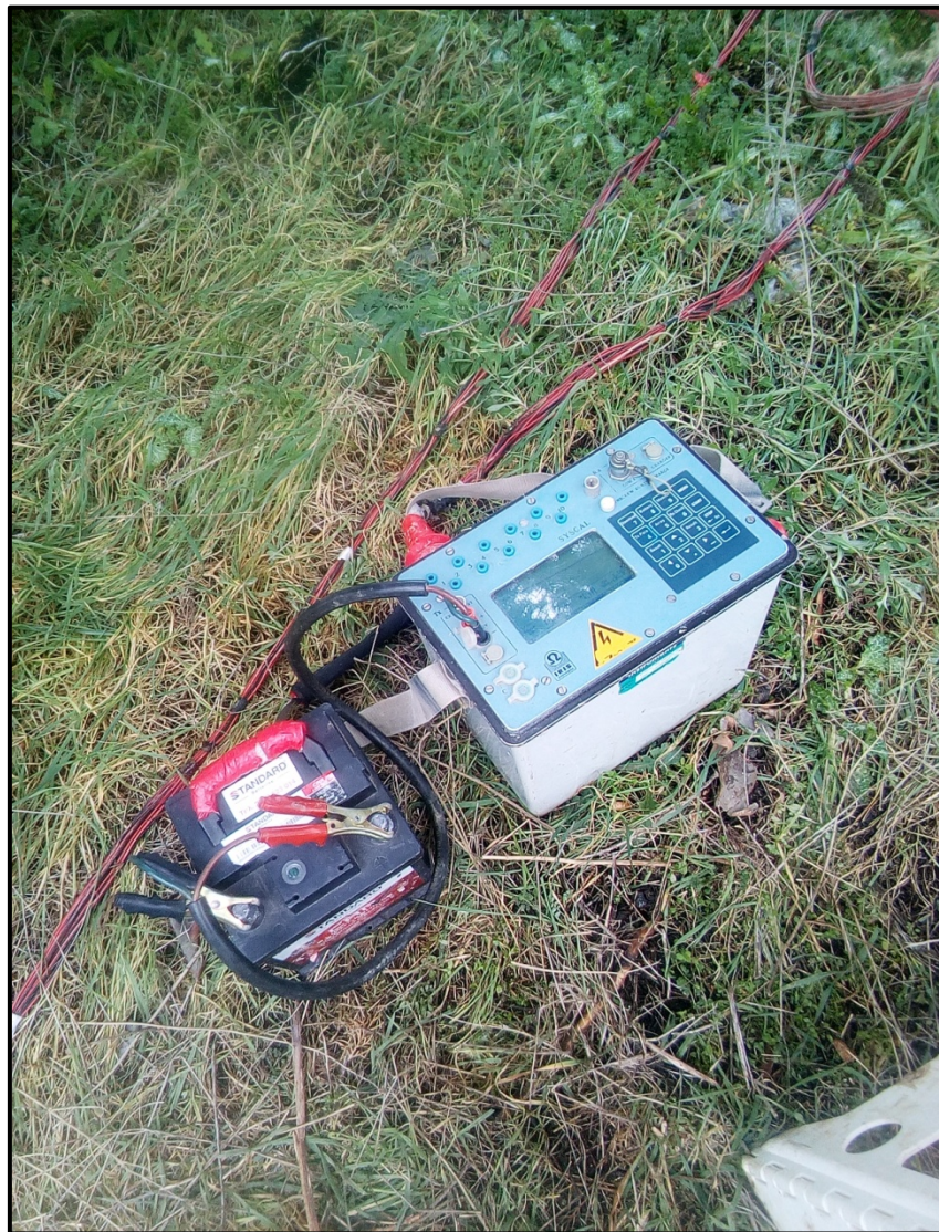
Εικόνα 3.8 Φωτογραφία του οργάνου μέτρησης, της εξωτερικής μπαταρίας με την οποία αυτό συνδέθηκε και του πολυκάναλου καλωδίου.
