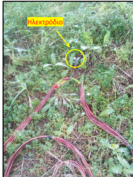
Εικόνα 2.6 Ηλεκτρόδιο καρφωμένο στο έδαφος και συνδεδεμένο με πολύκλωνο καλώδιο.
