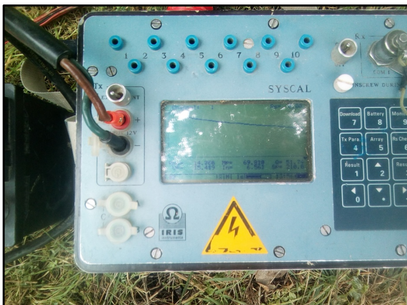
Εικόνα 3.12 Φωτογραφία του οργάνου Syscal Pro. Στην οθόνη του παρουσιάζεται η αποτύπωση μιας μέτρησης με τη μορφή καμπύλης.
