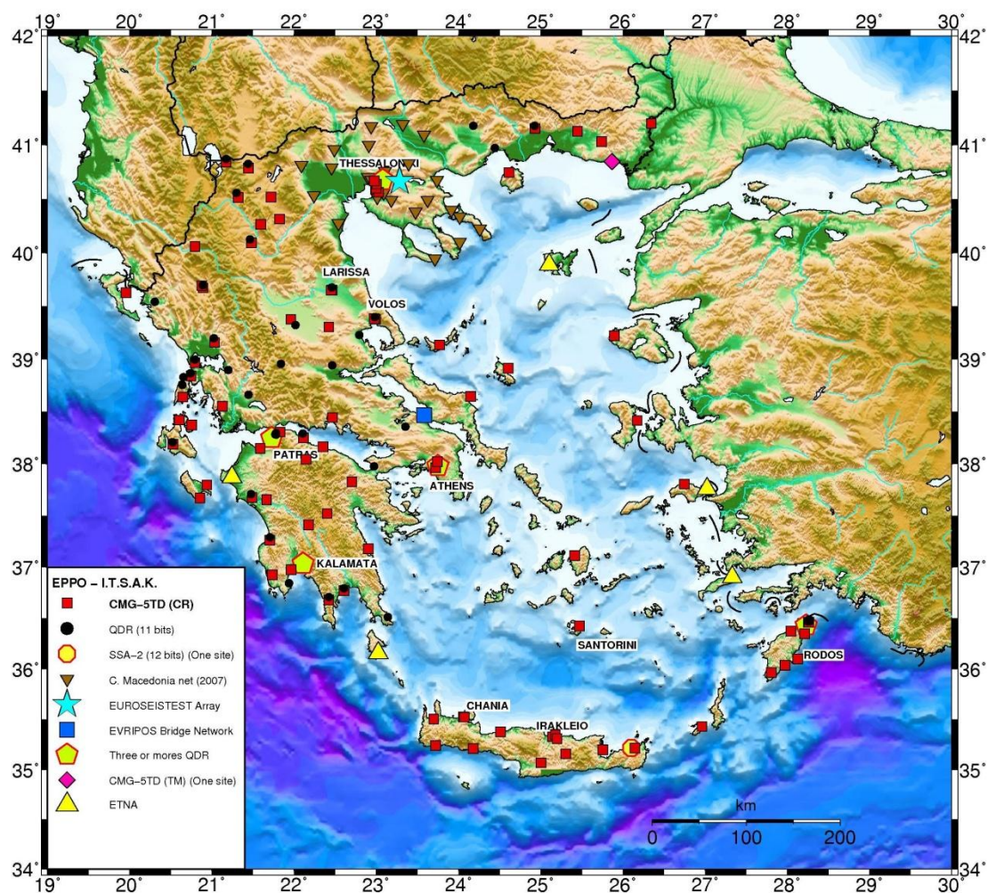
Σχήμα 1.2.2: Οι θέσεις των επιταχυνσιογράφων του δικτύου του ΙΤΣΑΚ στον Ελλαδικό χώρο. Κάτω αριστερά, στο υπόμνημα, αναγράφονται και τα ερευνητικά προγράμματα, στα οποία ανήκει ο κάθε σταθμός. (Πηγή: http://www.itsak.gr/page/infrastructures/networks/acc_network )
