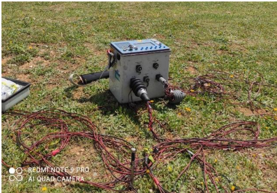
Σχήμα 7.24 Το όργανο Syscal Pro του τομέα Γεωφυσικής
