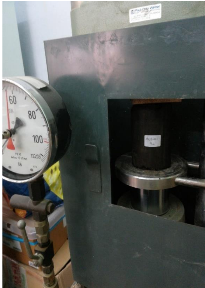
Εικόνα 51: Διατμητική θραύση δοκιμίου λόγω δράσης ορθής τάσης \sigma_1 , αποτέλεσμα δοκιμής μονοαξονικής θλίψης στο εργαστήριο εδαφομηχανικής του τμήματος Γεωλογίας Α.Π.Θ
