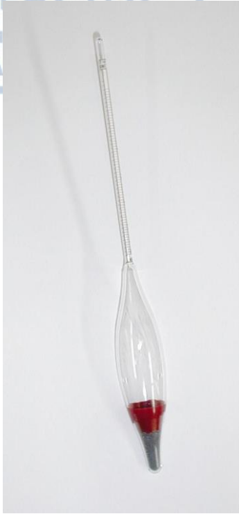
Εικόνα 45: Αραιόμετρο για την εκτέλεση της κοκκομετρικής ανάλυσης λεπτόκοκκων εδαφικών συστατικών
