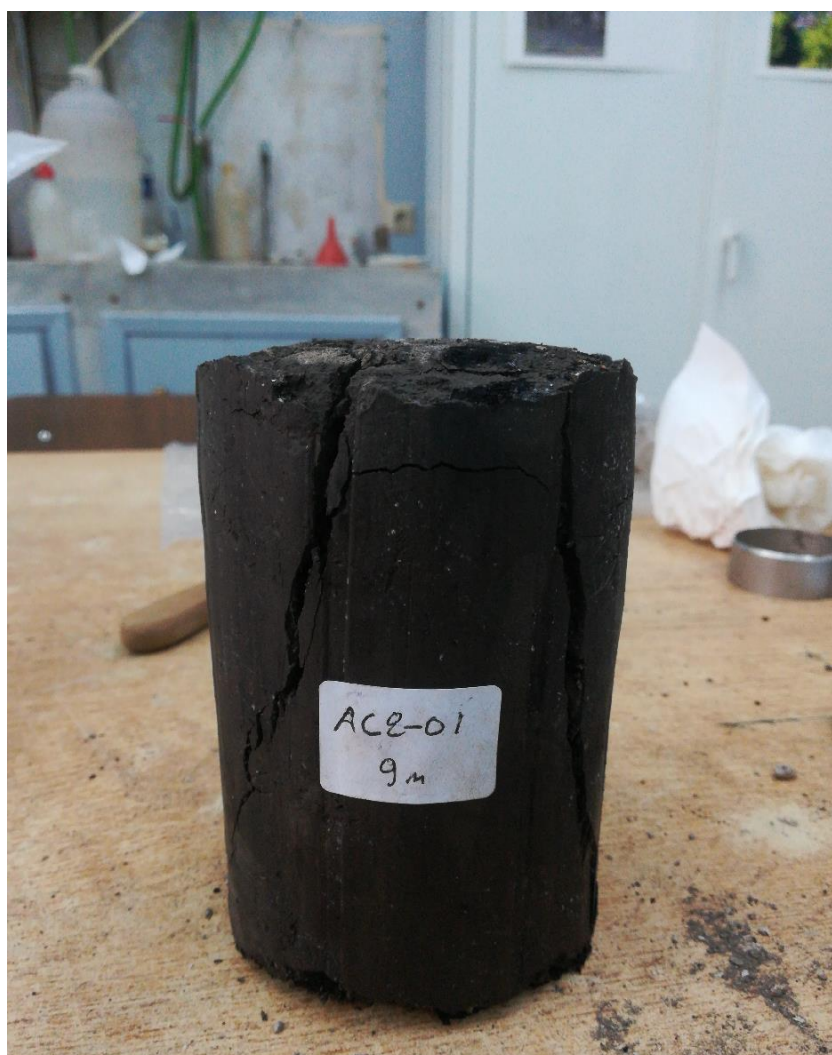
Εικόνα 52: Παρατηρείται η διατμητική θραύσης της οργανικής αργιλοιλίδος μετά το πέρας της δοκιμής της ανεμπόδιστης θλίψης
