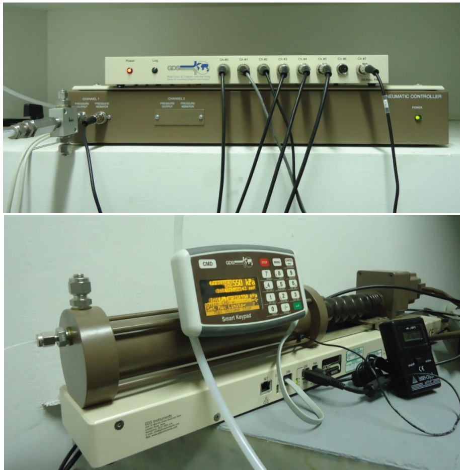
Εικόνα 56: Πνευματικός ελεγκτής υψηλής ακρίβειας αέρα "Pneumatic Pressure Controller (GDSPPC)", : Ηλεκτρονικός ελεγκτής υψηλής ακρίβειας νερού "Standard Pressure/Volume Controller (STDDPC) v2" (Βλάχος, 2015)
