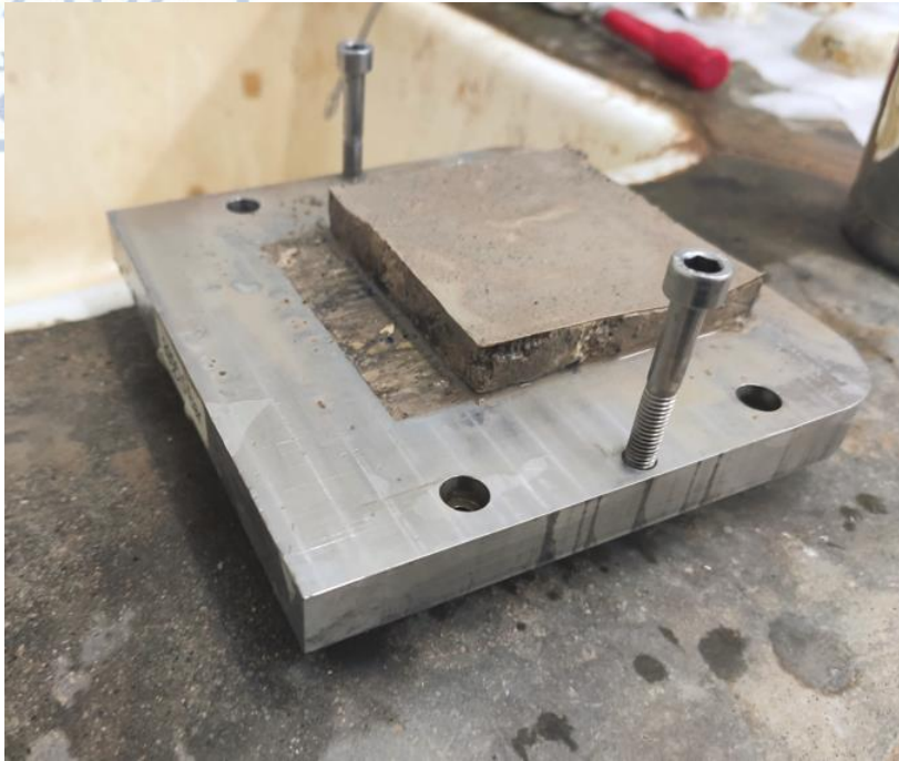
Εικόνα 61: Εδαφικό δοκίμιο μετά την δοκιμή της άμεσης διάτμησης με την χαρακτηριστική θραύση του στην προκαθορισμένη επιφάνεια διάτμησης
