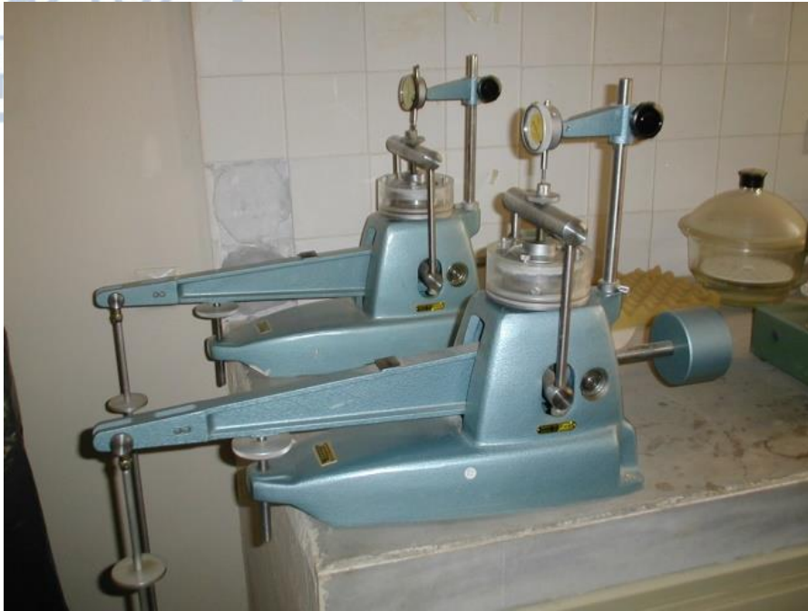
Εικόνα 65: Οιδήμετρα του Εργαστηρίου Τεχνικής Γεωλογίας & Υδρογεωλογίας, Τμήματος Γεωλογίας ΑΠΘ
