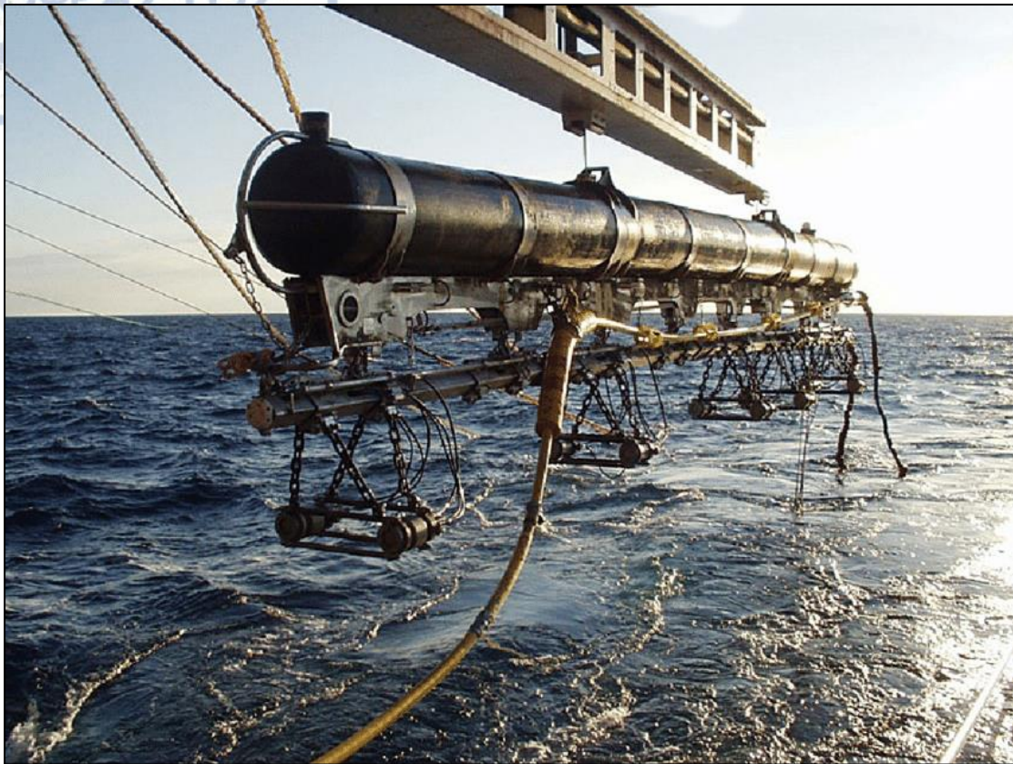
Εικόνα 2. Air gun array. Τα air guns κρέμονται σε ζεύγη, ενώ η παροχή αέρα γίνεται μέσω του κίτρινου λάστιχου. (Πηγή: www.sercel.com )
