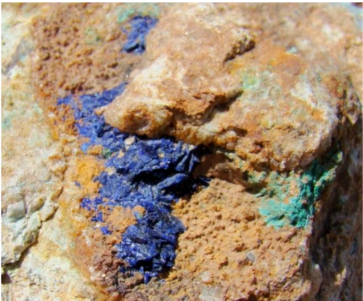
Σχήμα 6.2a Απεικόνιση ζώνης οξείδωσης, με χρώμα μπλε αντικατοπτρίζεται το ορυκτό αζουρίτης, με πράσινο ο μαλαχίτης και με καφέ διάφορα ένυδρα ορυκτά του Fe (B. Μέλφος).
