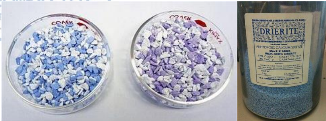
Εικόνα 5. Αριστερά: Drierite με δείκτη κορεσμού υγρασίας (φρέσκος και εξαντλημένος). Δεξιά: Τυπική εμπορική συσκευασία Drierite (Πηγή: http://195.134.76.37/chemicals/chem_CaSO4.htm )
