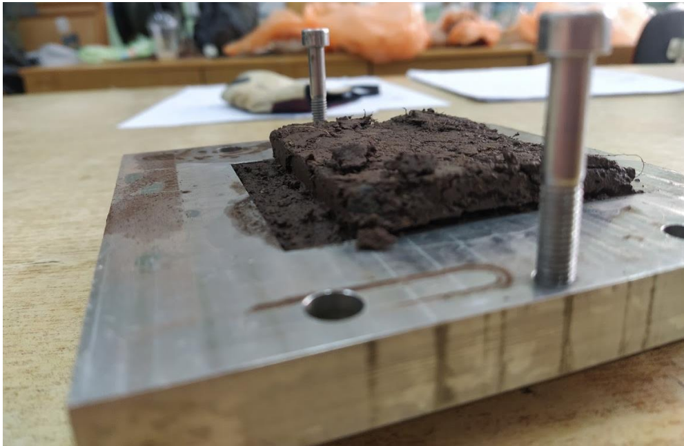
Εικόνα 70: Υλικό μετά τη δοκιμή άμεσης διάτμησης με \sigma= 50\text{kPa}
