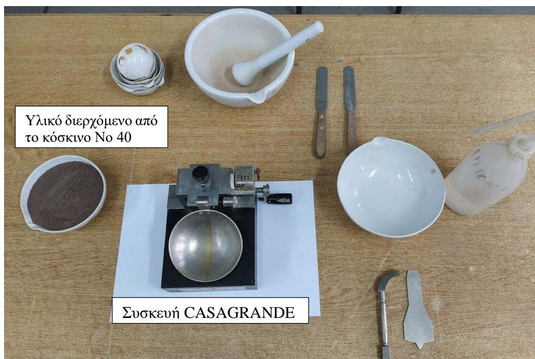
Εικόνα 64: Δοκιμή με τη Μέθοδο Casagrande. Εργαστήριο Τεχνικής Γεωλογίας ΑΠΘ
