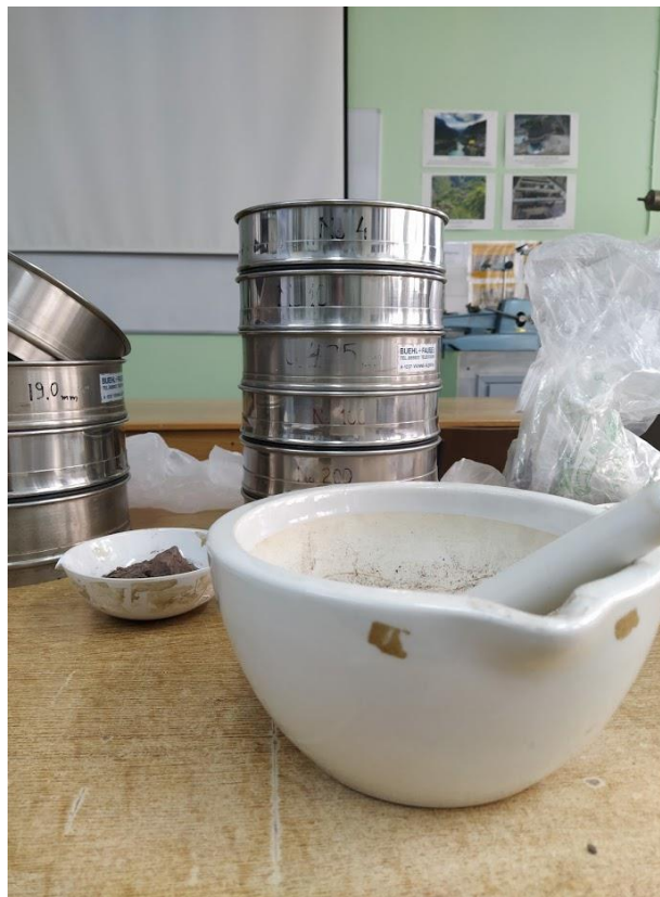
Εικόνα 59: Προετοιμασία για κοκκομετρική ανάλυση. Εργαστήριο Τεχνικής Γεωλογίας ΑΠΘ
