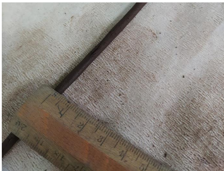
Εικόνα 65: Δοκιμή του ορίου πλαστικότητας. Πρώτη δοκιμή όπου ο ραβδίσκος κυλινδρώθηκε σε διάμετρος 3mm. Εργαστήριο Τεχνικής Γεωλογίας ΑΠΘ.
