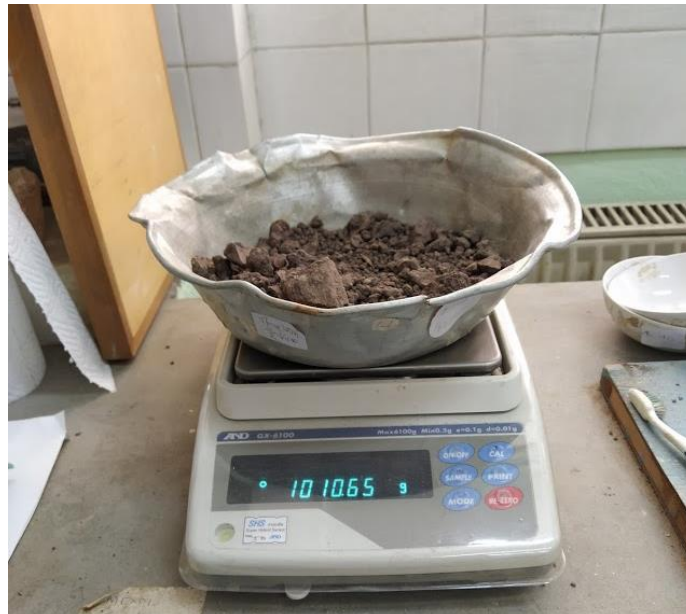
Εικόνα 58: Ζύγισμα υλικού στη ζυγαριά ακριβείας. Εργαστήριο Τεχνικής Γεωλογίας ΑΠΘ
