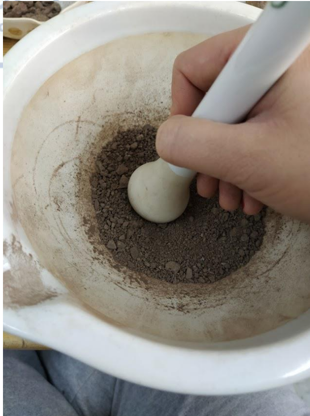
Εικόνα 60: Προετοιμασία υλικού για κοκκομετρική ανάλυση. Διάλυση συσσωματωμάτων με το γουδί
