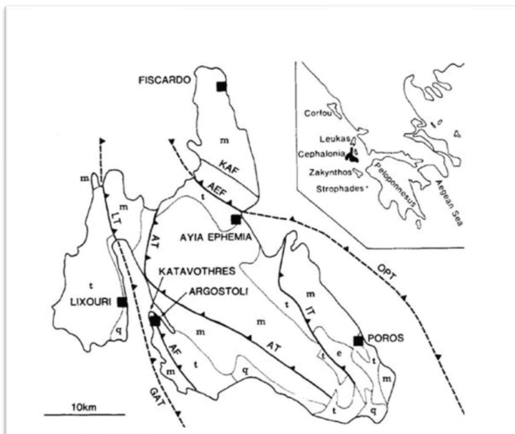
Σχήμα 3.2. Τα σημαντικότερα ρήγματα της Κεφαλονιάς. AF: Ρήγμα Αργοστολίου, AEF: Ρήγμα Αγίας Ευφημίας, AT: Ρήγμα Αίνου, GAT: Ρήγμα του Κόλπου του Αργοστολίου, IT: Επώθηση της Ιονίου ζώνης πάνω στην Παξών, KAF: Ρήγμα Καλού Όρους. (Stiros et al., 1994)
