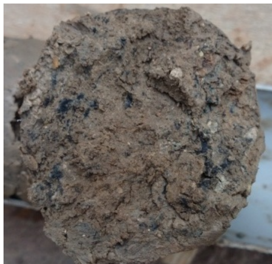
Παρουσία οργανικών σε αμμώδη άργιλο σε τμήμα πυρήνα γεώτρησης. Βάθος 7,00 μέτρα, γεώτρηση Γ2).
