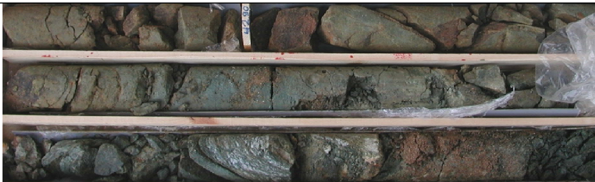
Βραχώδες υπόβαθρο σε γεωτρήσεις του Μετρό Θεσσαλονίκης στην περιοχή Εγνατίας και Αγ. Σοφίας σε βάθος 42 μέτρα (Ζερβοπούλου 2010). Είναι ορατή η αποσάθρωση με τον έντονα κατακερματισμένο βράχο.
