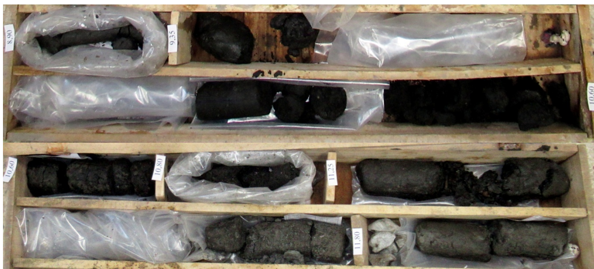
Σχ.10 Δείγματα από γεώτρηση στην περιοχή της οδού Τσιμισκή όπου φαίνεται η στρώση της τεφρής αργίλου σε βάθη έως 11,80 μέτρα (Φωτ. Μ. Πάτσιος)
