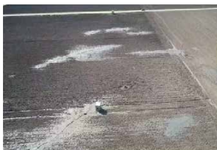
Φαινόμενα ρευστοποίησης (ανοιχτόχρωμοι άμμοι σε καλλιεργήσιμο έδαφος) σε αγροτικές εκτάσεις ύστερα από τον σεισμό Δαμασίου 2021 (Valkaniotis et al. 2021)
