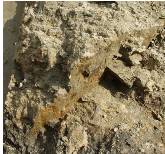
Σχ.34 Επιφάνειες ολίσθησης σε εκσκαφή, σε πρασινότεφρη και καστανότεφρη άργιλο αντίστοιχα.
