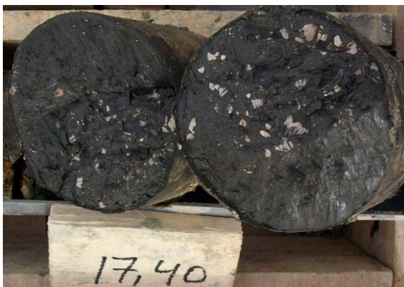
Σχ.82β Επιφάνειες ολίσθησης σε πυρήνες γεώτρησης και σε βάθη 17 και 26 μέτρων αντίστοιχα. Καταγράφηκαν σε στιφρές αργιλικές στρώσεις στην περιοχή Ντεπώ.
