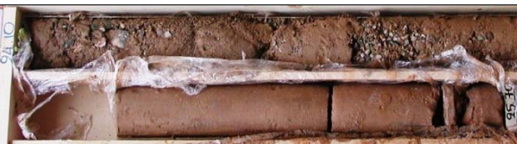
Βάθος 24-26m: Αργιλώδης άμμος με χάλικες οι οποίοι εξαφανίζονται στο επόμενο μέτρο.
