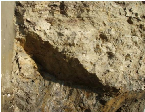
Σχ. 47 Ροή υδάτων διαμέσου διακλάσεων και επιφανειών ολίσθησης στην ψαμμιτομαργαϊκή ενότητα.
