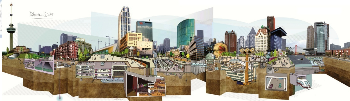
Σχ.2 Σχηματική αναπαράσταση της ανάπτυξης μιας πόλης τόσο υπέργεια όσο και υπόγεια με την δημιουργία δρόμων, πάρκινγκ, τούνελ συγκοινωνιών, δικτύων ΟΚΩ, κτηρίων κ.α. (Rotterdam 2035, COST Action TU1206 Sub-Urban)
