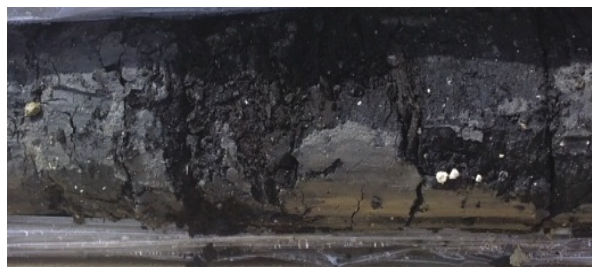
Στρώση αργίλου με οργανικά στοιχεία έως ξυλitis στον κατώτερο ορίζοντα της ψαμμιτομαργαϊκής ενότητας. Δείγμα πυρηνοληψίας.
