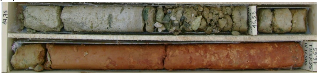
Σχ.35 Φωτογραφία από κιβώτιο γεώτρησης όπου φαίνεται η ομαλή επαφή Ψαμμιτομαργαϊκής ενότητας και ενότητας Ερυθρών Αργίλων (Ζερβοπούλου, 2010).
