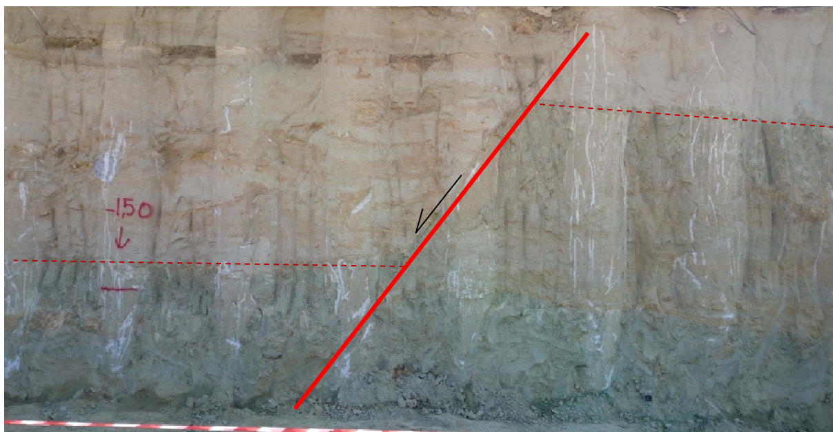
Σχ.116α Κανονικό ρήγμα F-V2 όπου καταγράφεται η μετατόπιση των στρωμάτων της ψαμμιτομαργαϊκής ενότητας και λεπτομέρειες στις παρακάτω φωτογραφίες.
