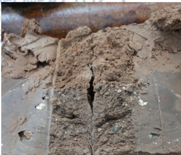
Έντονα διαταραγμένο έδαφος αμμώδους αργίλου με χάλικες σκούρου καστανού χρώματος. Βάθος 4,5 μέτρων, γεώτρηση Γ1).
