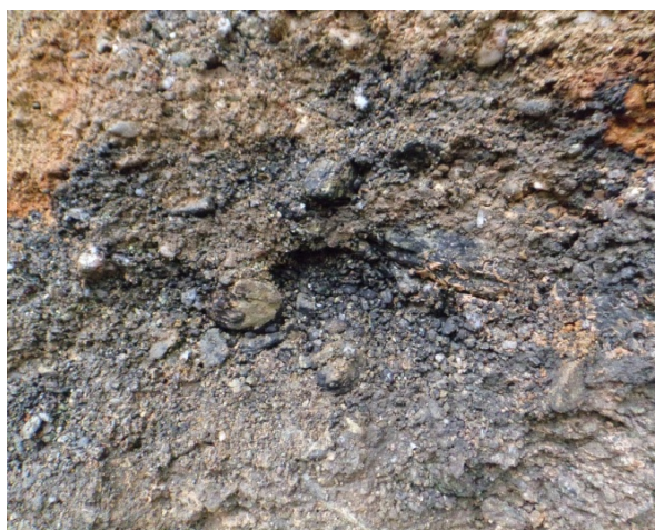
Λεπτομέρεια του παλαιοεδάφους (τεφρή χαλικώδης άμμος) με παρουσία οργανικών υλικών.
