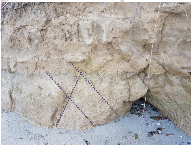
Σχ.110γ Επιφάνειες ολίσθησης στην ψαμμιτομαργαϊκή ενότητα στο όριο με σύγχρονες παράκτιες άμμους (περιοχή ΝΟΘ)
