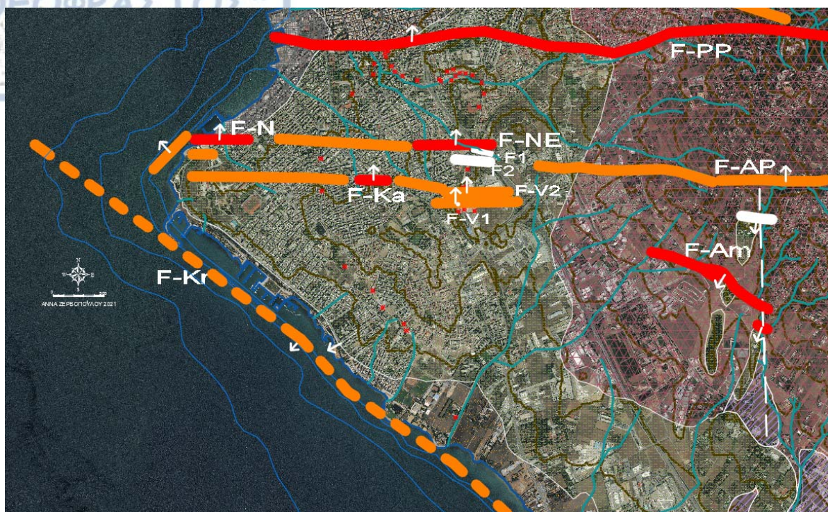
Σχ.126 Συνθετικός γεωλογικός χάρτης όπου σχεδιάζονται τα ρήγματα F-AP Αμπέλια- Πανόραμα και F-A Αμπέλια σε συνδυασμό με τα ρήγματα Καλαμαριάς.
