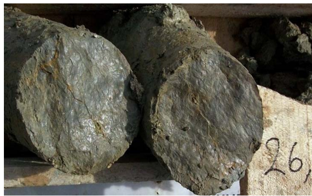
Σχ.82β Επιφάνειες ολίσθησης σε πυρήνες γεώτρησης και σε βάθη 17 και 26 μέτρων αντίστοιχα. Καταγράφηκαν σε στιφρές αργιλικές στρώσεις στην περιοχή Ντεπώ.
