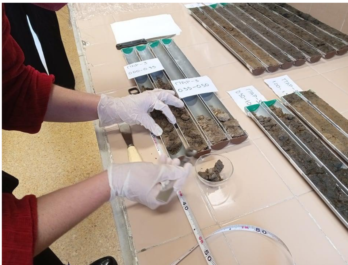
Εικόνες 6: Συλλογή των δειγμάτων για τις ιζηματολογικές αναλύσεις και καταγραφή του βάθους του κάθε δείγματος.
