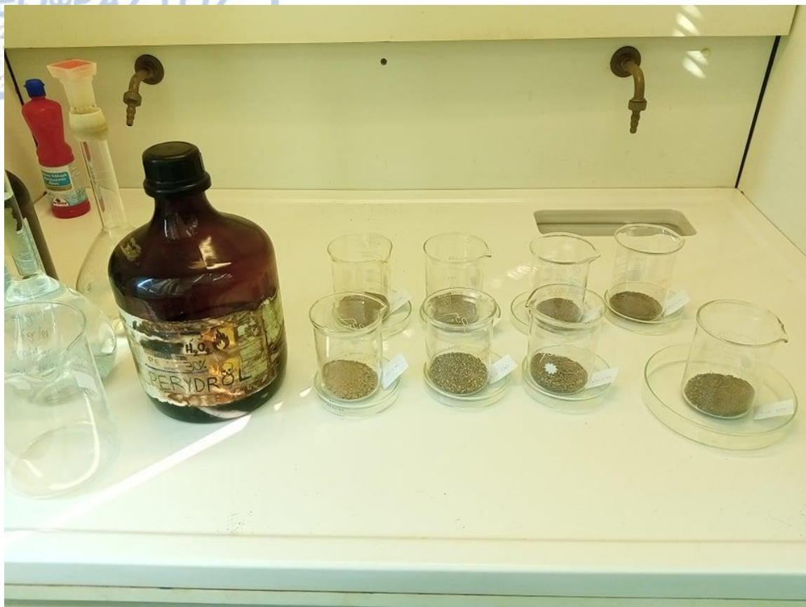
Εικόνα 9: Τα δείγματα τοποθετούνται σε ασφαλή χώρο για να μπει το perhydrol και να καταστραφούν τα οργανικά υλικά.
