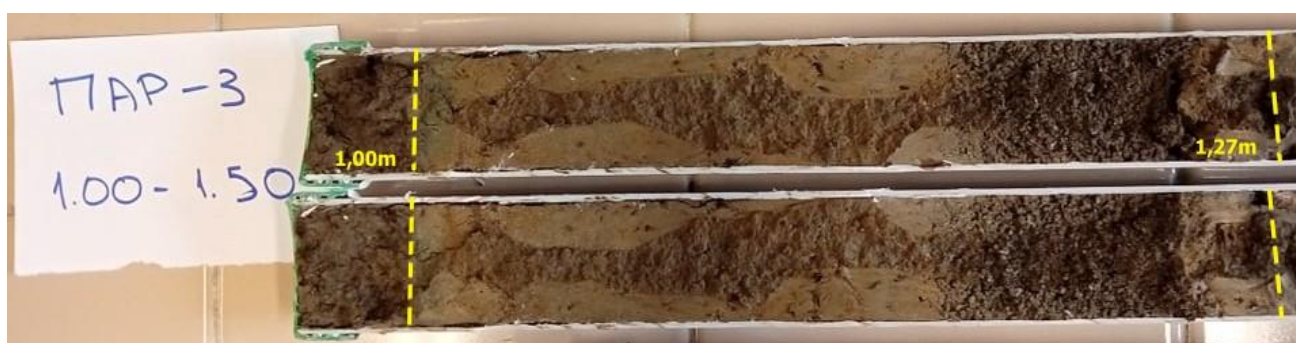
Εικόνα 13: Μέρος της γεώτρησης PAP-3 1,00m-1,50m. Στην εικόνα φαίνεται η εναλλαγή του χρώματος και της κοκκομετρίας από ελαιοκάστανη αμμούχος ιλύς σε σκούρα καστανότεφρη άμμο και ξανά σε ελαιοκάστανη αμμούχος ιλύς. Τα πρώτα εκατοστά της γεώτρησης δεν υπολογίστηκαν αφού φαίνεται ότι αποτελούν αναμοχλευμένο έδαφος που έχει πέσει από τα πλαϊνά τοιχώματα της γεώτρησης
