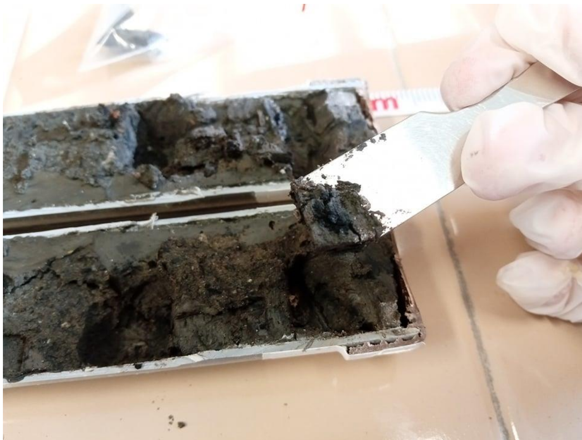
Εικόνα 5: Δειγματοληψία ξυλάνθρακα με σπάτουλα.
