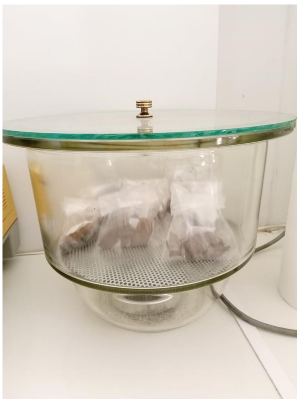
Εικόνα 7 και 8: Αριστερά (7) φαίνεται γυάλινος αφυγραντήρας που κλείνει αεροστεγώς με τα δείγματα μετά την ξήρανσή τους στο φούρνο. Δεξιά (8) απεικονίζεται η χρήση γουδιού για τη διάσπαση των συσσωματωμάτων αφού βγουν από τον αφυγραντήρα.
