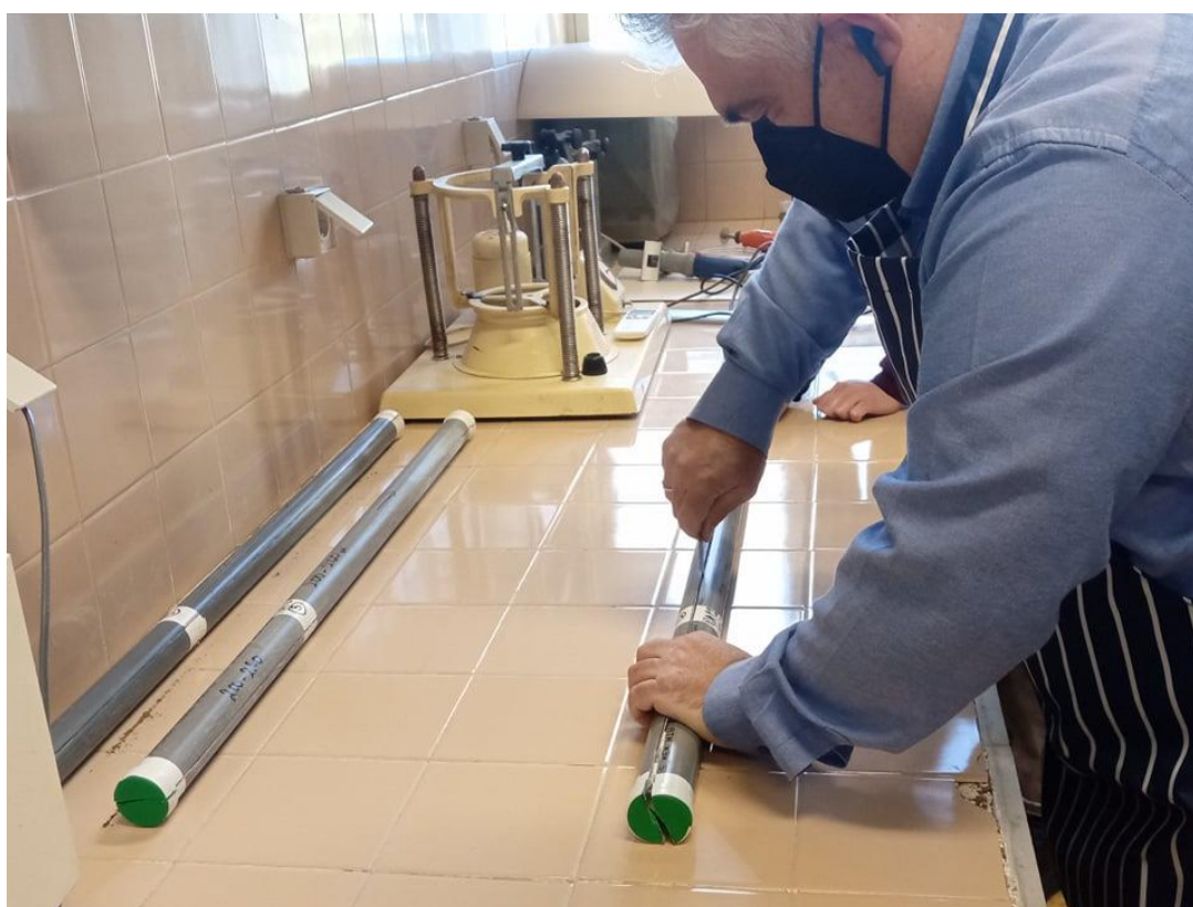
Εικόνα 3 και 4: Στη πάνω εικόνα (3) φαίνεται η κοπή του σωλήνα της γεώτρησης με ηλεκτρικό τροχιστή συνδεδεμένο σε ηλεκτρική σκούπα για να μαζεύει τα κορήματα από το τροχιστή. Στη συνέχεια η γεώτρηση κόβεται με κοπίδι (κάτω εικόνα(4)) για να ανοίξει ομοιόμορφα στις δύο μεριές.
