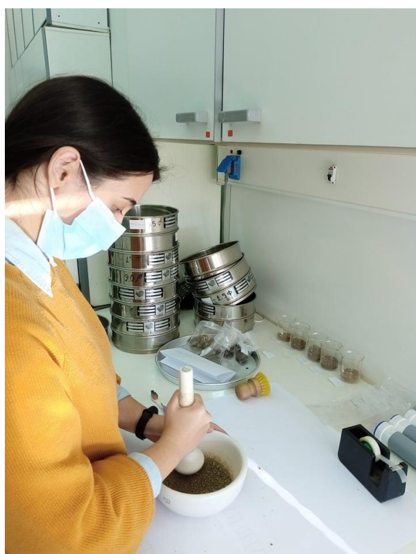
Εικόνα 7 και 8: Αριστερά (7) φαίνεται γυάλινος αφυγραντήρας που κλείνει αεροστεγώς με τα δείγματα μετά την ξήρανσή τους στο φούρνο. Δεξιά (8) απεικονίζεται η χρήση γουδιού για τη διάσπαση των συσσωματωμάτων αφού βγουν από τον αφυγραντήρα.
