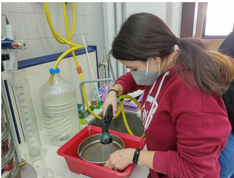
Εικόνα 12: Μετά τη ιζηματολογική ανάλυση με το Pario γίνεται πλύση του δείγματος σε κόσκινο μεγέθους 4Φ ώστε να απομακρυνθούν τα λεπτόκοκκα για να συνεχίσουν οι ιζηματολογικές αναλύσεις των αδρόκοκκων με τα κόσκινα.
