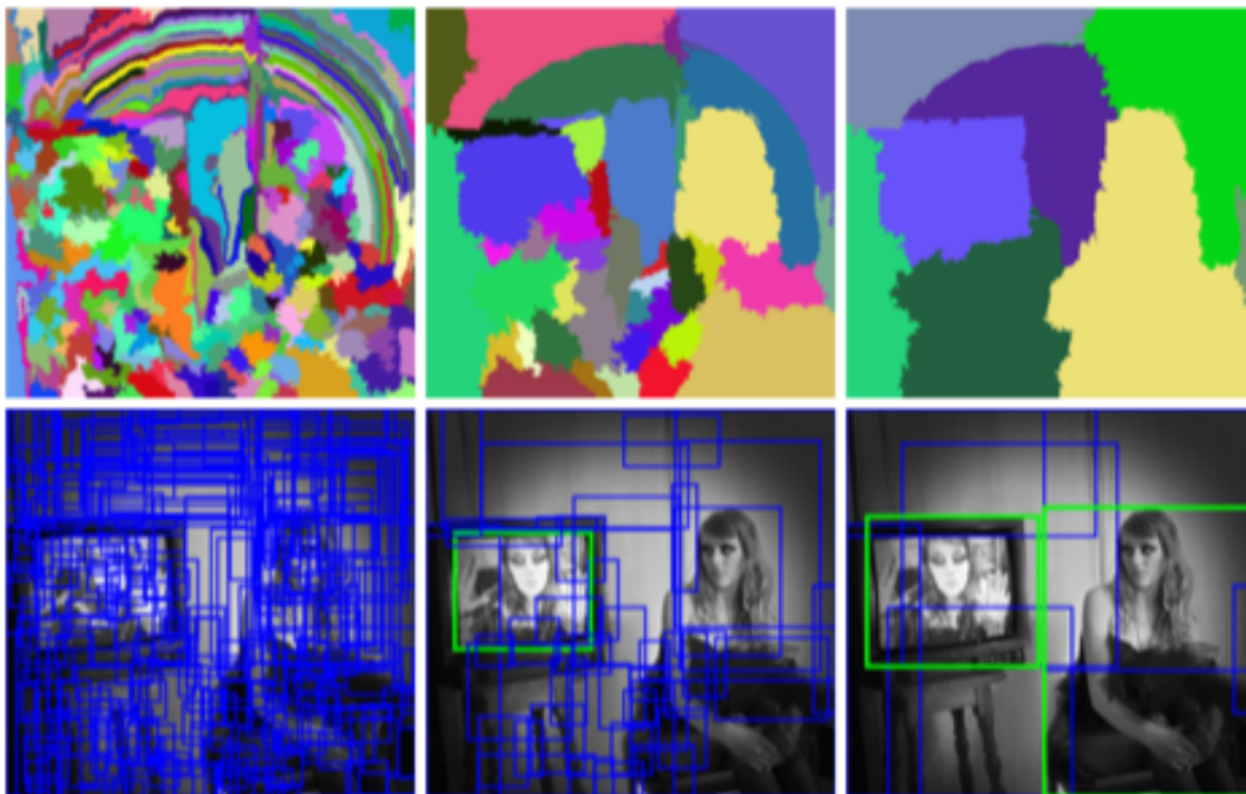
Εικόνα 3.21: Εφαρμογή του αλγορίθμου Selective Search [91]. Πάνω: απεικόνιση του αποτελέσματος της κατάτμησης ( segmentation ) του αλγορίθμου. Κάτω: απεικόνιση των προτάσεων περιοχών θέσης του αλγορίθμου.
