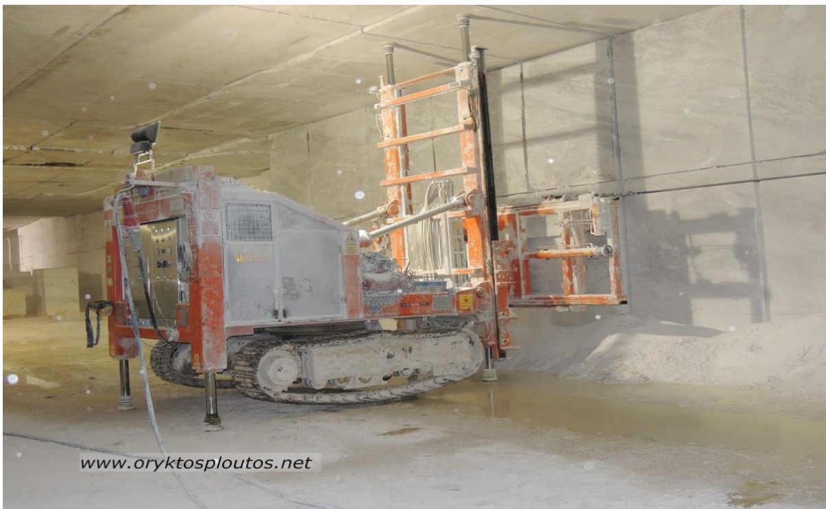
Σχ. 47. Κοπή σε υπόγειο θάλαμο με πριόνι (www.oryktosploutos.net).
