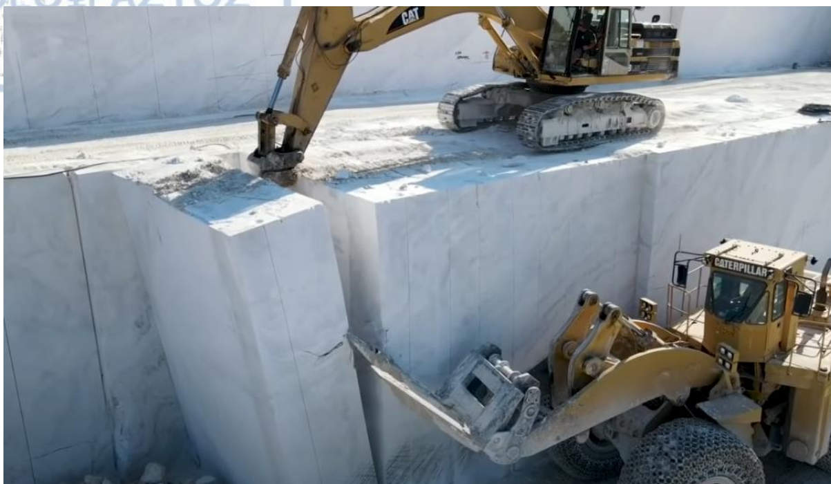
Σχ. 45. Αποκόλληση τεμάχους από το μητρικό πέτρωμα με ειδικούς εκσκαφείς (www.nordiamarble.com).
