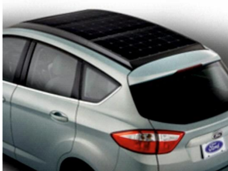
Σχ. 19. Υβριδικό αυτοκίνητο με ενσωματωμένο φωτοβολταϊκό πάνελ στην οροφή για την παραγωγή ενέργειας(©Ford).
