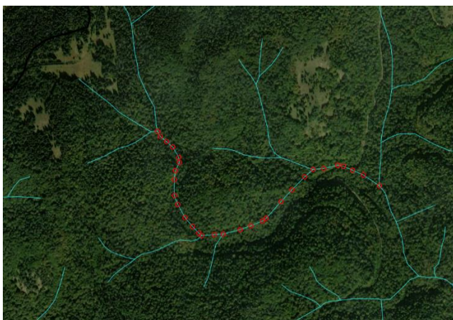
Εικόνα 27: Το ψηφιοποιημένο υδρογραφικό δίκτυο (αριστερά) και το εξαγόμενο βάσει του DEM (δεξιά) με τους αντίστοιχους κόμβους τους (κοκκίνο χρώμα) πριν από την αύξηση της πυκνότητας αυτών
