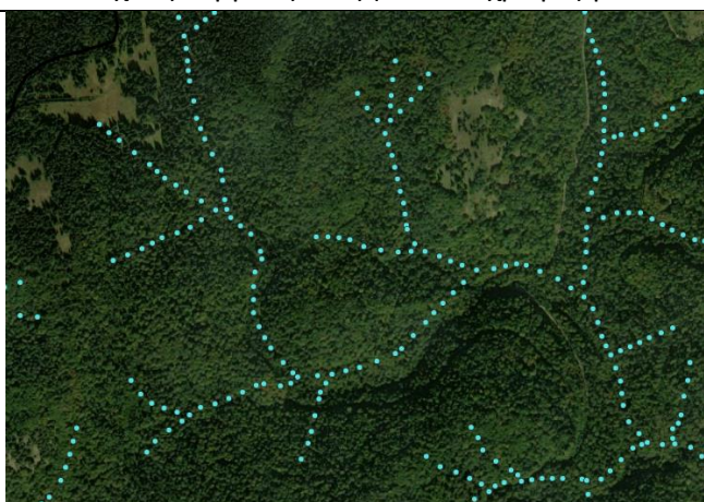
Εικόνα 29: Το ψηφιοποιημένο υδρογραφικό δίκτυο (αριστερά) και το εξαγόμενο βάσει του DEM (δεξιά) με τους αντίστοιχους κόμβους που απομονώθηκαν από τα δίκτυα
