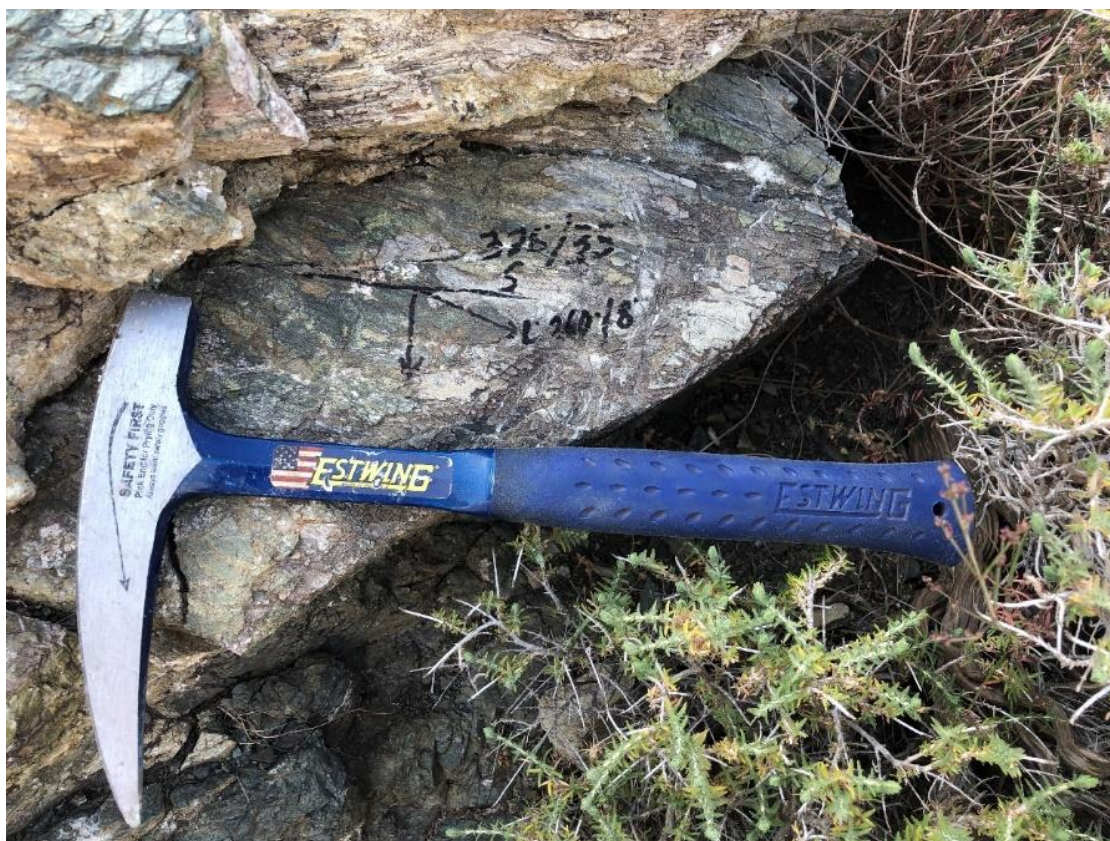
Σχήμα 4.5. Ένδειξη μέτρησης της σχιστότητας (S) και της ορυκτολογικής γράμμωσης (L) σε μεταμορφικό πέτρωμα.
