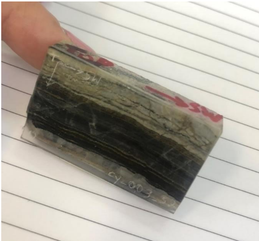
Σχήμα 4.6. Το αποτέλεσμα της διαδικασίας επικόλλησης του γυαλιού στο δειγματοληπτικό πλακίδιο του μεταμορφωμένου πετρώματος και η τοποθέτηση των στοιχείων προσανατολισμού με υαλογράφο σε αυτό.
